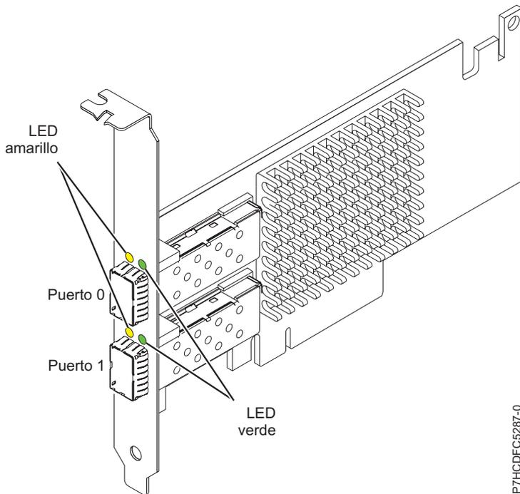
Figura 28. adaptador PCIe2 de 2 puertos 10GbE SR
