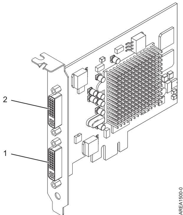
Figura 23. adaptador Acelerador de gráficos POWER GXT145 PCI Express
