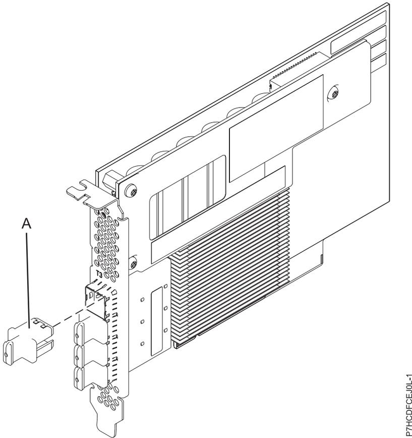
Figura 26. Adaptador PCIe3 12 GB Caché RAID SAS 6 Gb
