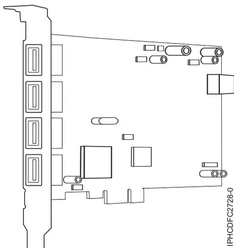
Figura 14. adaptador PCIe2 LP de 4 puertos USB 3.0
