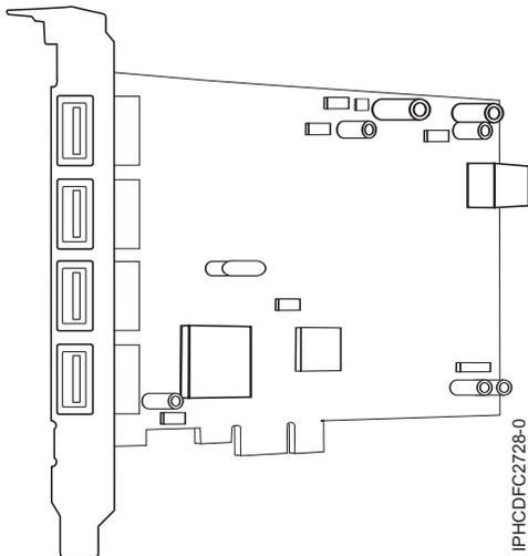
Figura 46. adaptador PCIe2 de 4 puertos USB 3.0
