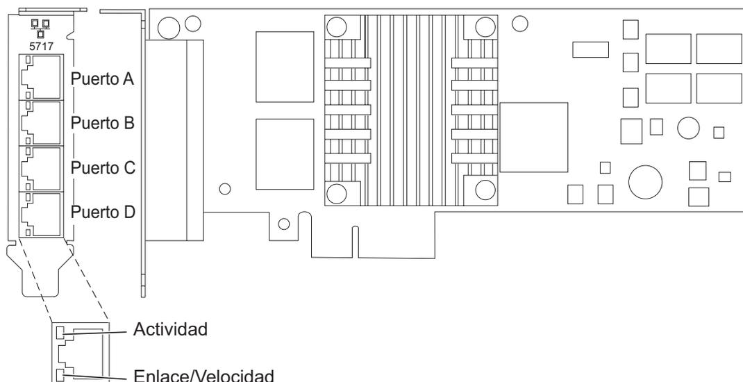
Figura 29. Adaptador PCIe 4 Puertos 10/100/1000 Base-TX
