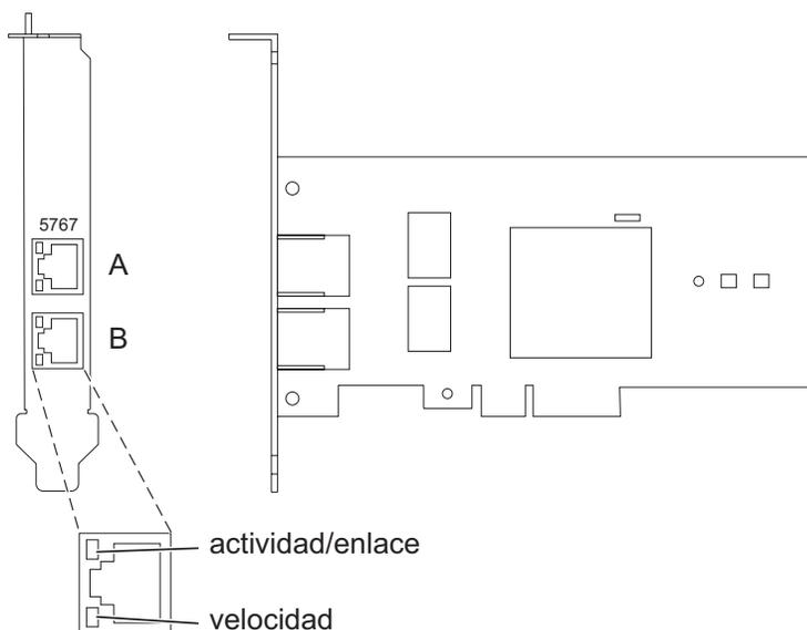
Figura 30. Adaptador PCI Express Ethernet Base-TX 10/100/1000 de 2 puertos
