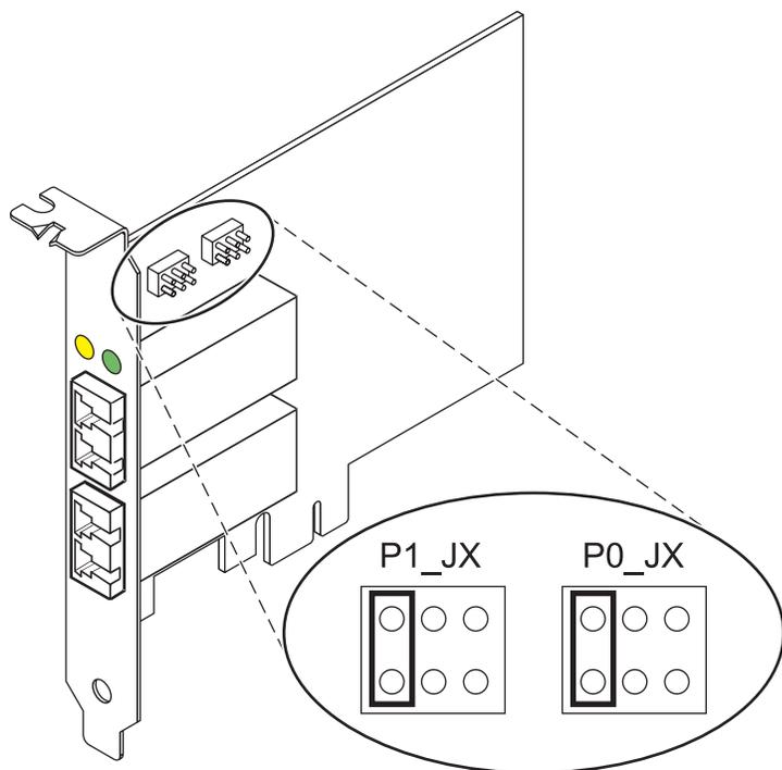
Figura 21. Puente de ID de dispositivo
