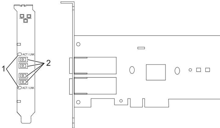
Figura 31. Adaptador PCI Express Ethernet-SX Gigabit de 2 puertos
