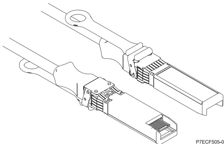
Figura 18. Vista superior e inferior del cable
