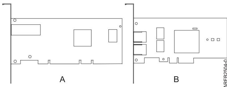
Figura 1. Adaptador PCI-X y adaptador PCIe 4x
