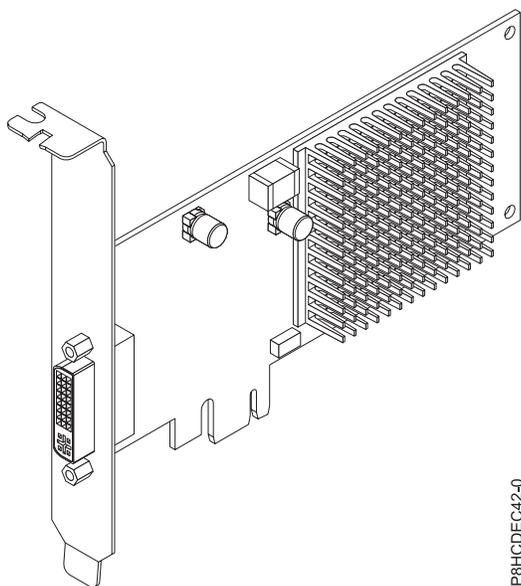
Figura 24. adaptador de gráficos 3D PCIe2
