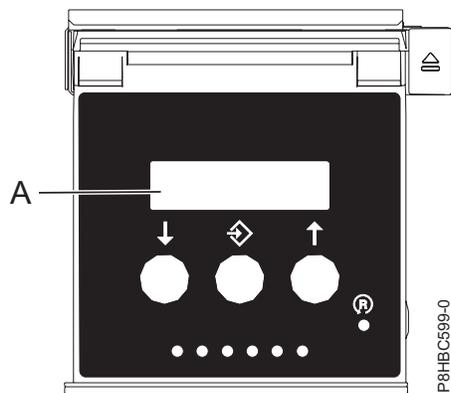
Figura 3. Pantalla de función del panel de control
