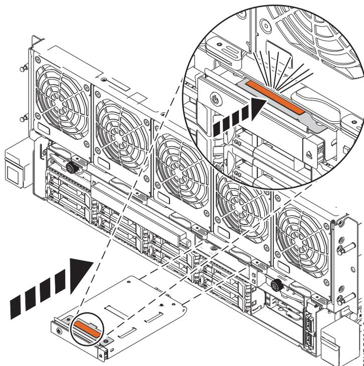
Figura 5. Sustitución del panel de control en el sistema 8408-44E o 8408-E8E
