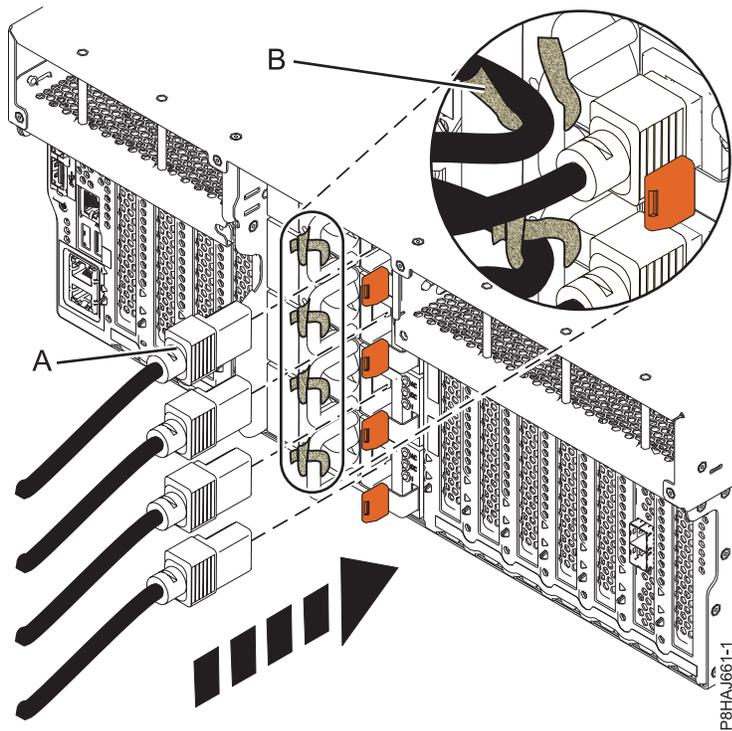
Figura 27. Conexión de los cables de alimentación a un sistema 8247-42L, 8286-41A o 8286-42A
