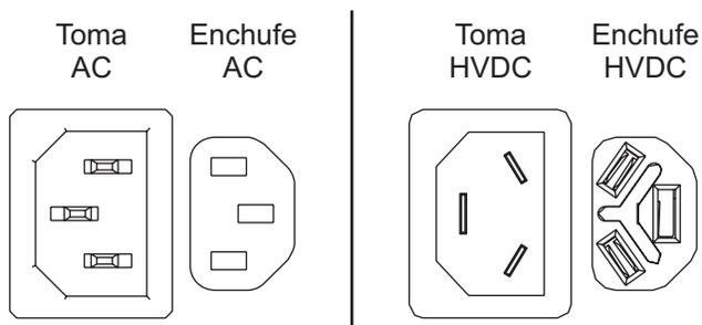
Figura 24. Conectores de CA y HVDC
