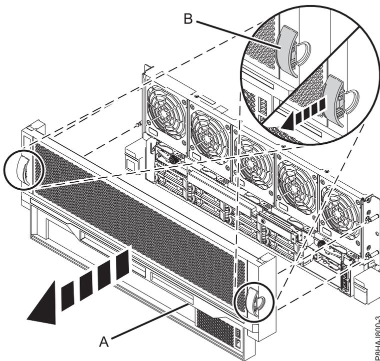
Figura 8. Extracción de la cubierta frontal
