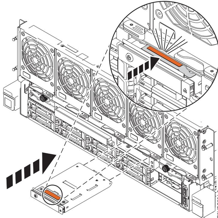
Figura 2. Sustitución del panel de control en el sistema 8408-44E o 8408-E8E
