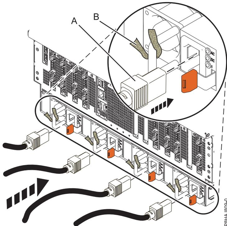
Figura 29. Conexión de los cables de alimentación a un sistema 8408-44E o 8408-E8E
