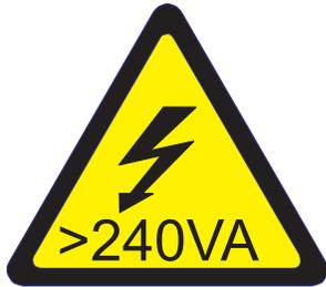
**PRECAUCIÓN:** Niveles energéticos peligrosos. Los voltajes con niveles energéticos peligrosos pueden ocasionar un calentamiento cuando falta el material conductor, cosa que puede provocar salpicaduras de metal, quemaduras o ambas cosas. (L005)
