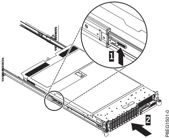
Figura 8. Instalación del servidor en el bastidor
