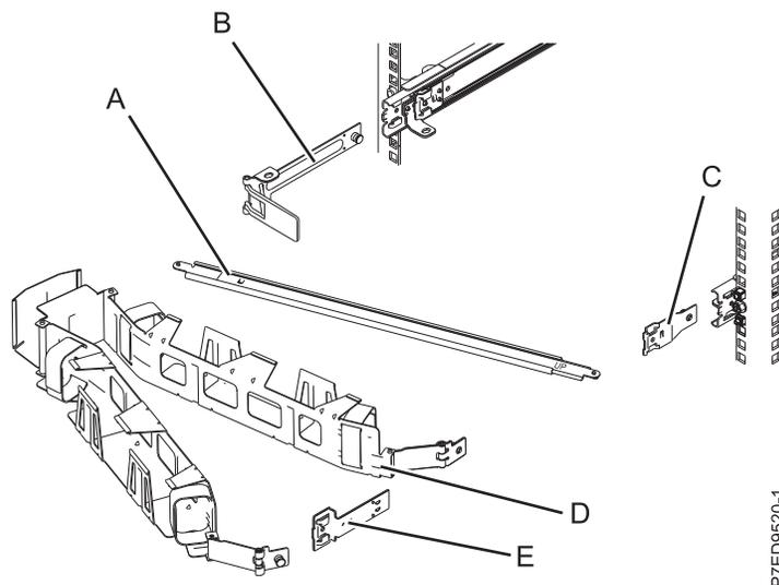
Figura 9. Posiciones relativas de las partes del brazo portables antes del ensamblaje
