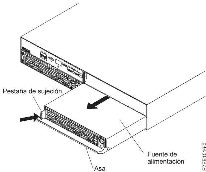
Figura 5. Extracción de la fuente de alimentación
