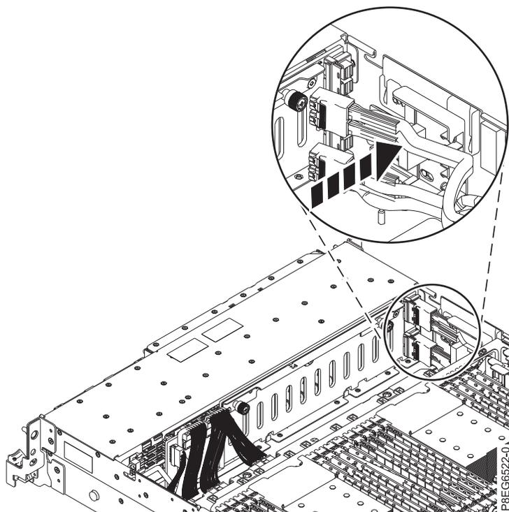
Figura 6. Direccionamiento de los cables SAS frontales
