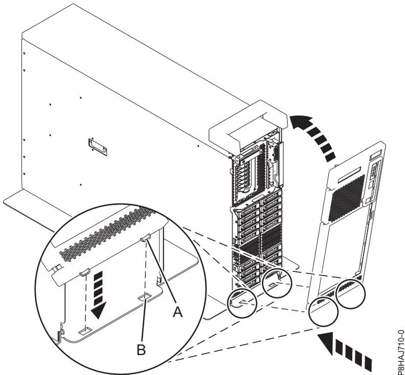
Figura 29. Instalación de la cubierta frontal
