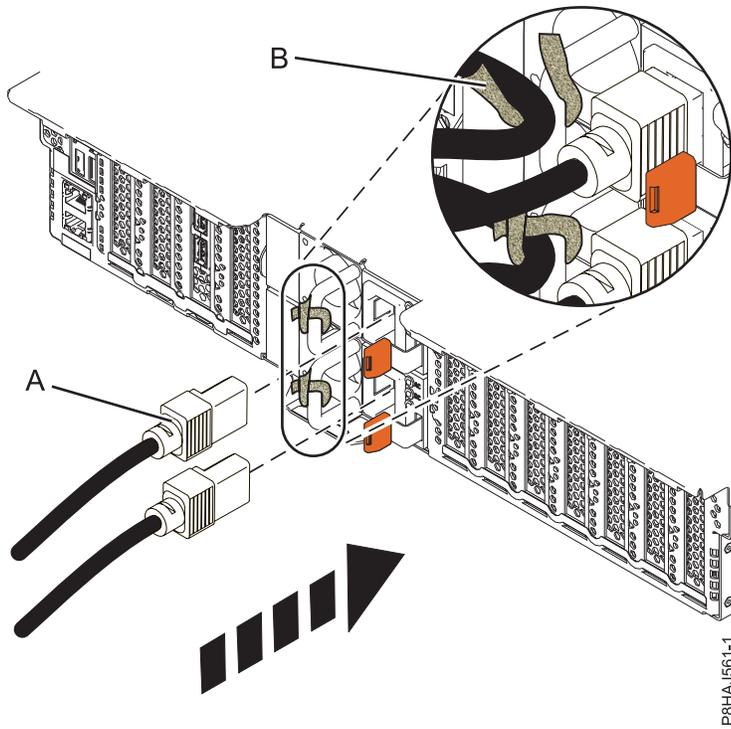
Figura 56. Conexión de los cables de alimentación a un sistema 5148-21L, 5148-22L, 8247-21L, 8247-22L, 8284-21A o 8284-22A
