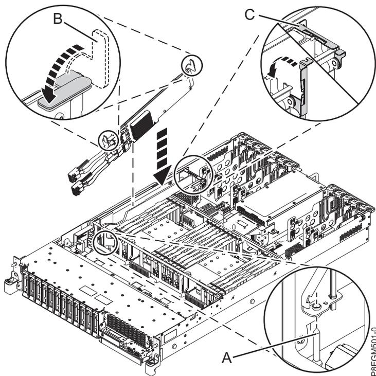
Figura 13. Sustitución del Adaptador interno PCIe3 x8 SAS RAID de 6 Gb
