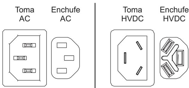
Figura 52. Conectores de CA y HVDC
