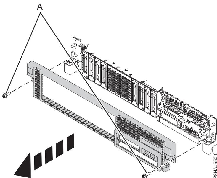
Figura 20. Extracción de la cubierta frontal
