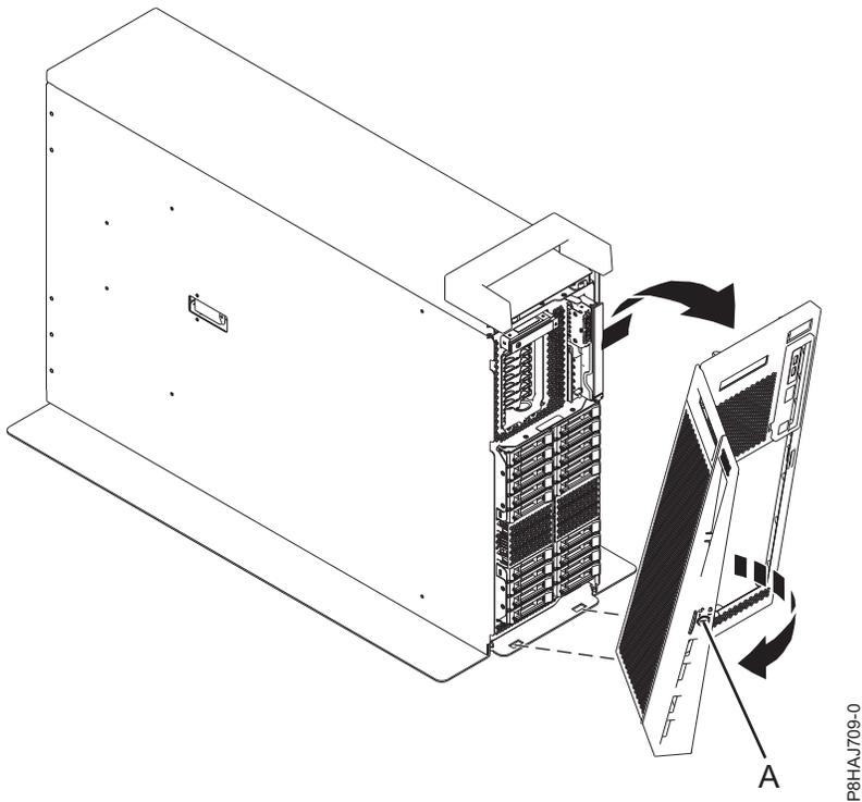
Figura 22. Extracción de la cubierta frontal
