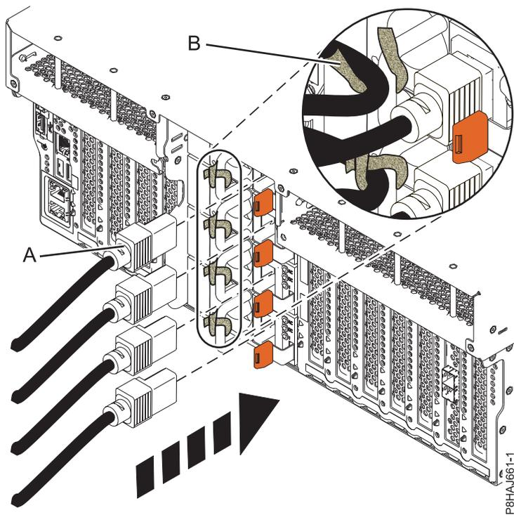
Figura 55. Conexión de los cables de alimentación a un sistema 8247-42L, 8286-41A o 8286-42A
