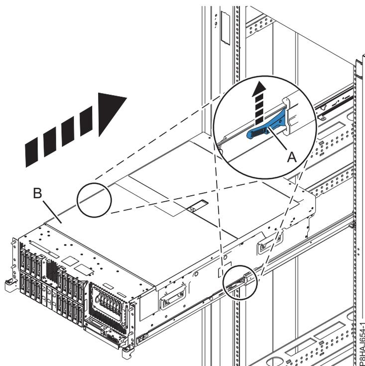
Figura 45. Colocación del sistema en la posición operativa
