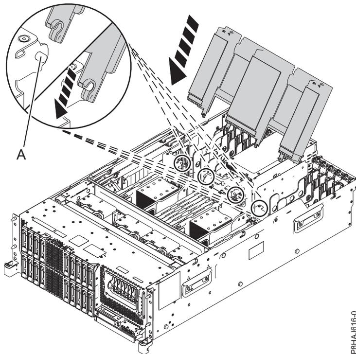
Figura 42. Sustitución del deflector de aire
