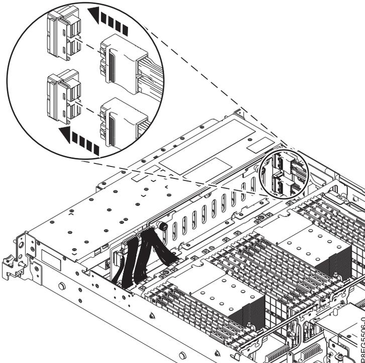
Figura 15. Cómo volver a conectar los cables SAS frontales a la placa posterior de la unidad de disco
