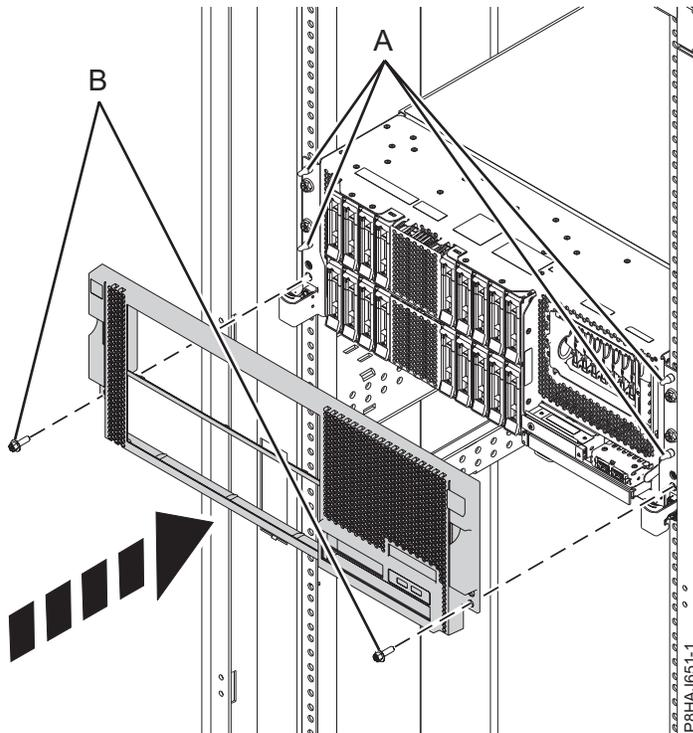
Figura 28. Instalación de la cubierta frontal
