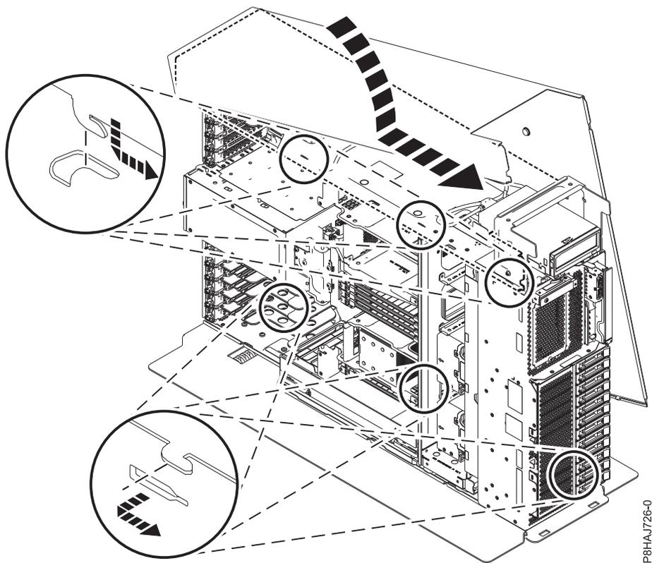
Figura 33. Colocación de la cubierta lateral de 8286-41A
