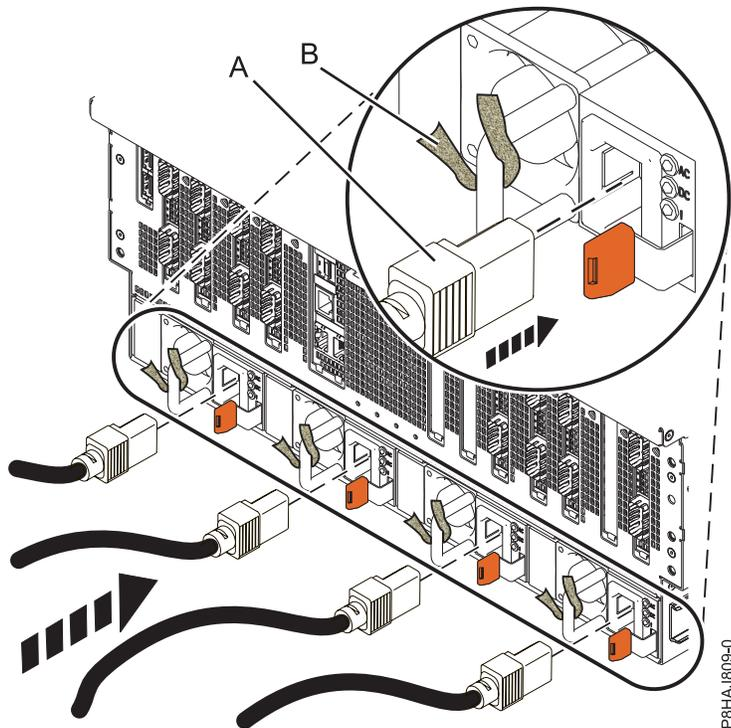
Figura 57. Conexión de los cables de alimentación a un sistema 8408-44E o 8408-E8E
