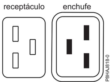
Figura 53. Conectores para el sistema 8408-44E
