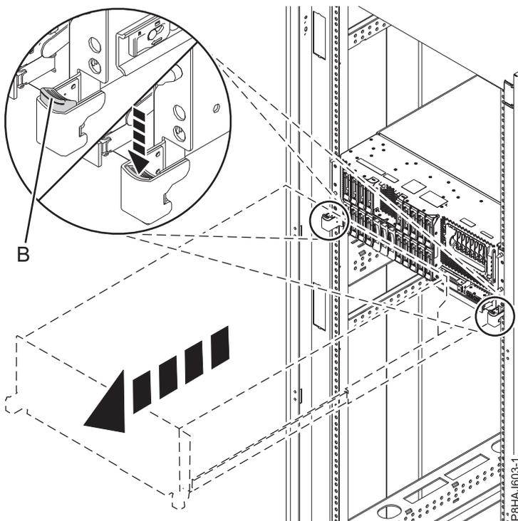
Figura 44. Soltar los mecanismos de cierre laterales
