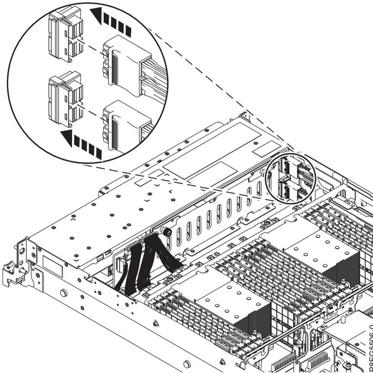
Figura 7. Cómo volver a conectar los cables SAS frontales en la placa posterior de la unidad de disco
