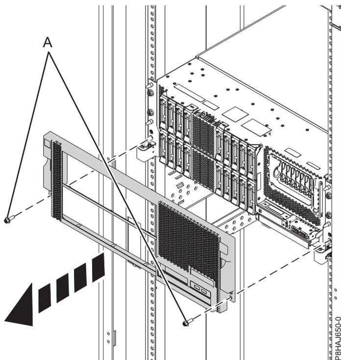
Figura 21. Extracción de la cubierta frontal
