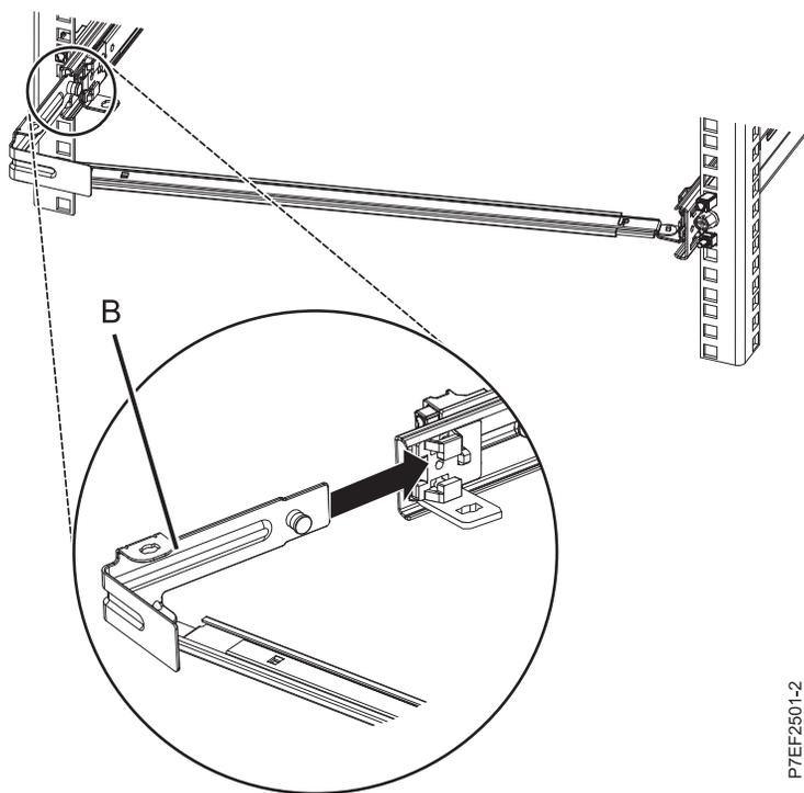
Figura 12. Tendido de la patilla e instalación de la abrazadera en el riel deslizable
