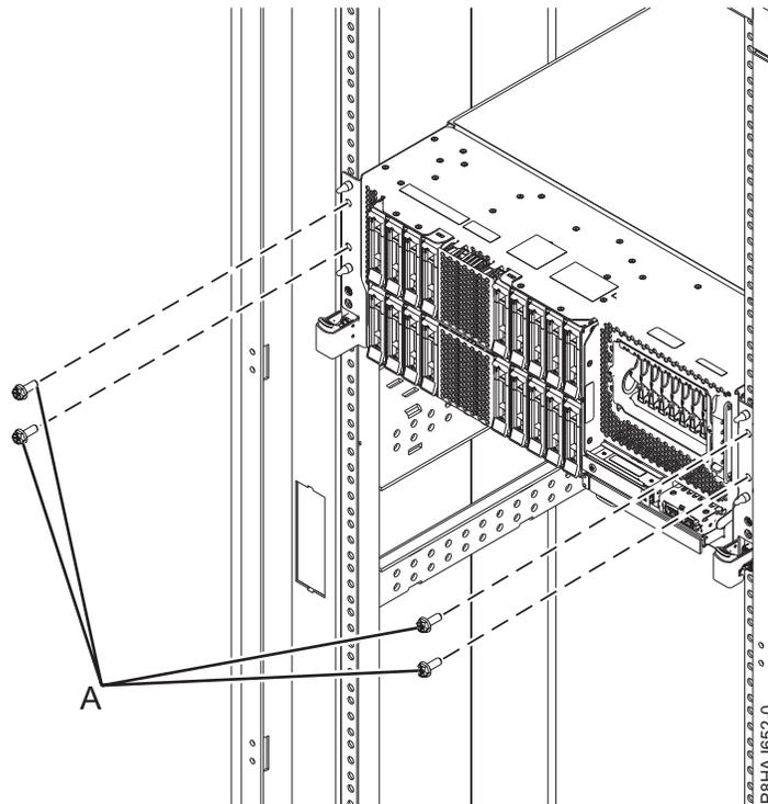
Si está instalando el sistema en un bastidor con orificios redondos en el riel del bastidor, utilice los clips de tuerca que se incluyen con el kit del riel del sistema.
