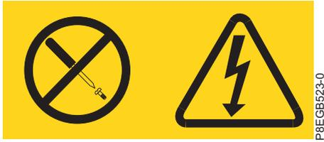
En el interior de los componentes que tienen adherida esta etiqueta existen niveles de voltaje, corriente y energía que son peligrosos. Dentro de estos componentes no existe ninguna pieza que requiera mantenimiento. Si sospecha que existe un problema en una de estas piezas, póngase en contacto con un técnico de servicio.
