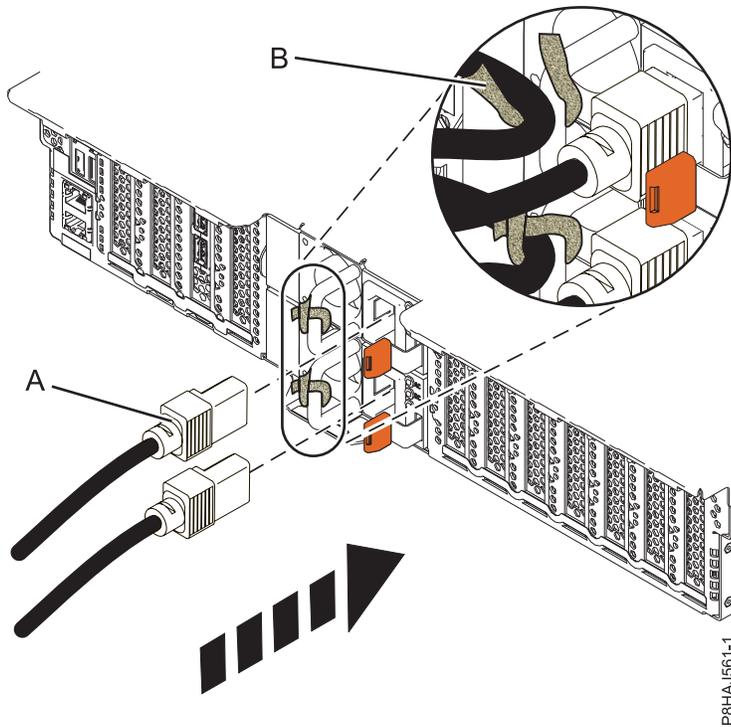
Figura 26. Conexión de los cables de alimentación a un sistema 5148-21L, 5148-22L, 8247-21L, 8247-22L, 8284-21A o 8284-22A
