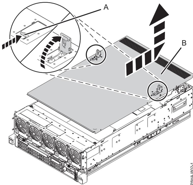
Figura 8. Extracción de la cubierta de acceso de servicio
