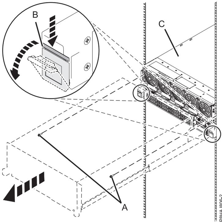
Figura 14. Colocación del sistema en la posición de servicio
