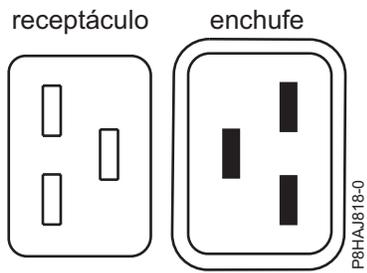
Figura 23. Conectores para el sistema 8408-44E
