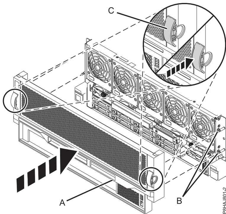
Figura 7. Instalación de la cubierta frontal
