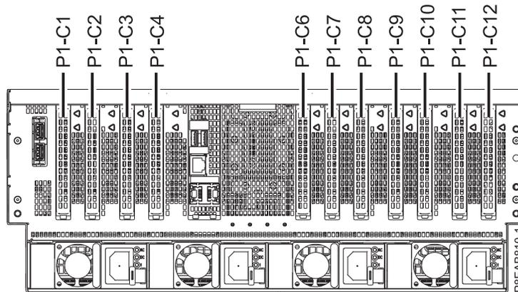
Figura 1. Vista posterior de un sistema 8408-44E o 8408-E8E con los códigos de ubicación de ranuras PCIe
