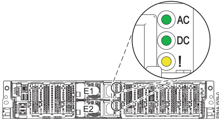
Abbildung 1. Position der Netzteile und Anzeigen im System
