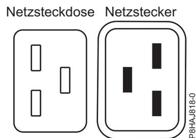
Abbildung 16. Anschlüsse beim System vom Typ 8408-44E
