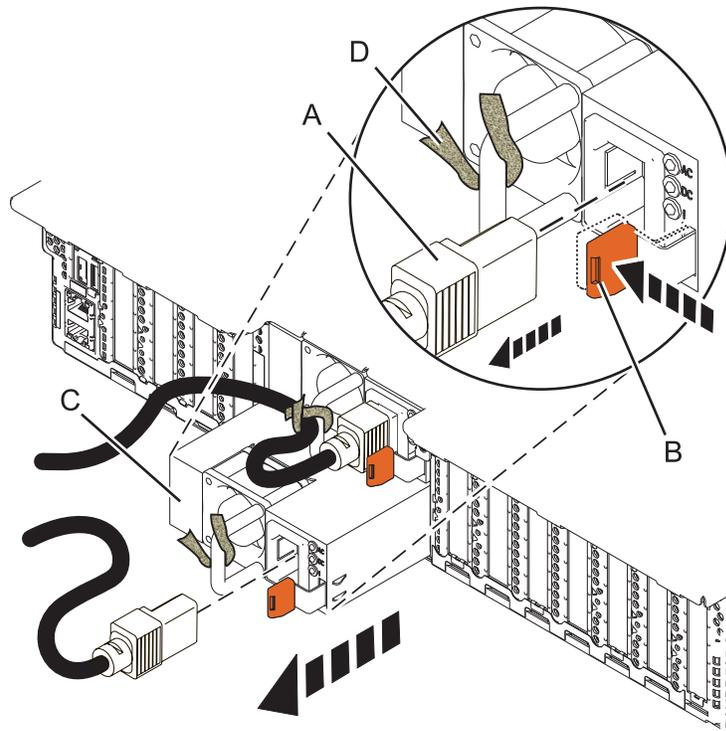
Abbildung 10. Ausbau eines Netzteils aus dem System
