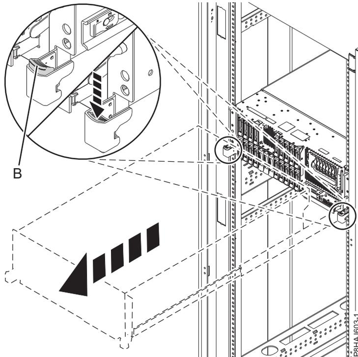
Abbildung 51. Seitliche Verriegelungen entriegeln
