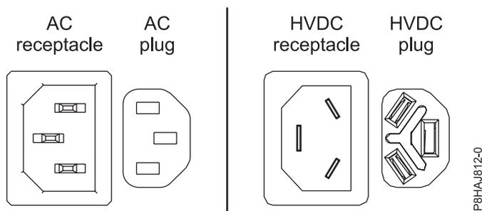
Abbildung 21. AC- und HVDC-Anschlüsse
