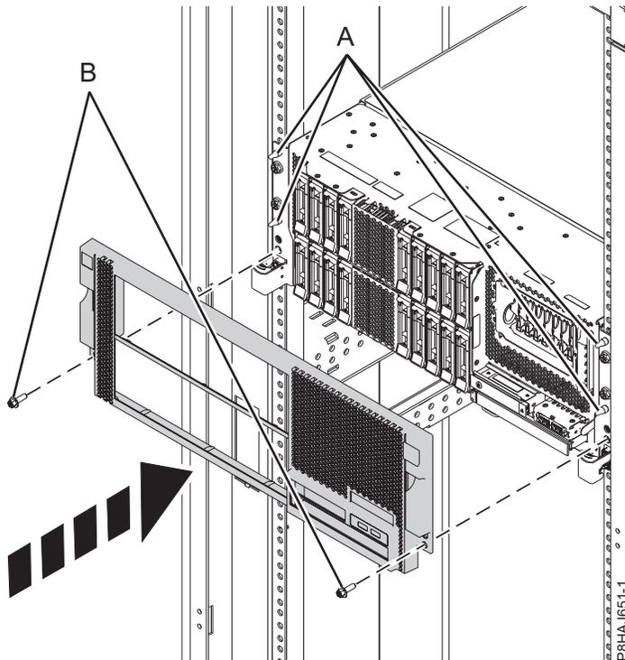
Abbildung 35. Vordere Abdeckung installieren
