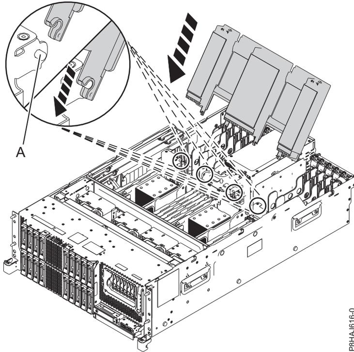
Abbildung 49. Luftführung installieren
