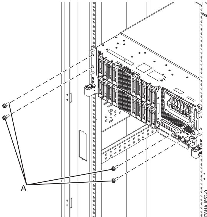
Abbildung 50. Entfernen der vorderen Schrauben
