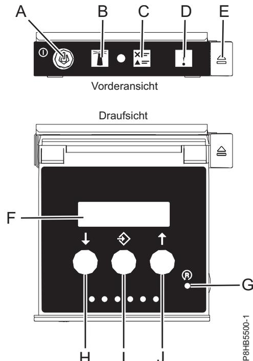
Abbildung 14. Steuerkonsole
