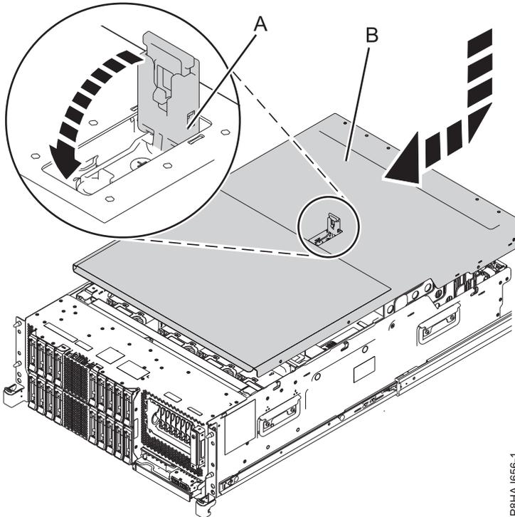
Abbildung 44. Serviceabdeckung installieren
