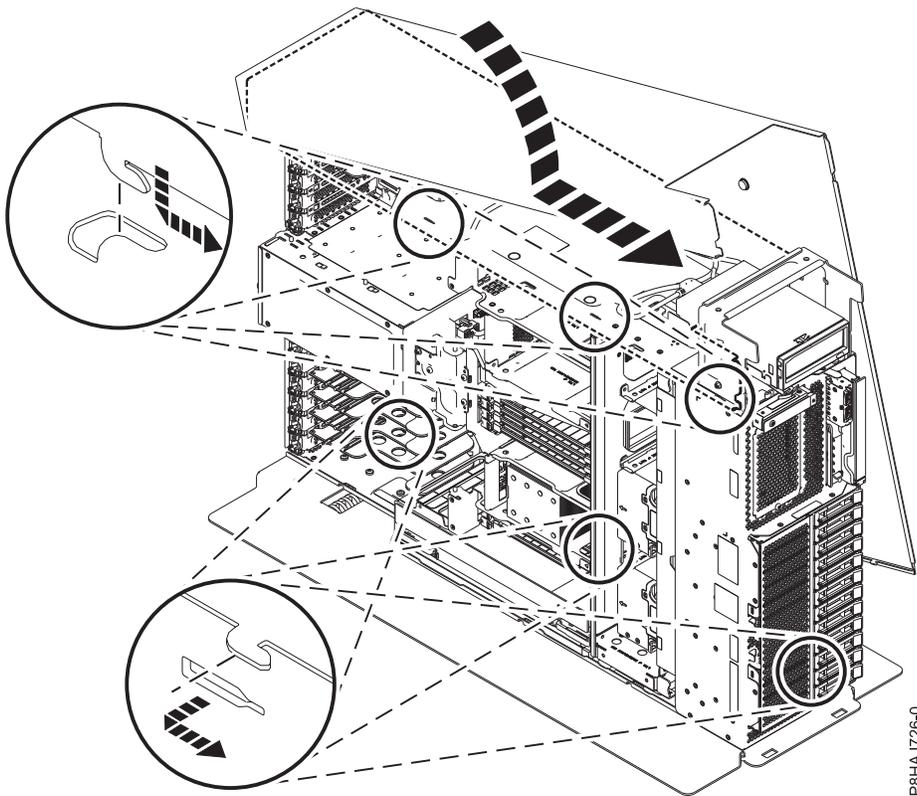
Abbildung 40. Installieren der Seitenabdeckung bei einem Standalone-System vom Typ 8286-41A
