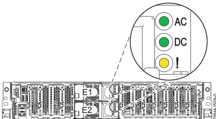
Abbildung 7. Position der Netzteile und Anzeigen im System
