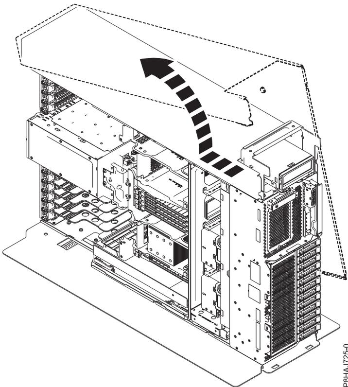
Abbildung 33. Ausbauen der Seitenabdeckung bei einem Standalone-System vom Typ 8286-41A
