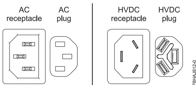
Abbildung 15. AC- und HVDC-Anschlüsse
