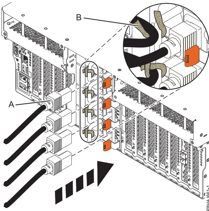
Abbildung 24. Netzkabel an ein System vom Typ 8247-42L, 8286-41A oder 8286-42A anschließen
