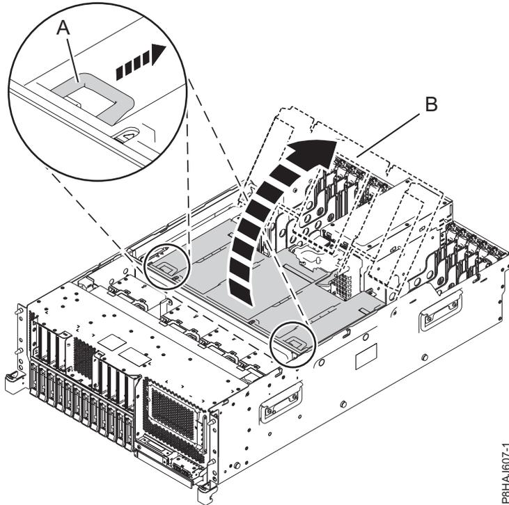
Abbildung 27. Öffnen der Luftführung
