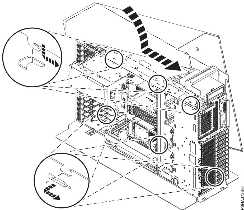
Abbildung 21. Seitenabdeckung bei einem eigenständigen System vom Typ 8286-41A installieren
