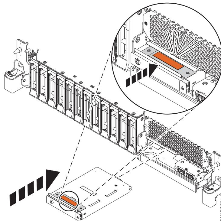
Abbildung 2. Steuerkonsole austauschen
