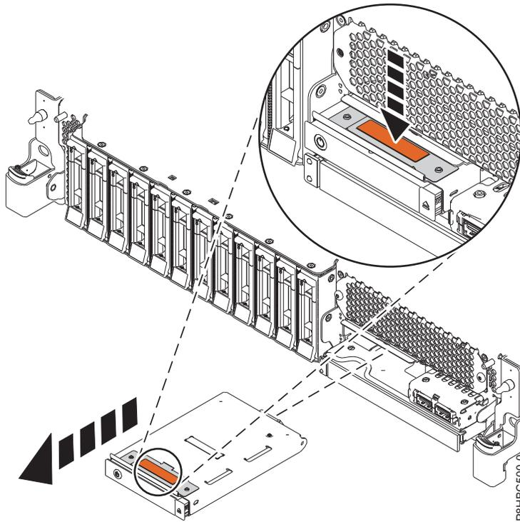
Abbildung 4. Steuerkonsole ausbauen
