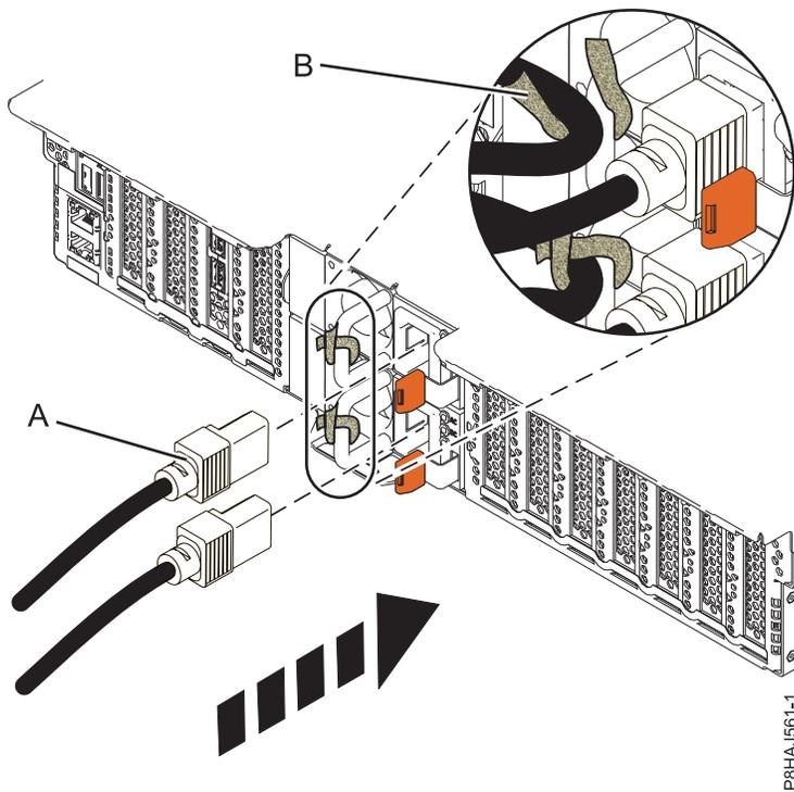
Abbildung 44. Netzka­bel an ein System vom Typ 5148-21L, 5148-22L, 8247-21L, 8247-22L, 8284-21A oder 8284-22A anschließen
