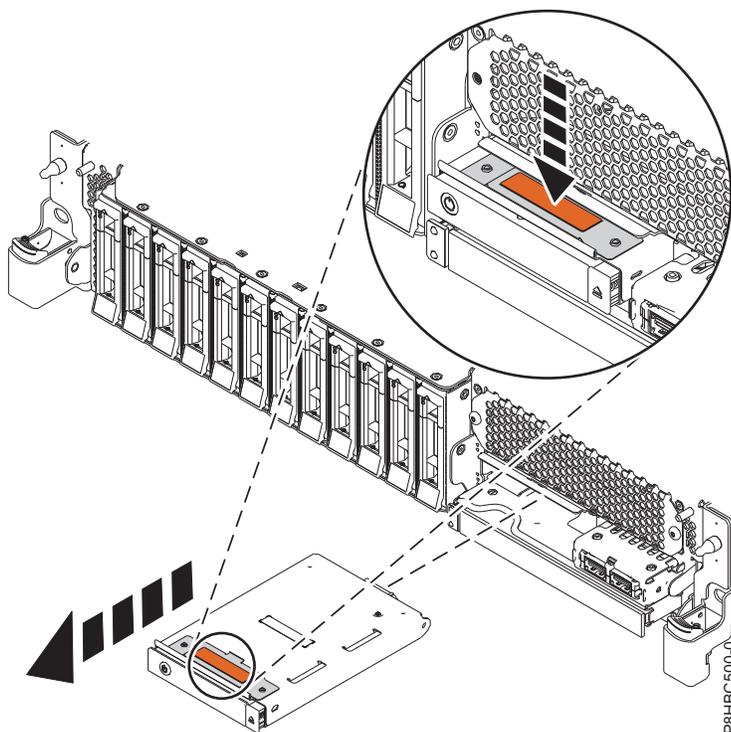
Abbildung 1. Steuerkonsole ausbauen
