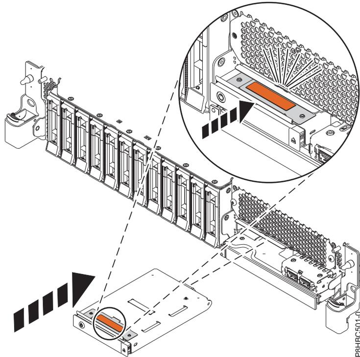
Abbildung 5. Steuerkonsole austauschen
