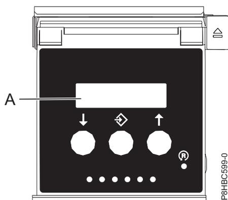
Abbildung 3. Funktionsanzeige der Steuerkonsole
