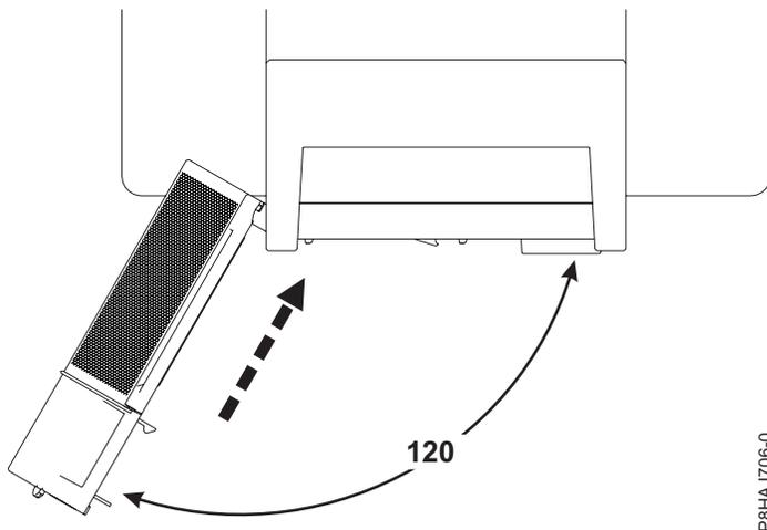
Abbildung 18. Drehen der vorderen Abdeckung
