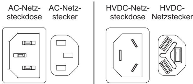
Abbildung 40. AC- und HVDC-Anschlüsse
