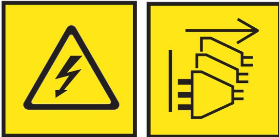
**Gefahr:** Mehrere Netzkabel. Dieses Produkt kann mit mehreren Wechselstromkabeln oder mehreren Gleichstromkabeln ausgestattet sein. Alle Netzkabel abziehen, um gefährliche Spannungen zu verhindern. (L003)
