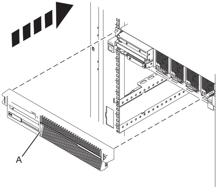
Abbildung 42. Vordere Abdeckung des Systemcontrollers installieren
