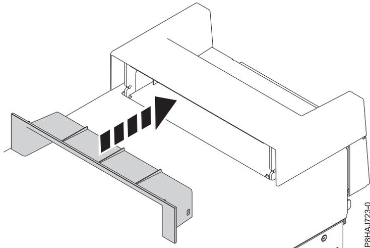
Abbildung 20. Einsetzen des Elements innerhalb der Griffabdeckung bei einem Standalone-System vom Typ 8286-41A
