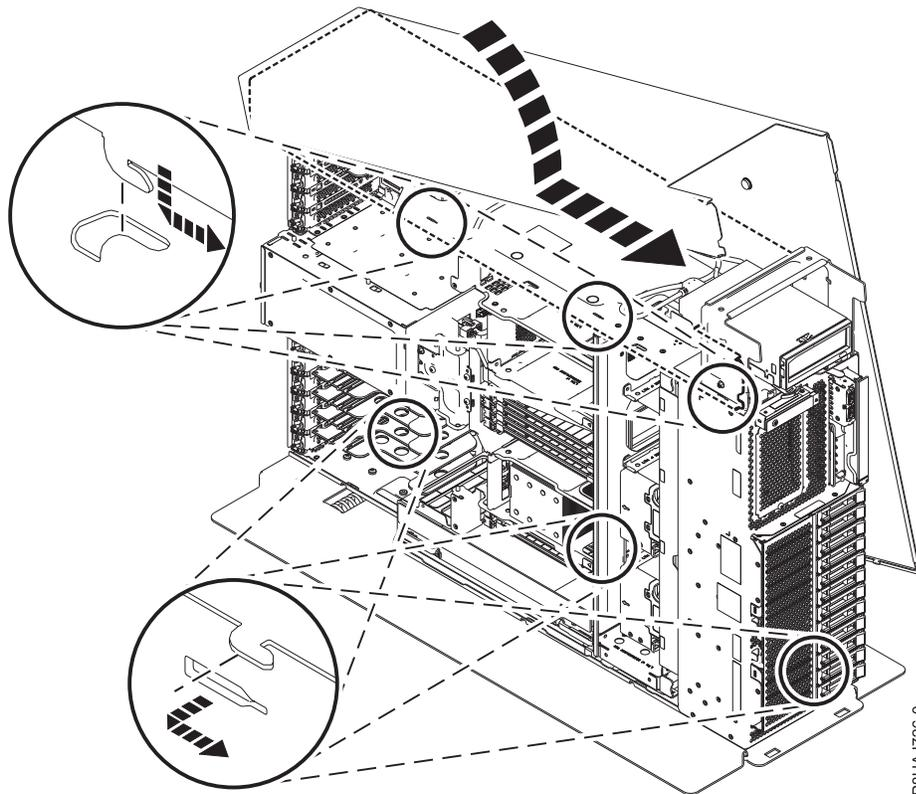
Abbildung 21. Installieren der Seitenabdeckung bei einem Standalone-System vom Typ 8286-41A
