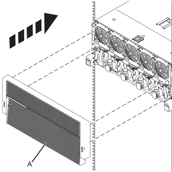
Abbildung 41. Vordere Abdeckung installieren
