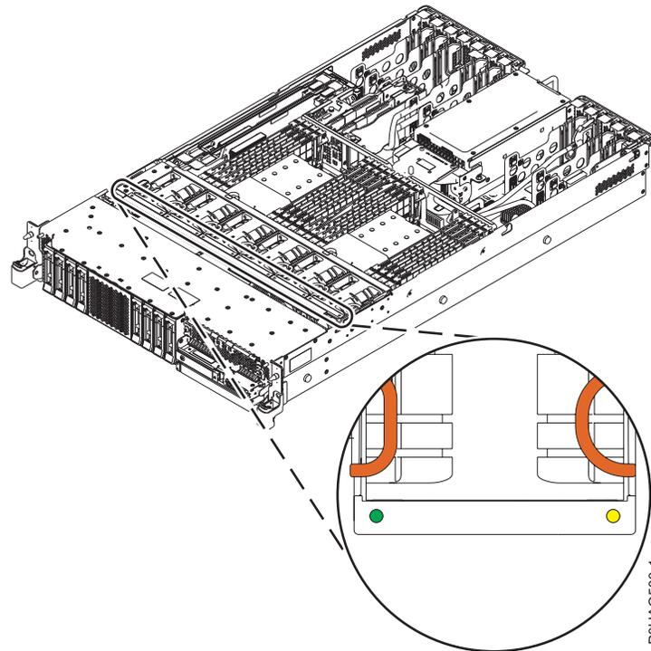
Abbildung 1. Anzeigen am Lüfterrahmen für die AMDs
