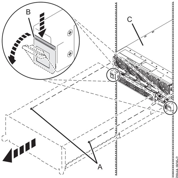
Abbildung 46. System in Serviceposition bringen
