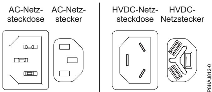
Abbildung 48. AC- und HVDC-Anschlüsse
