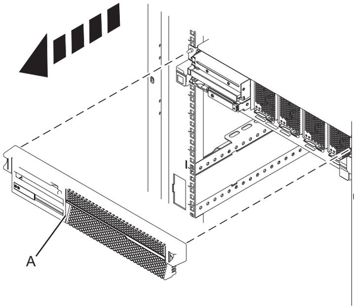
Abbildung 40. Vordere Abdeckung des Systemcontrollers ausbauen
