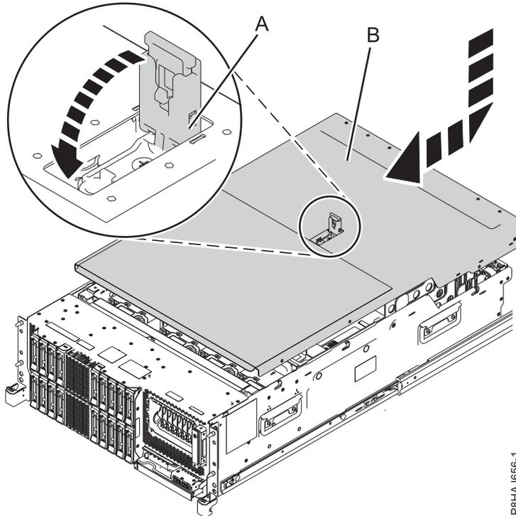
Abbildung 25. Serviceabdeckung installieren
