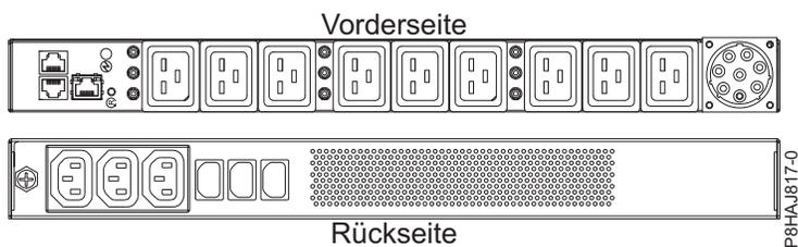
Abbildung 50. PDU beim System vom Typ 8408-44E
