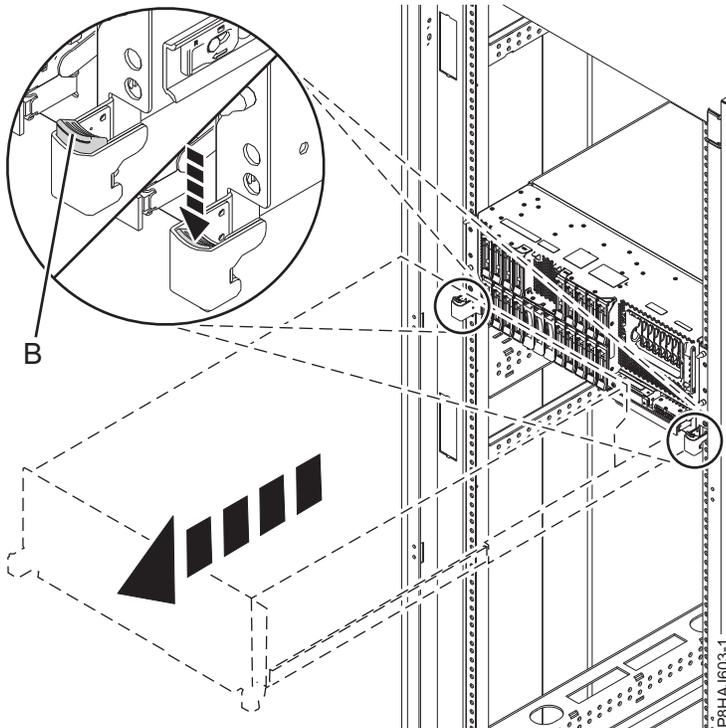
Abbildung 44. Seitliche Verriegelungen entriegeln
