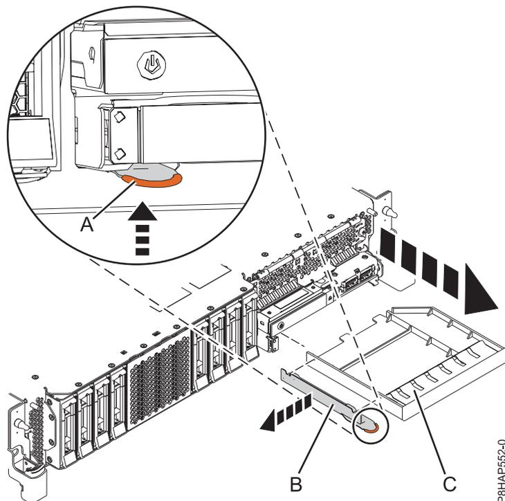
Abbildung 26. Entfernen Sie die Abdeckblende der Einheit für austauschbare Datenträger und die Halterung aus dem System.
