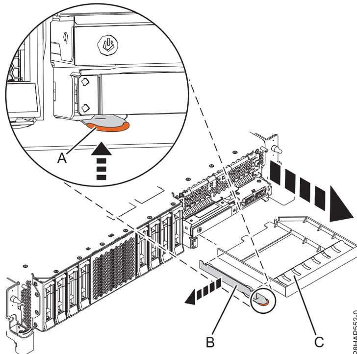
Abbildung 42. Entfernen Sie die Abdeckblende der Einheit für austauschbare Datenträger und die Halterung aus dem System.
