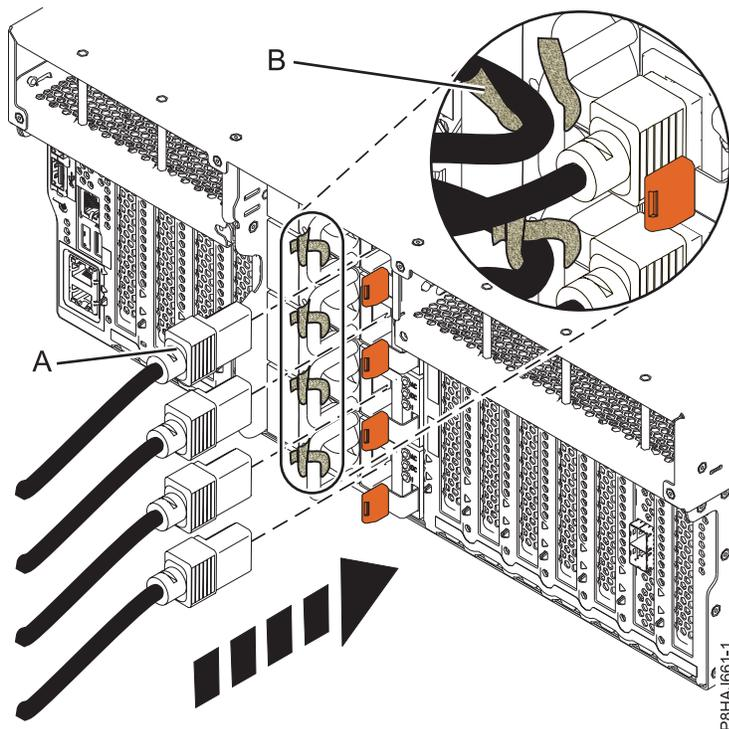
Abbildung 108. Netzkabel an ein System vom Typ 8247-42L, 8286-41A oder 8286-42A anschließen
