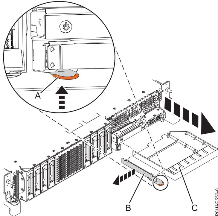
Abbildung 19. Entfernen Sie die Abdeckblende der Einheit für austauschbare Datenträger und die Halterung aus dem System.
