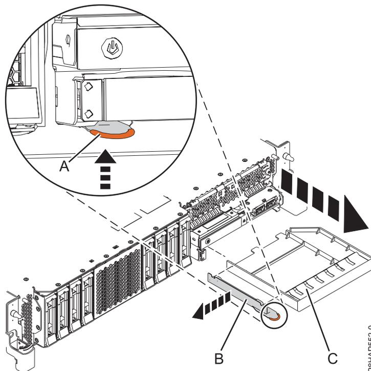
Abbildung 33. Entfernen Sie die Abdeckblende der Einheit für austauschbare Datenträger und die Halterung aus dem System.
