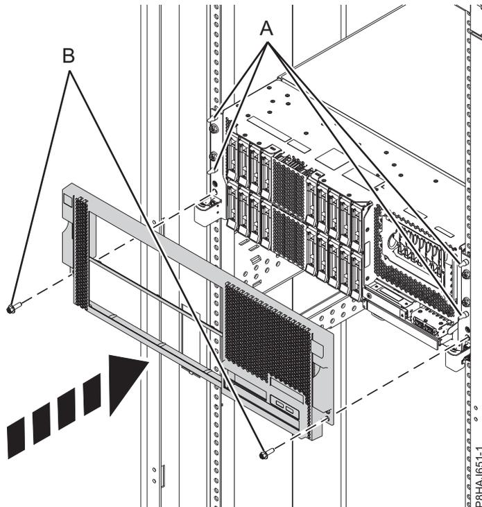
Abbildung 81. Vordere Abdeckung installieren
