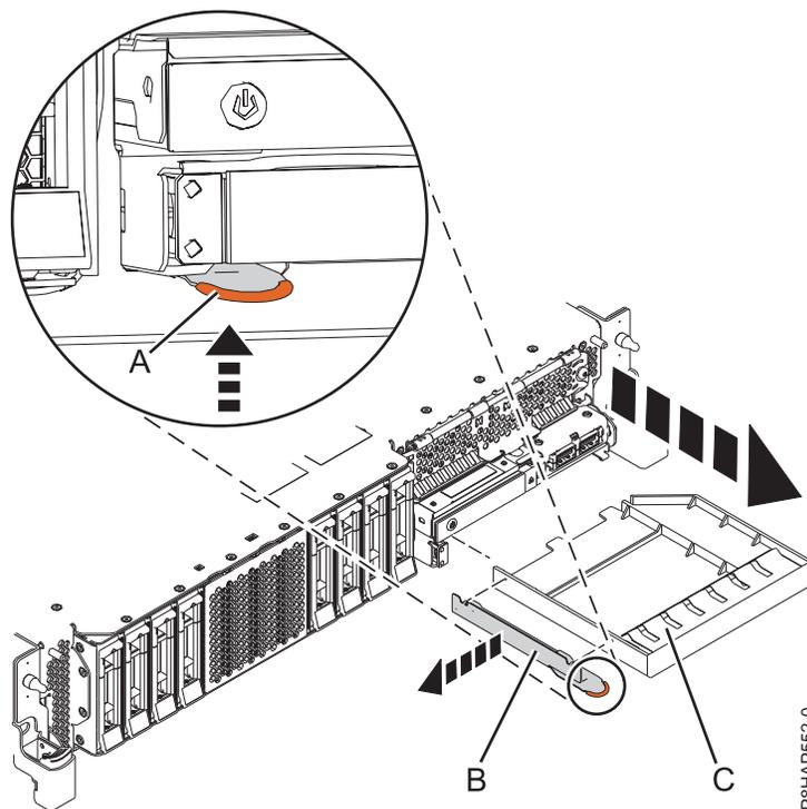
Abbildung 49. Entfernen Sie die Abdeckblende der Einheit für austauschbare Datenträger und die Halterung aus dem System.
