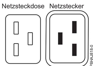
Abbildung 100. Anschlüsse beim System vom Typ 8408-44E
