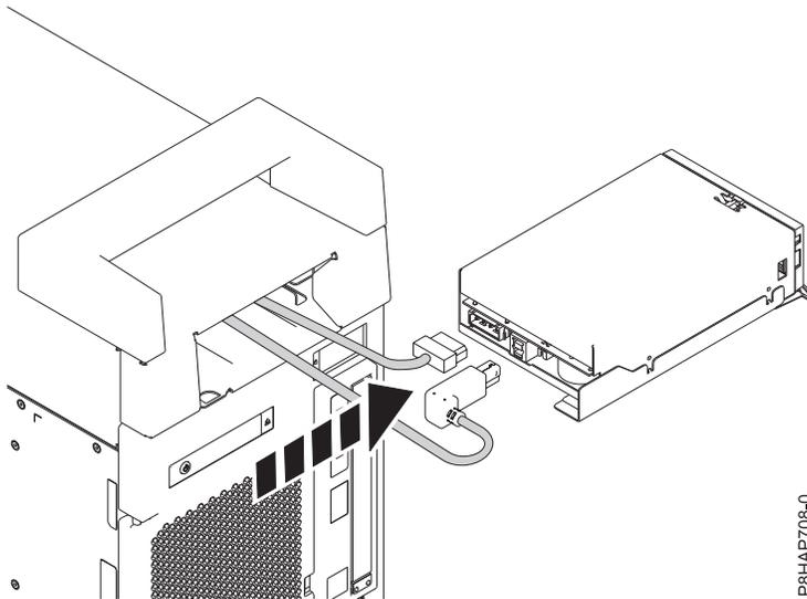
Abbildung 63. Anschließen des USB-Kabels und des Netzkabels der Interne RDX-Andockstation (FC EUA3)
