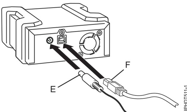
Abbildung 60. USB-Kabel und Netzkabel anschließen
