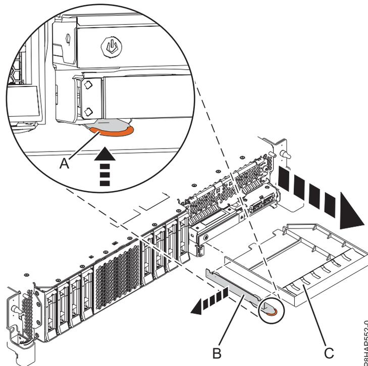
Abbildung 15. Entfernen Sie die Abdeckblende der Einheit für austauschbare Datenträger und die Halterung aus dem System.
