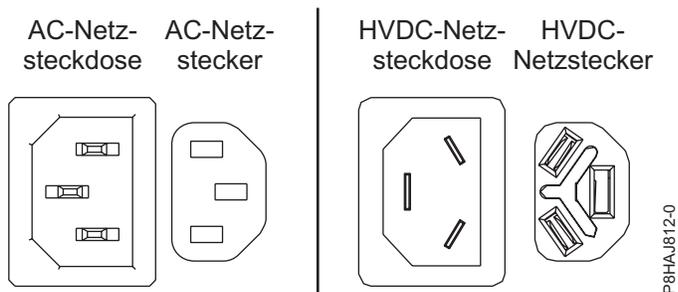
Abbildung 99. AC- und HVDC-Anschlüsse
