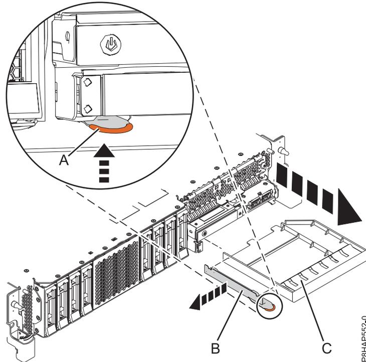
Abbildung 1. Entfernen Sie die Abdeckblende der Einheit für austauschbare Datenträger und die Halterung aus dem System.
