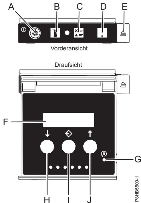
Abbildung 71. Anzeigen der Steuerkonsole
