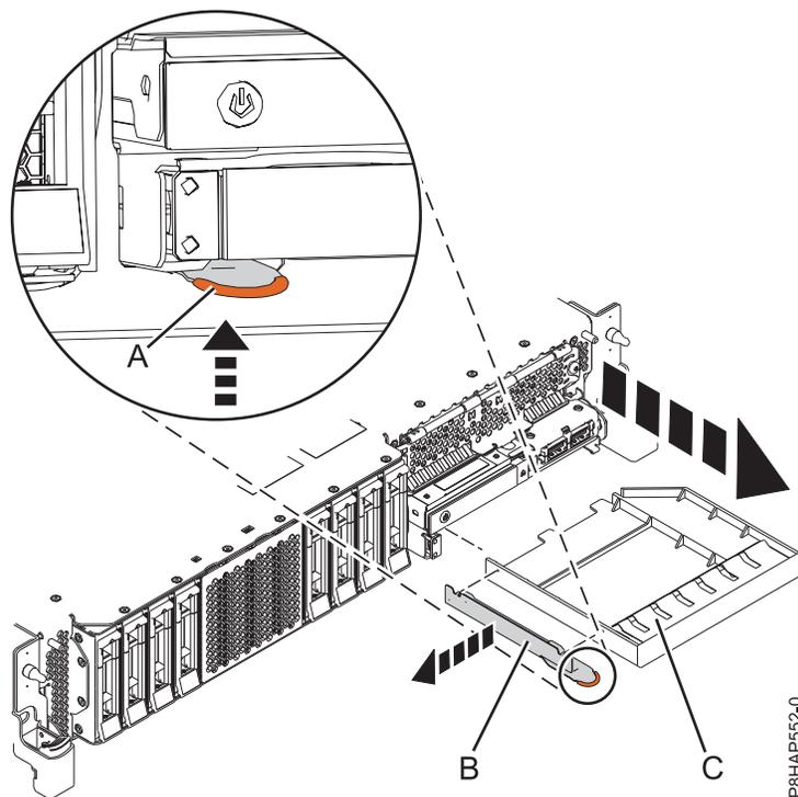
Abbildung 56. Entfernen Sie die Abdeckblende der Einheit für austauschbare Datenträger und die Halterung aus dem System.
