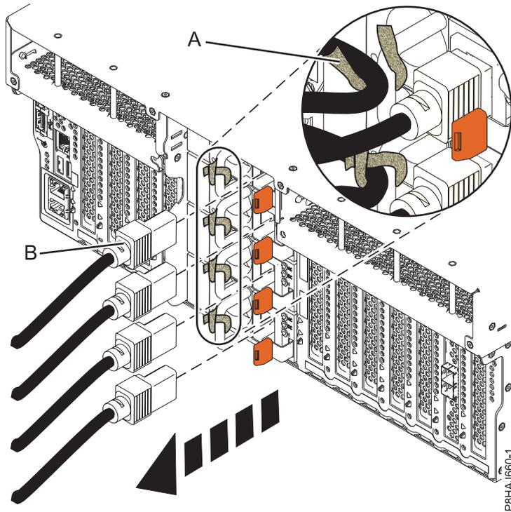
Abbildung 102. Netzkabel bei einem System vom Typ 8247-42L, 8286-41A oder 8286-42A abziehen
