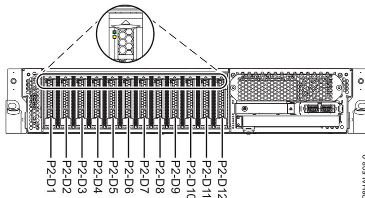
Abbildung 1. Positionen für Plattenlaufwerke und Serviceindikatoren für ein System mit Basisfunktionen
