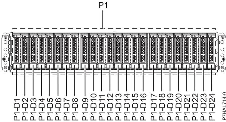
Abbildung 106. Vorderansicht des Plattenlaufwerkgehäuses 5887 mit den Positionen der Plattenlaufwerke
