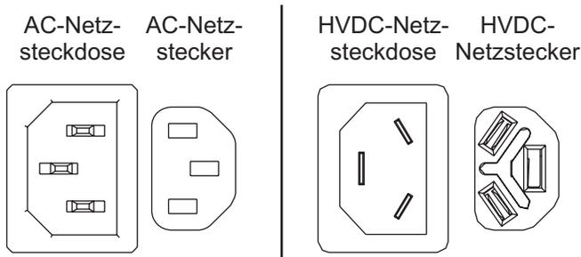
Abbildung 123. AC- und HVDC-Anschlüsse
