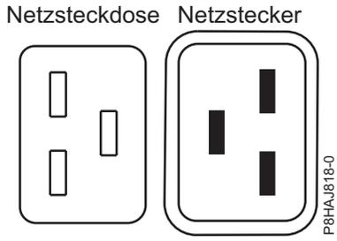
Abbildung 124. Anschlüsse beim System vom Typ 8408-44E
