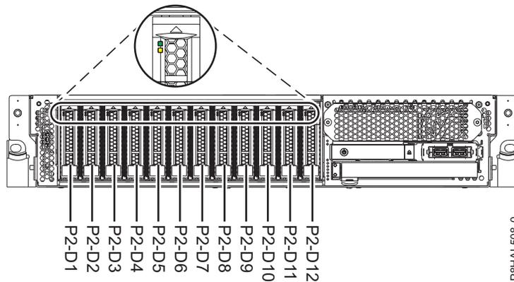
Abbildung 10. Positionen für Plattenlaufwerke und Serviceindikatoren für ein System mit Basisfunktionen
