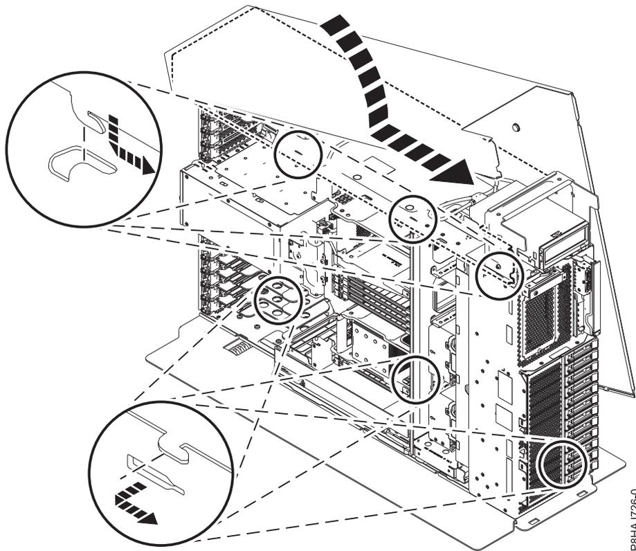
Abbildung 142. Seitenabdeckung bei einem eigenständigen System vom Typ 8286-41A installieren
