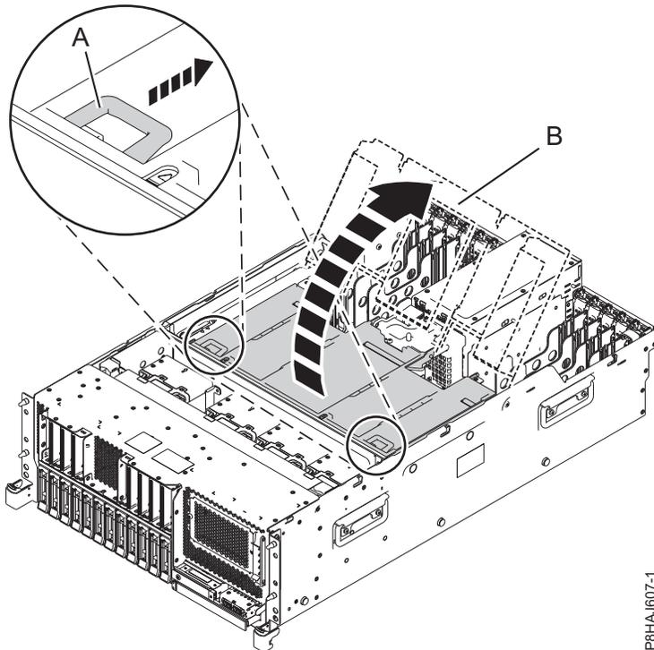
Abbildung 148. Öffnen der Luftführung
