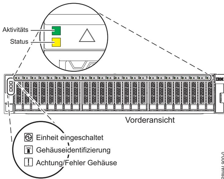
Abbildung 112. Vorderansicht des Gehäuses mit den Serviceindikatoren
