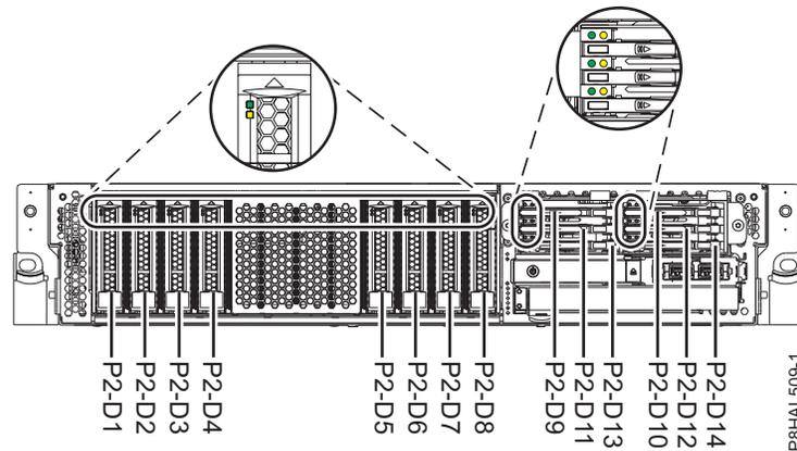
Abbildung 71. Positionen für Plattenlaufwerke, Solid-State-Laufwerke und Serviceindikatoren für ein System mit erweiterten Funktionen
