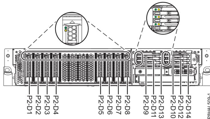
Abbildung 83. Positionen für Plattenlaufwerke, Solid-State-Laufwerke und Serviceindikatoren für ein System mit erweiterten Funktionen
