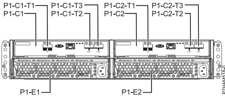
Abbildung 107. Rückansicht des Plattenlaufwerkgehäuses 5887
