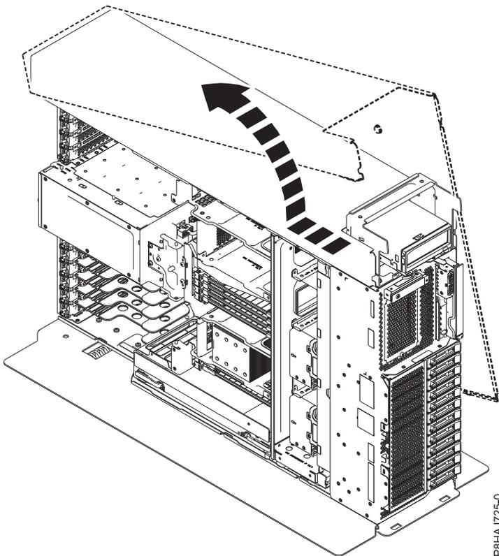
Abbildung 135. Seitenabdeckung bei einem eigenständigen System vom Typ 8286-41A ausbauen
