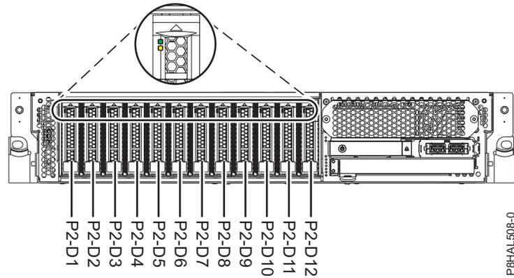
Abbildung 104. Positionen der Plattenlaufwerke und Serviceindikatoren für ein System vom Typ 5148-21L, 5148-22L, 8247-21L, 8247-22L, 8284-21A oder 8284-22A mit Basisfunktionen
