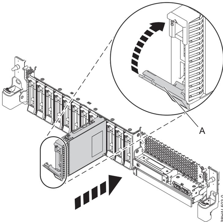
Abbildung 54. Plattenlaufwerk in einem System mit Basisfunktionen austauschen
