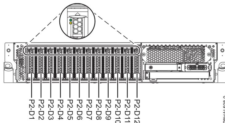
Abbildung 18. Positionen für Plattenlaufwerke und Serviceindikatoren für ein System mit Basisfunktionen
