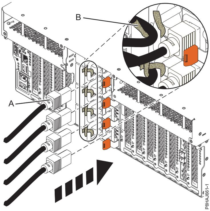
Abbildung 126. Netzkabel an ein System vom Typ 8247-42L, 8286-41A oder 8286-42A anschließen
