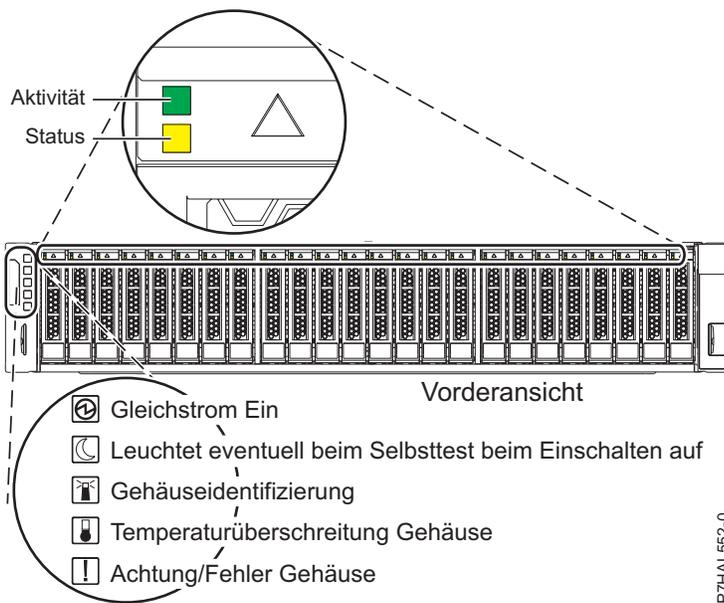
Abbildung 108. Vorderansicht des Plattenlaufwerkgehäuses 5887 mit den Serviceindikatoren
