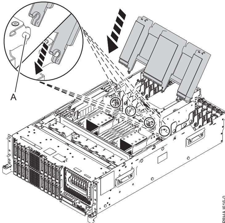
Abbildung 151. Luftführung installieren
