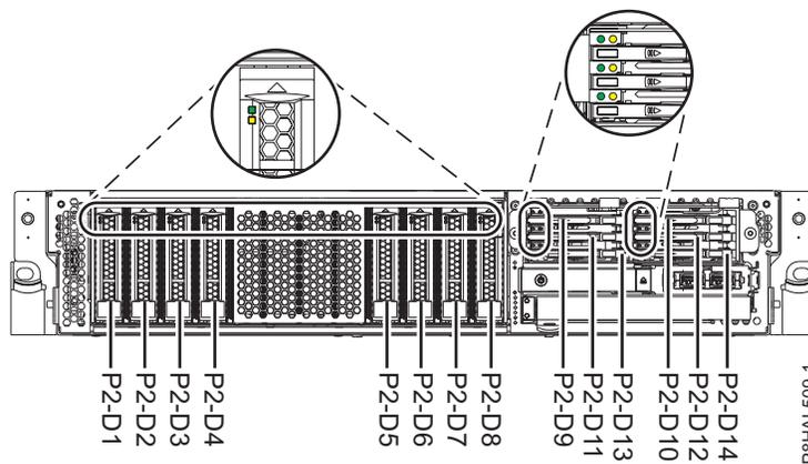
Abbildung 11. Positionen für Plattenlaufwerke, Solid-State-Laufwerke und Serviceindikatoren für ein System mit erweiterten Funktionen
