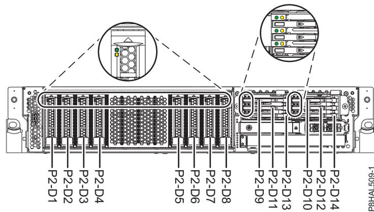
Abbildung 105. Positionen der Plattenlaufwerke, Solid-State-Laufwerke und Serviceindikatoren für ein System vom Typ 5148-21L, 5148-22L, 8247-21L, 8247-22L, 8284-21A oder 8284-22A mit erweiterten Funktionen
