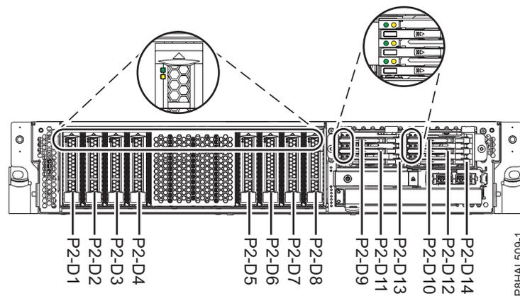
Abbildung 29. Positionen für Plattenlaufwerke, Solid-State-Laufwerke und Serviceindikatoren für ein System mit erweiterten Funktionen
