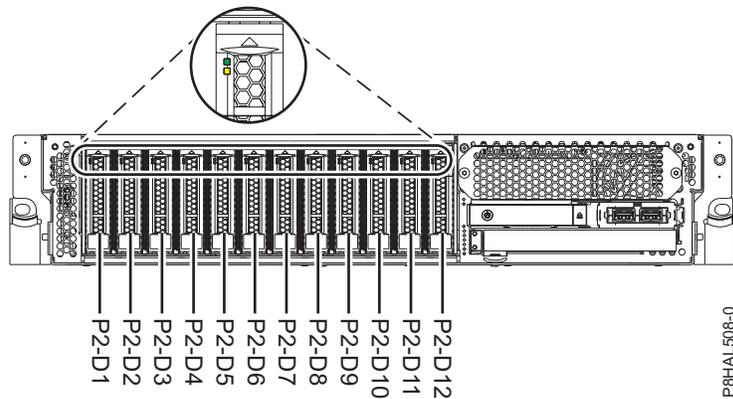
Abbildung 48. Positionen für Plattenlaufwerke und Serviceindikatoren für ein System mit Basisfunktionen
