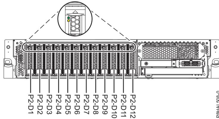
Abbildung 82. Positionen für Plattenlaufwerke und Serviceindikatoren für ein System mit Basisfunktionen
