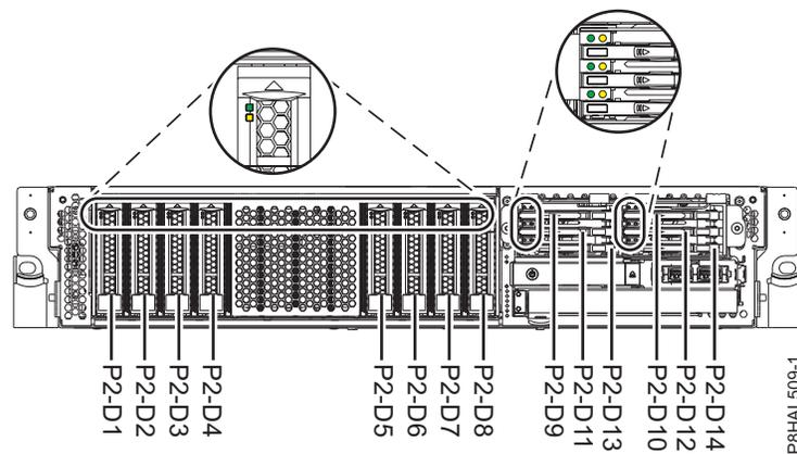
Abbildung 39. Positionen für Plattenlaufwerke, Solid-State-Laufwerke und Serviceindikatoren für ein System mit erweiterten Funktionen
