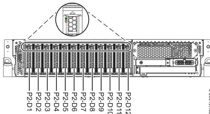
Abbildung 70. Positionen für Plattenlaufwerke und Serviceindikatoren für ein System mit Basisfunktionen
