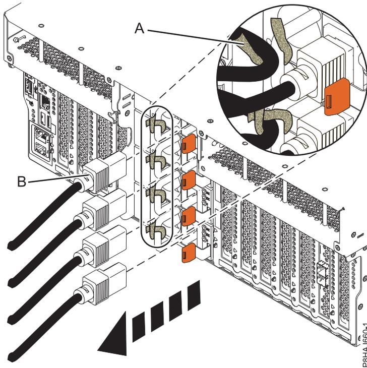
Abbildung 120. Netzkabel bei einem System vom Typ 8247-42L, 8286-41A oder 8286-42A abziehen
