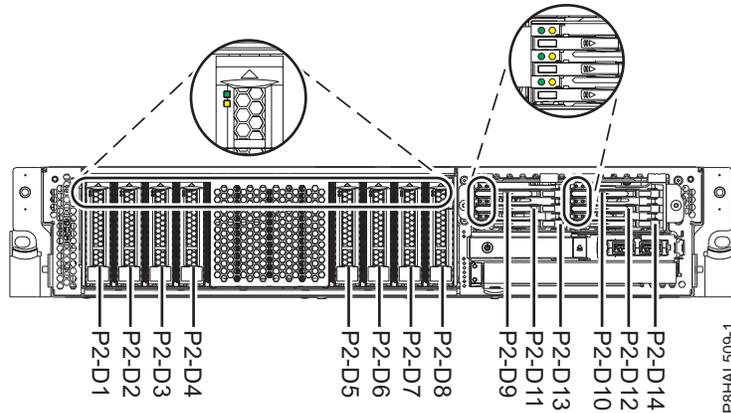
Abbildung 19. Positionen für Plattenlaufwerke, Solid-State-Laufwerke und Serviceindikatoren für ein System mit erweiterten Funktionen
