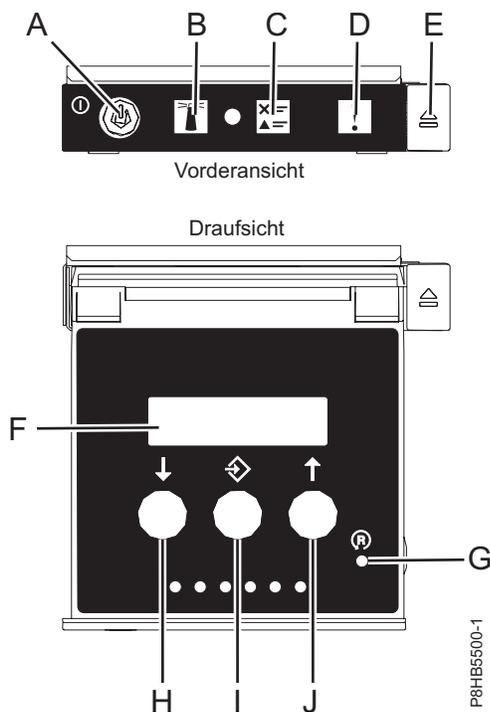
Abbildung 115. LEDs der Steuerkonsole
