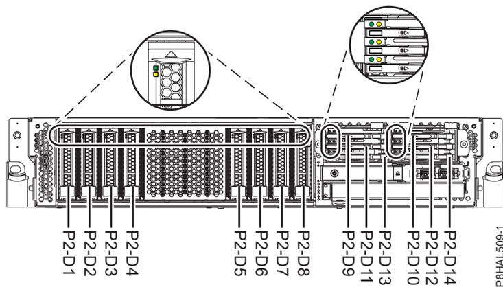
Abbildung 49. Positionen für Plattenlaufwerke, Solid-State-Laufwerke und Serviceindikatoren für ein System mit erweiterten Funktionen
