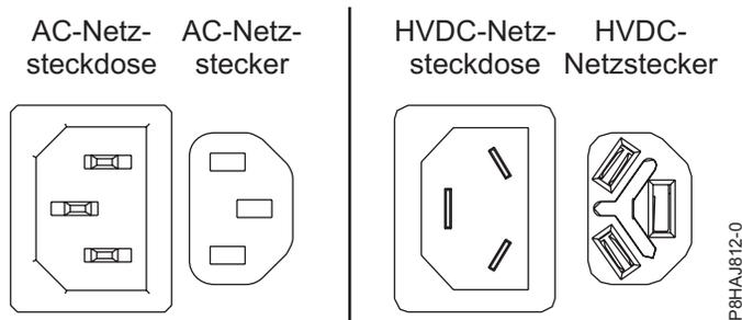
Abbildung 117. AC- und HVDC-Anschlüsse
