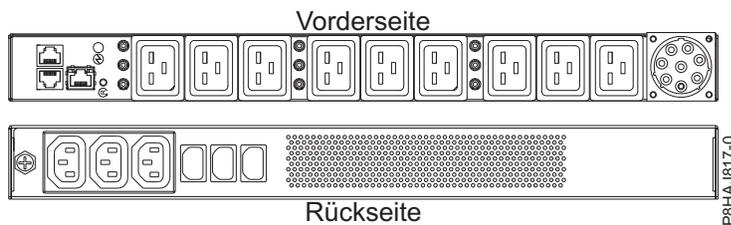
Abbildung 119. PDU beim System vom Typ 8408-44E
