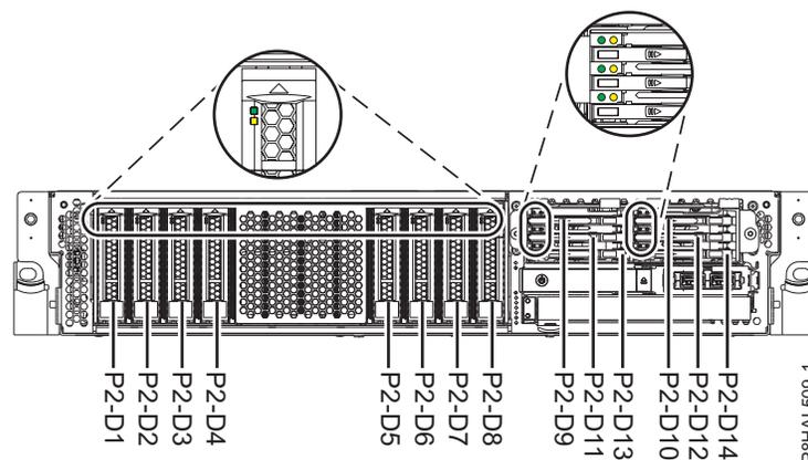
Abbildung 6. Positionen für Plattenlaufwerke, Solid-State-Laufwerke und Serviceindikatoren für ein System mit erweiterten Funktionen
