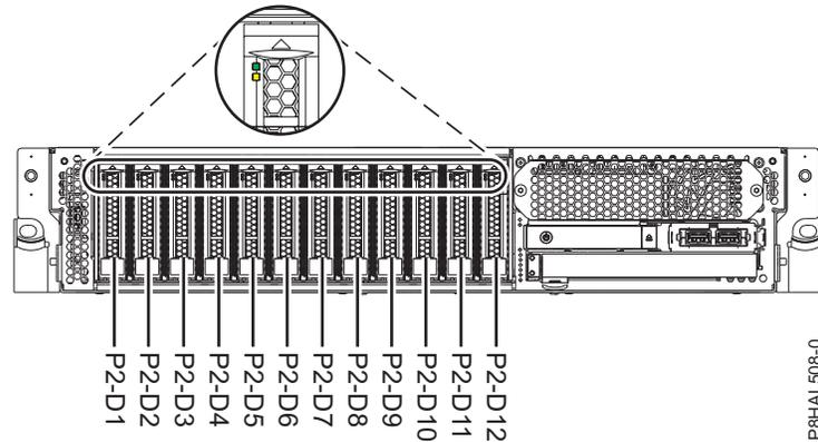
Abbildung 38. Positionen für Plattenlaufwerke und Serviceindikatoren für ein System mit Basisfunktionen
