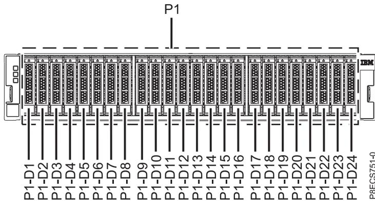
Abbildung 110. Vorderansicht der ESLS-Speichereinheit mit den Positionen der Plattenlaufwerke
