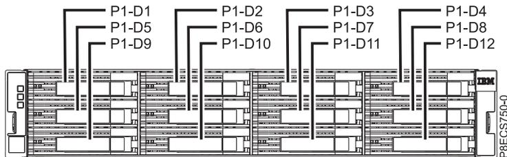
Abbildung 109. Vorderansicht der ESLL-Speichereinheit mit den Positionen der Plattenlaufwerke
