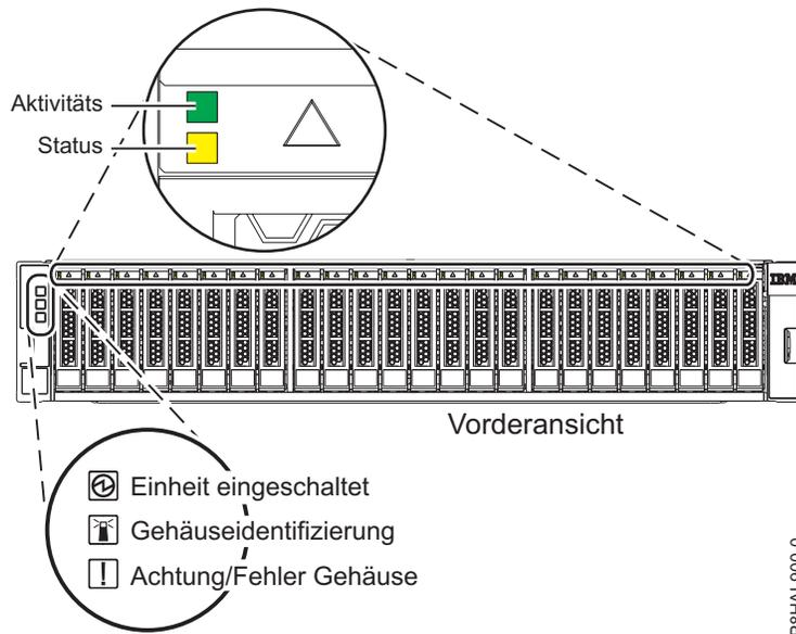
Abbildung 151. Vorderansicht des Gehäuses mit den Serviceindikatoren
