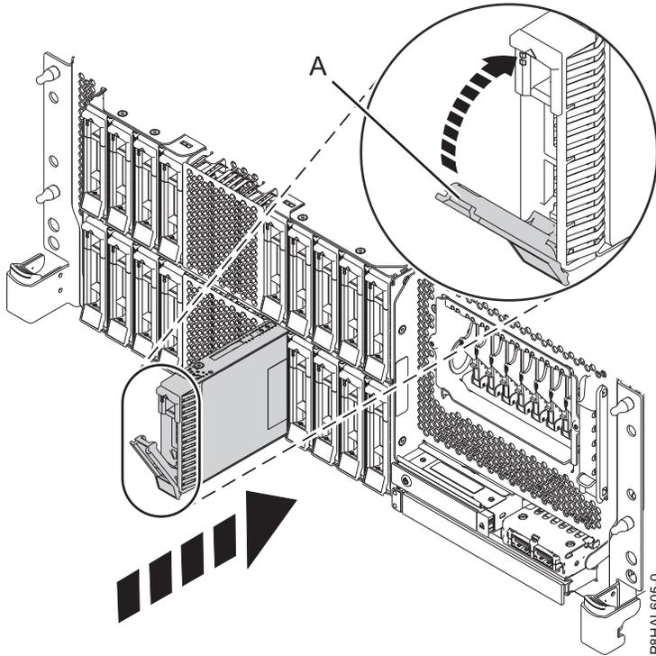
Abbildung 47. Plattenlaufwerk in einem Einschubsystem mit erweiterten Funktionen installieren
