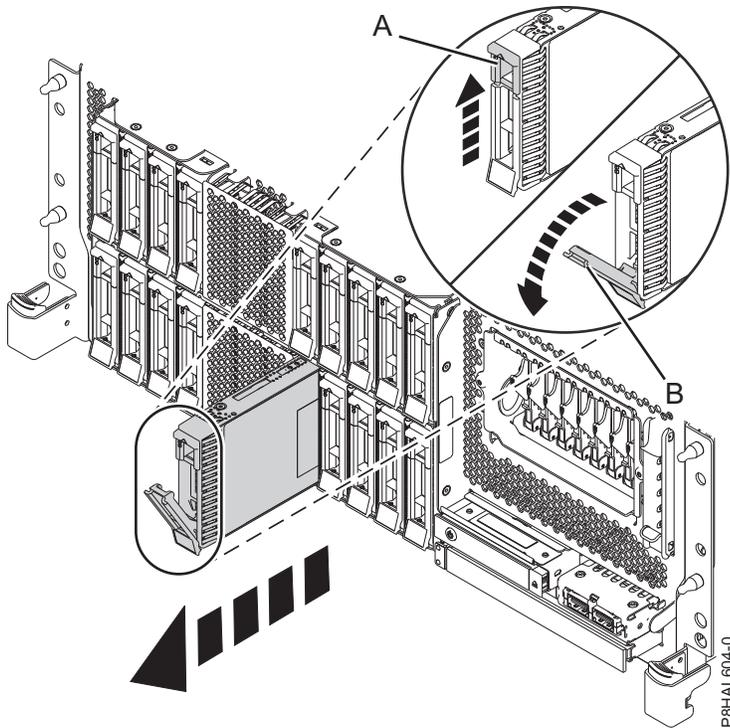
Abbildung 102. Plattenlaufwerk in einem Einschubsystem mit erweiterten Funktionen ausbauen
