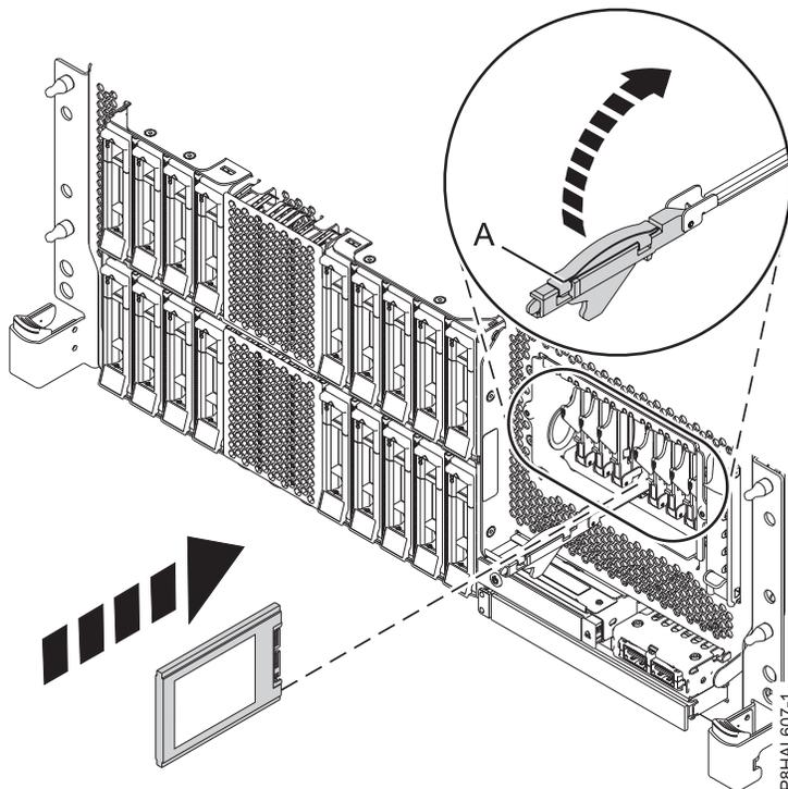
Abbildung 50. SSD in einem Einschubsystem vom Typ 8286-41A oder 8286-42A mit erweiterten Funktionen installieren
