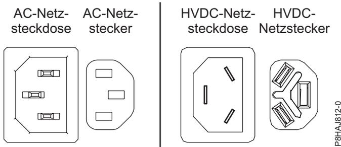
Abbildung 156. AC- und HVDC-Anschlüsse
