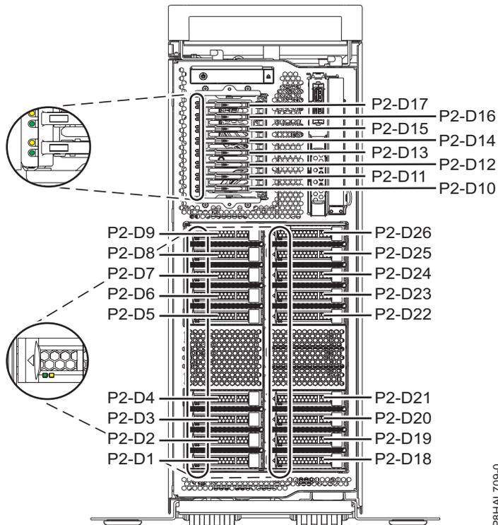
Abbildung 43. Positionen der Plattenlaufwerke, Solid-State-Laufwerke und Serviceindikatoren in einem Standalone-System vom Typ 8286-41A mit erweiterten Funktionen
