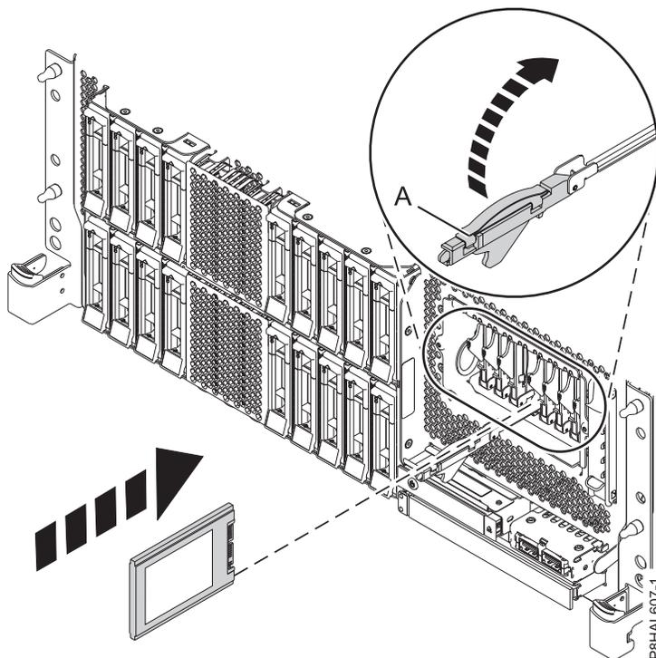
Abbildung 25. Solid-State-Laufwerk in einem Einschubsystem mit erweiterten Funktionen installieren
