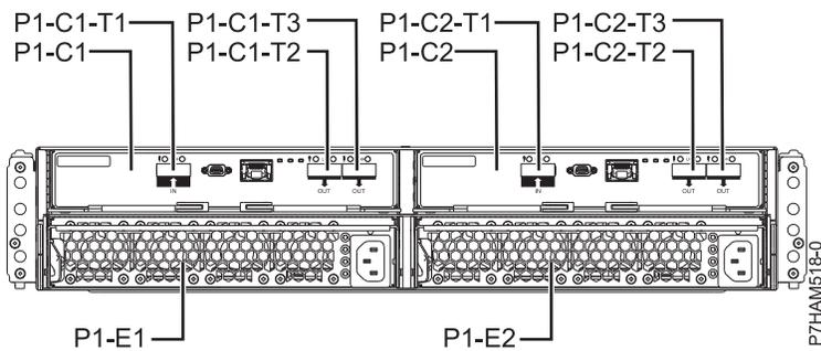
Abbildung 146. Rückansicht des Plattenlaufwerkgehäuses 5887
