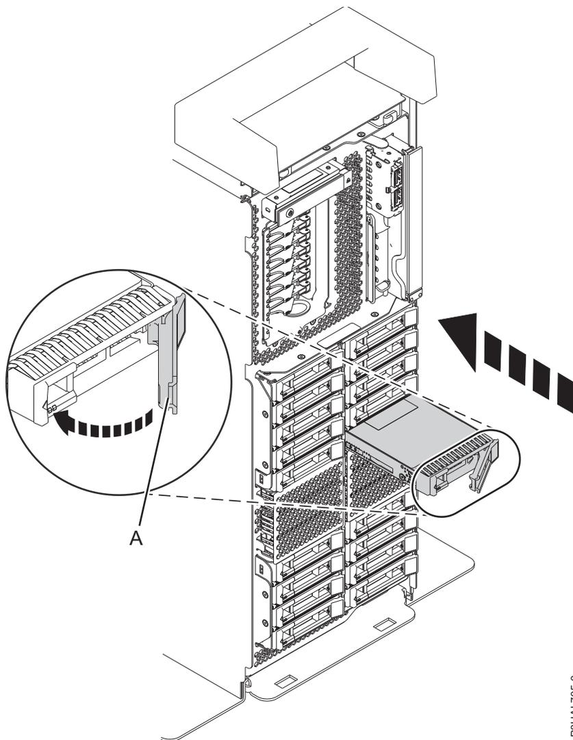
Abbildung 9. Plattenlaufwerk installieren - Standalone-System mit erweiterten Funktionen
