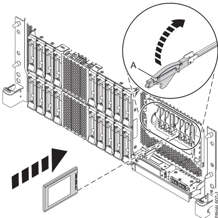
Abbildung 67. Solid-State-Laufwerk in einem Einschubsystem mit erweiterten Funktionen austauschen
