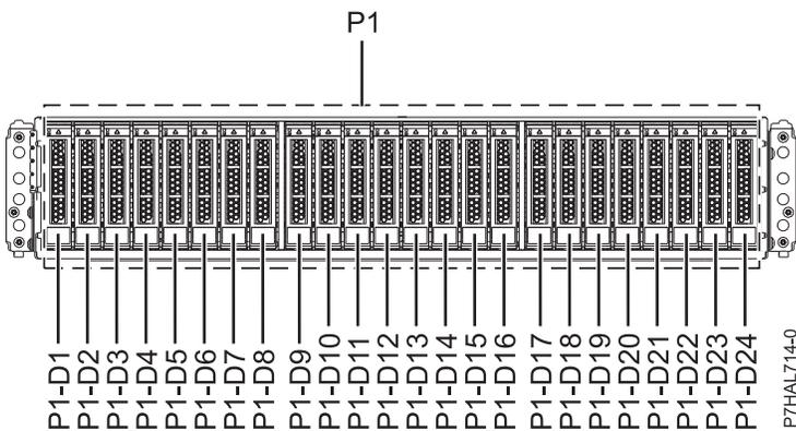
Abbildung 145. Vorderansicht des Plattenlaufwerkgehäuses 5887 mit den Positionen der Plattenlaufwerke
