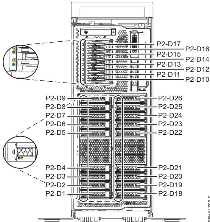
Abbildung 19. Positionen der Plattenlaufwerke, Solid-State-Laufwerke und Serviceindikatoren in einem Standalone-System vom Typ 8286-41A mit erweiterten Funktionen
