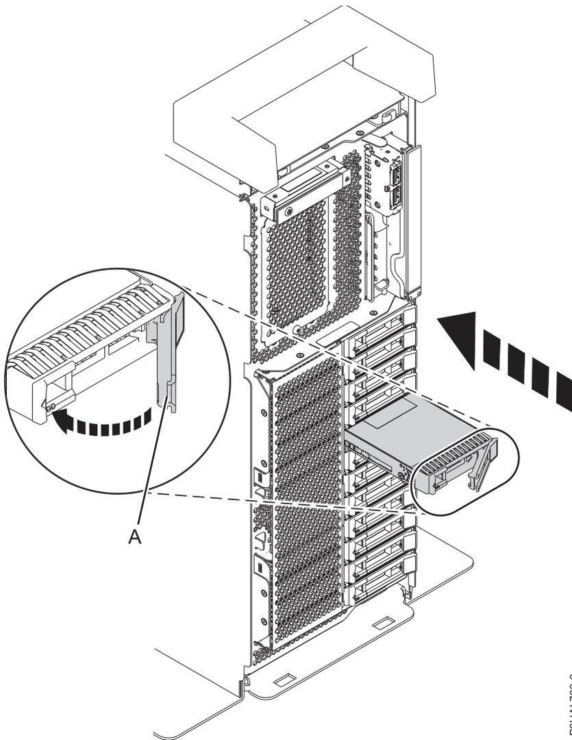
Abbildung 81. Plattenlaufwerk in einem Standalone-System mit Basisfunktionen austauschen
