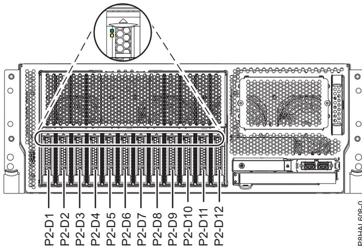
Abbildung 53. Positionen der Plattenlaufwerke oder Solid-State-Laufwerke und Serviceindikatoren in einem Einschubsystem vom Typ 8247-42L, 8286-41A oder 8286-42A mit Basisfunktionen
