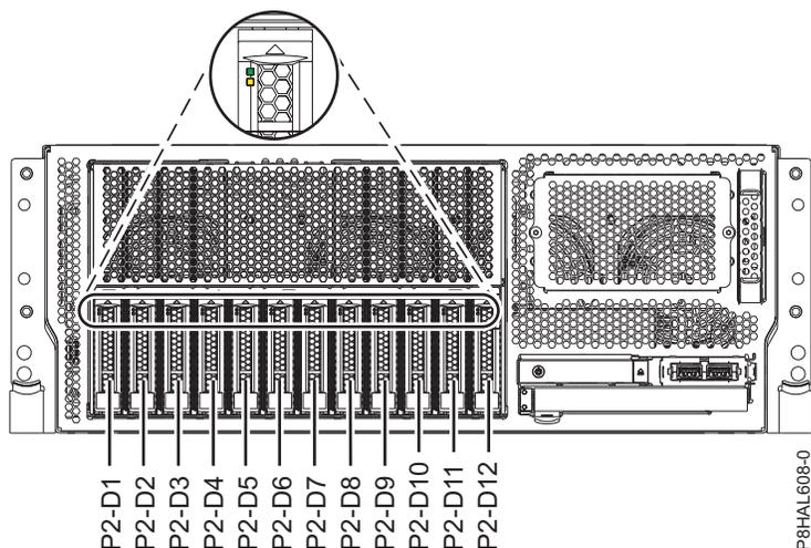
Abbildung 1. Positionen der Plattenlaufwerke oder Solid-State-Laufwerke und Serviceindikatoren in einem Einschubsystem vom Typ 8247-42L, 8286-41A oder 8286-42A mit Basisfunktionen
