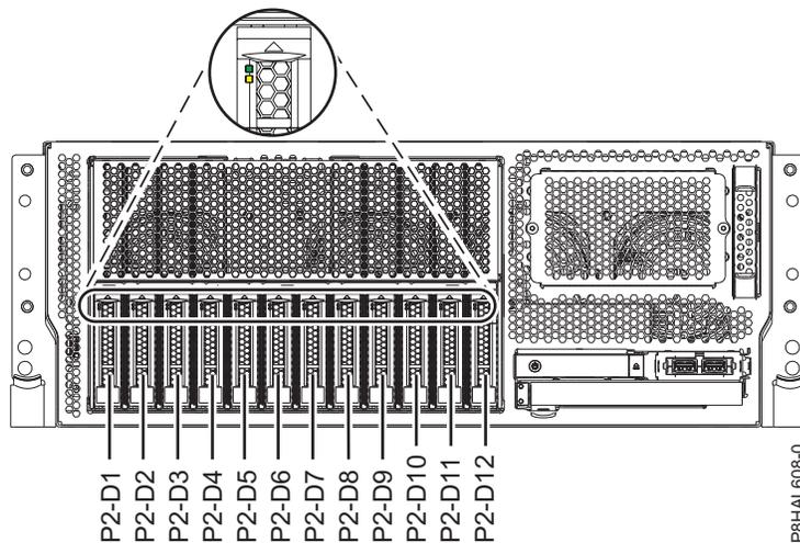
Abbildung 10. Positionen der Plattenlaufwerke oder Solid-State-Laufwerke und Serviceindikatoren in einem Einschubsystem vom Typ 8247-42L, 8286-41A oder 8286-42A mit Basisfunktionen
