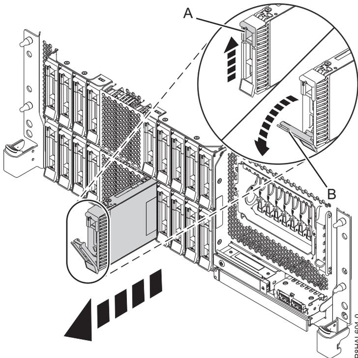
Abbildung 88. Plattenlaufwerk in einem Einschubsystem mit erweiterten Funktionen ausbauen
