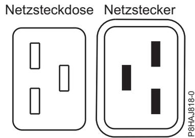
Abbildung 157. Anschlüsse beim System vom Typ 8408-44E
