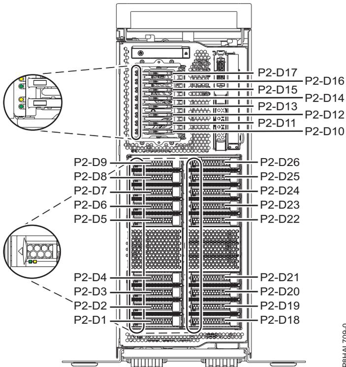
Abbildung 56. Positionen der Plattenlaufwerke, Solid-State-Laufwerke und Serviceindikatoren in einem Standalone-System vom Typ 8286-41A mit erweiterten Funktionen
