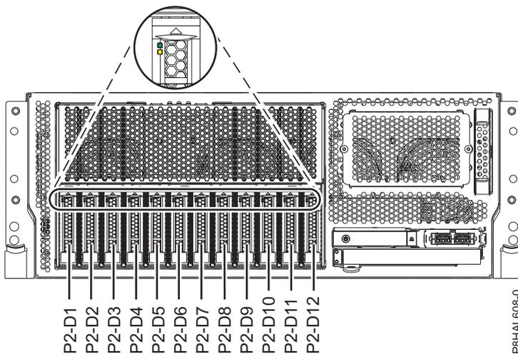
Abbildung 16. Positionen der Plattenlaufwerke oder Solid-State-Laufwerke und Serviceindikatoren in einem Einschubsystem vom Typ 8247-42L, 8286-41A oder 8286-42A mit Basisfunktionen
