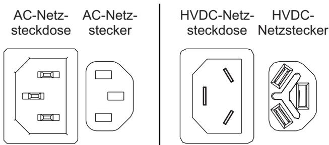
Abbildung 162. AC- und HVDC-Anschlüsse
