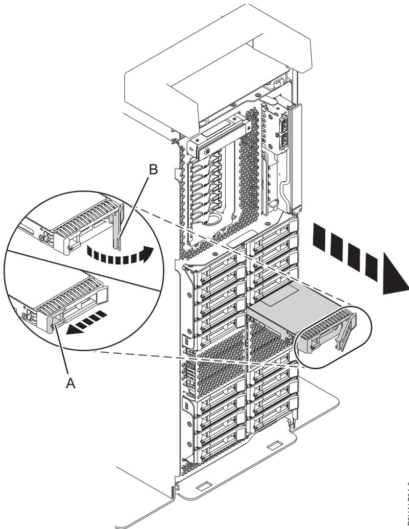
Abbildung 121. Plattenlaufwerk in einem Standalone-System mit erweiterten Funktionen ausbauen
