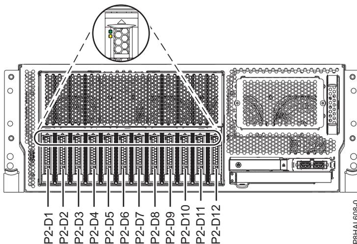
Abbildung 40. Positionen der Plattenlaufwerke oder Solid-State-Laufwerke und Serviceindikatoren in einem Einschubsystem vom Typ 8247-42L, 8286-41A oder 8286-42A mit Basisfunktionen
