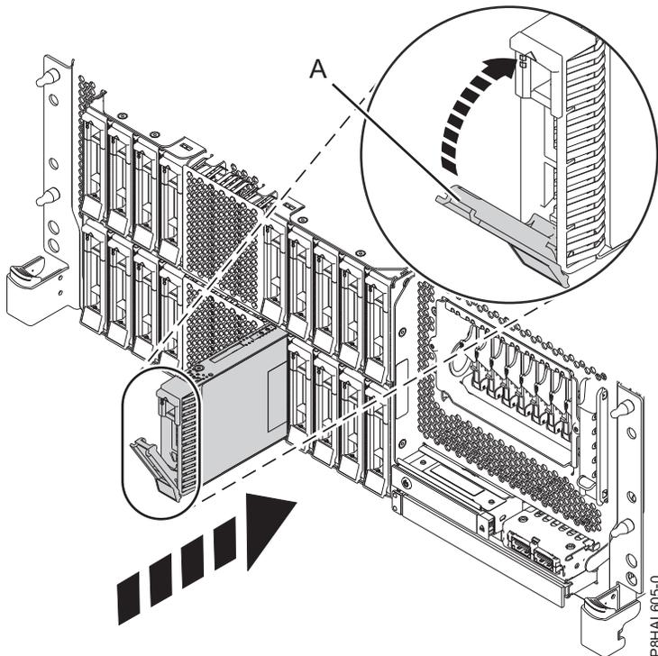
Abbildung 126. Plattenlaufwerk in einem Einschubsystem mit erweiterten Funktionen austauschen
