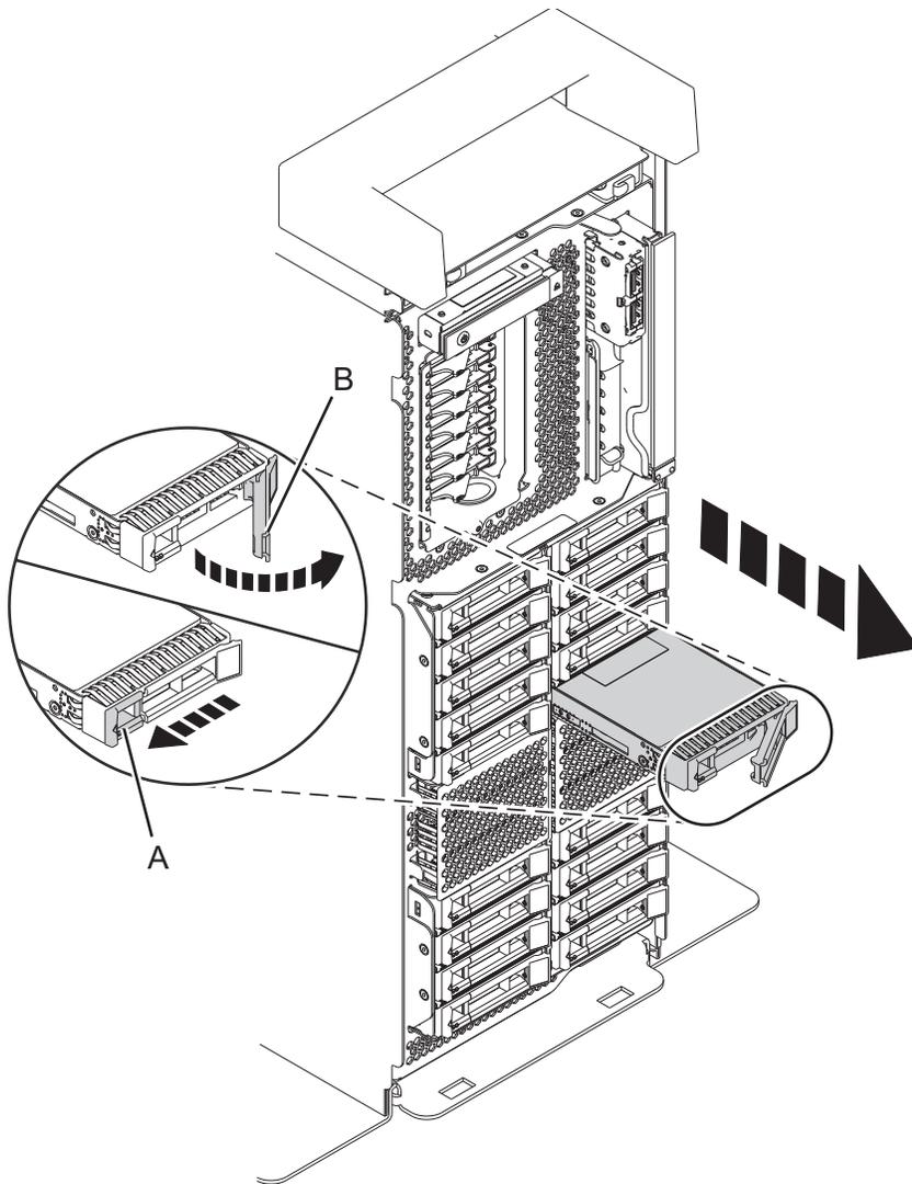
Abbildung 76. Plattenlaufwerk in einem Standalone-System mit erweiterten Funktionen ausbauen
