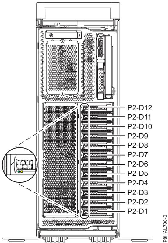
Abbildung 29. Positionen der Plattenlaufwerke oder Solid-State-Laufwerke und Serviceindikatoren in einem Standalone-System vom Typ 8286-41A mit Basisfunktionen
