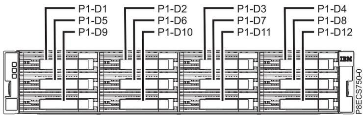
Abbildung 148. Vorderansicht der ESLL-Speichereinheit mit den Positionen der Plattenlaufwerke
