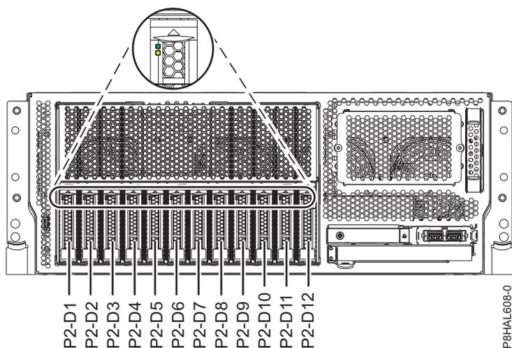
Abbildung 27. Positionen der Plattenlaufwerke oder Solid-State-Laufwerke und Serviceindikatoren in einem Einschubsystem vom Typ 8247-42L, 8286-41A oder 8286-42A mit Basisfunktionen
