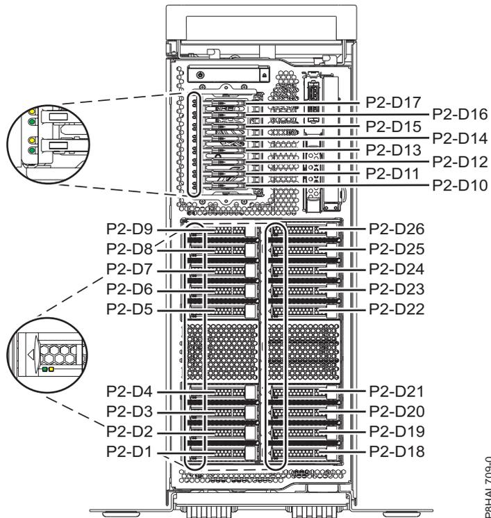
Abbildung 4. Positionen der Plattenlaufwerke, Solid-State-Laufwerke und Serviceindikatoren in einem Standalone-System vom Typ 8286-41A mit erweiterten Funktionen
