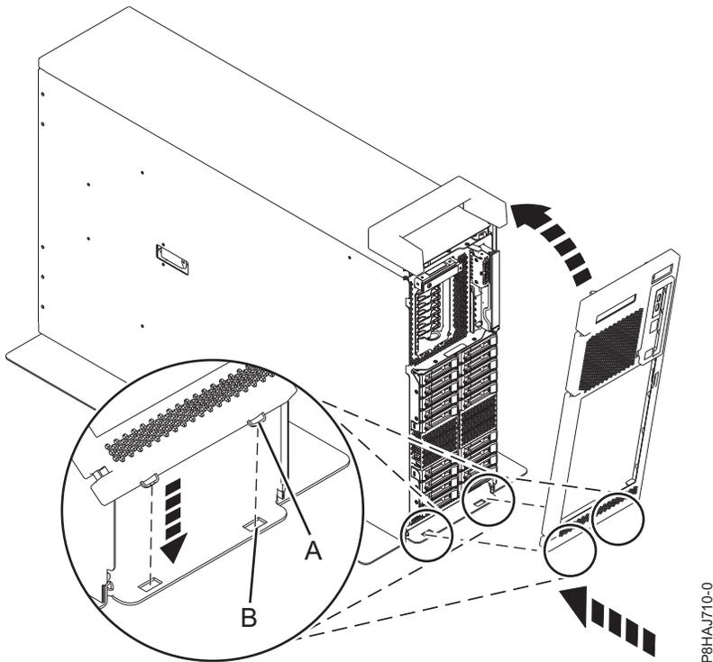
Abbildung 177. Vordere Abdeckung installieren
