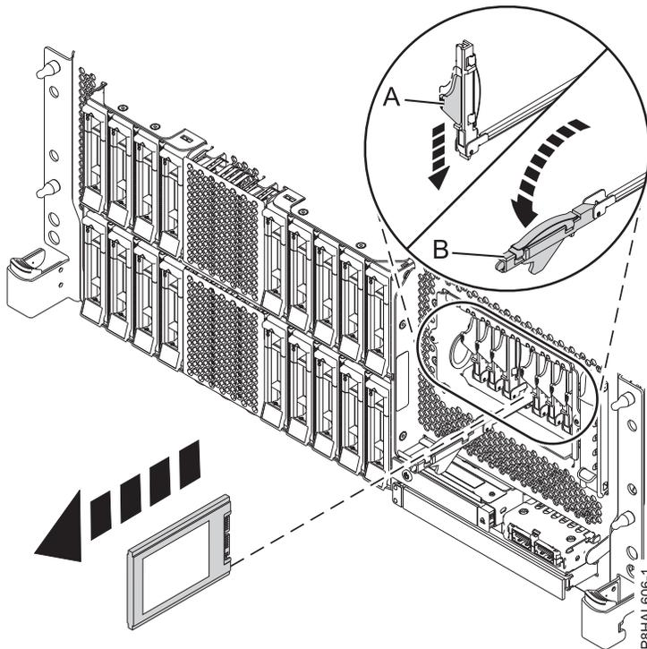
Abbildung 61. Solid-State-Laufwerk in einem Einschubsystem mit erweiterten Funktionen ausbauen
