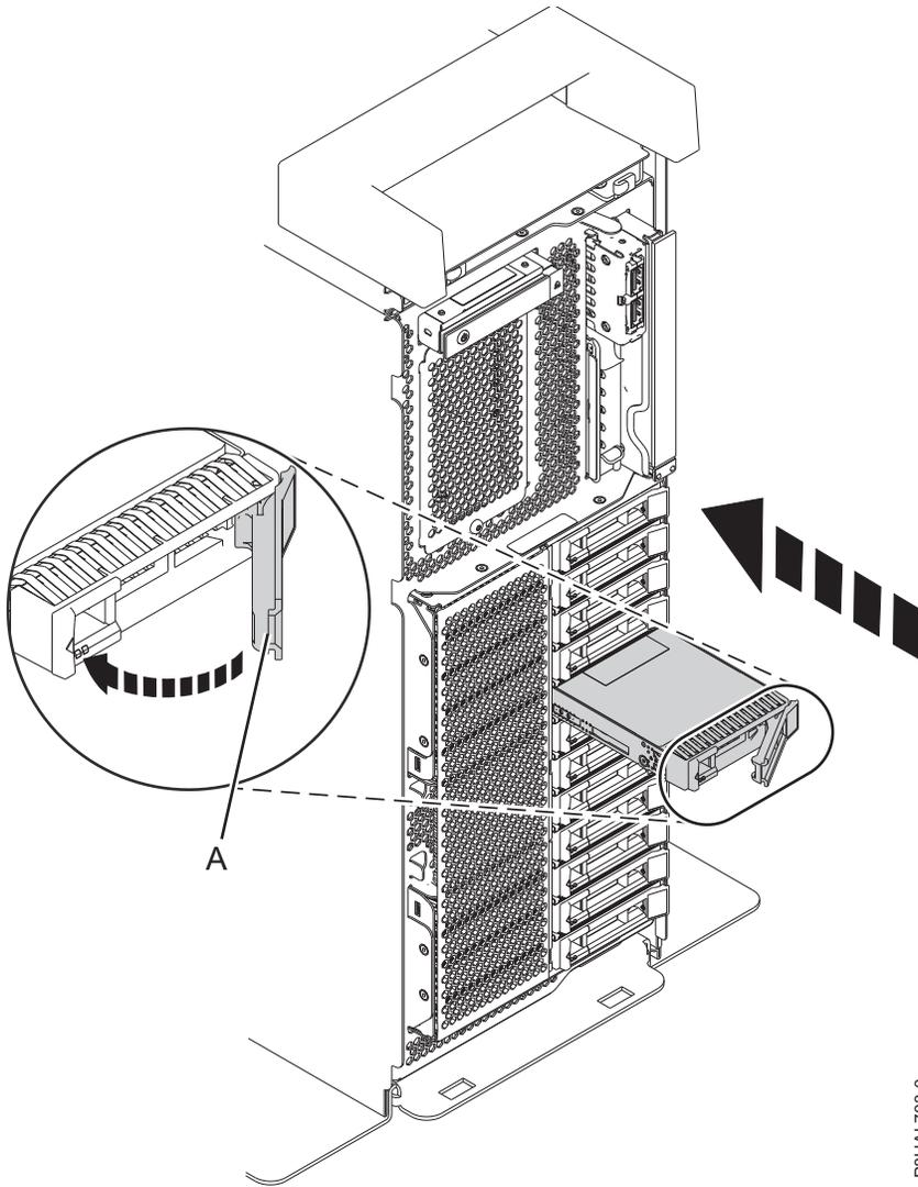
Abbildung 23. Plattenlaufwerk in einem Standalone-System mit Basisfunktionen installieren
