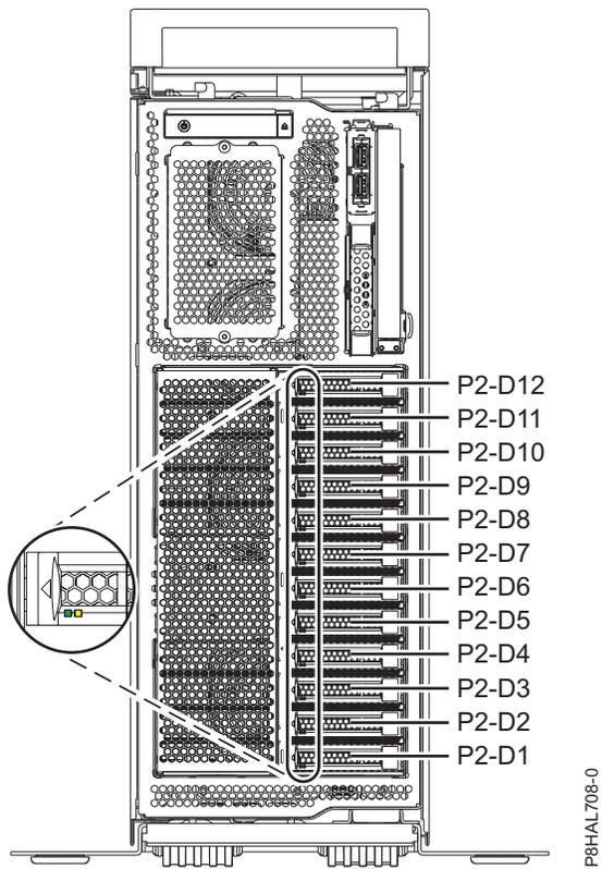
Abbildung 71. Positionen der Plattenlaufwerke oder Solid-State-Laufwerke und Serviceindikatoren in einem Standalone-System vom Typ 8286-41A mit Basisfunktionen
