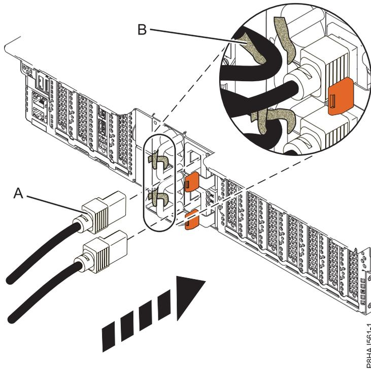
Abbildung 166. Netzkabel an ein System vom Typ 5148-21L, 5148-22L, 8247-21L, 8247-22L, 8284-21A oder 8284-22A anschließen
