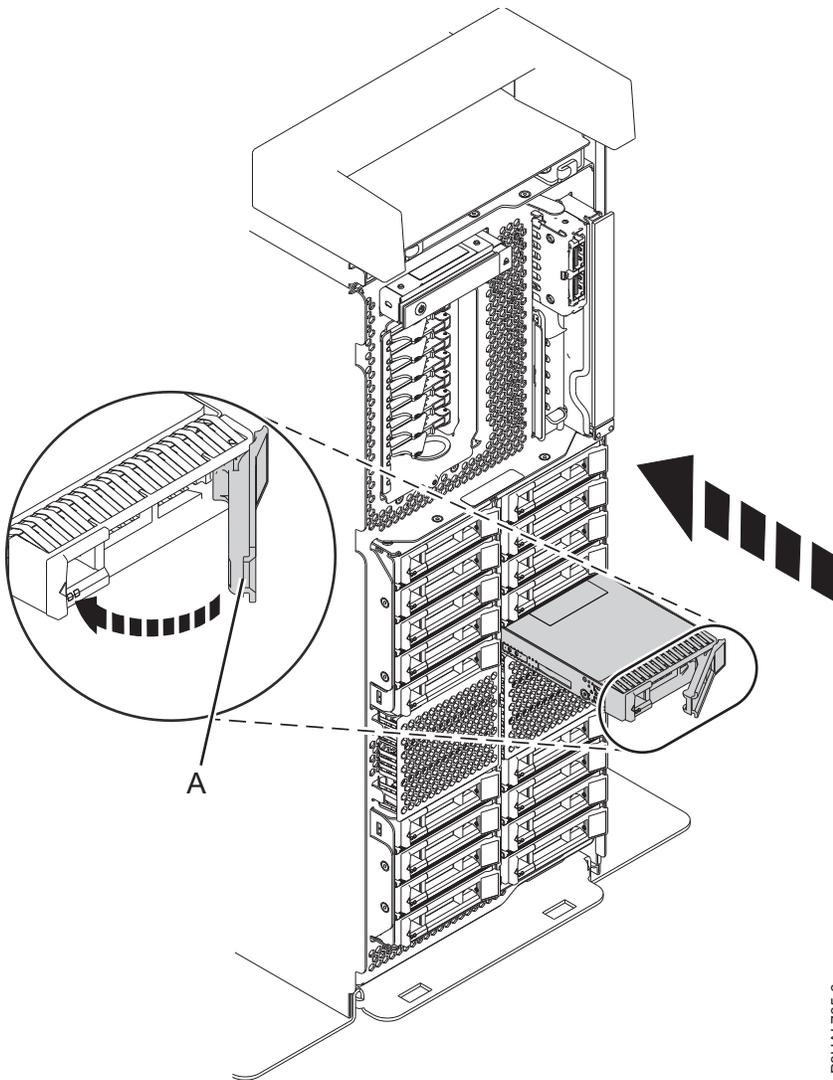
Abbildung 110. Plattenlaufwerk in einem Standalone-System mit erweiterten Funktionen austauschen
