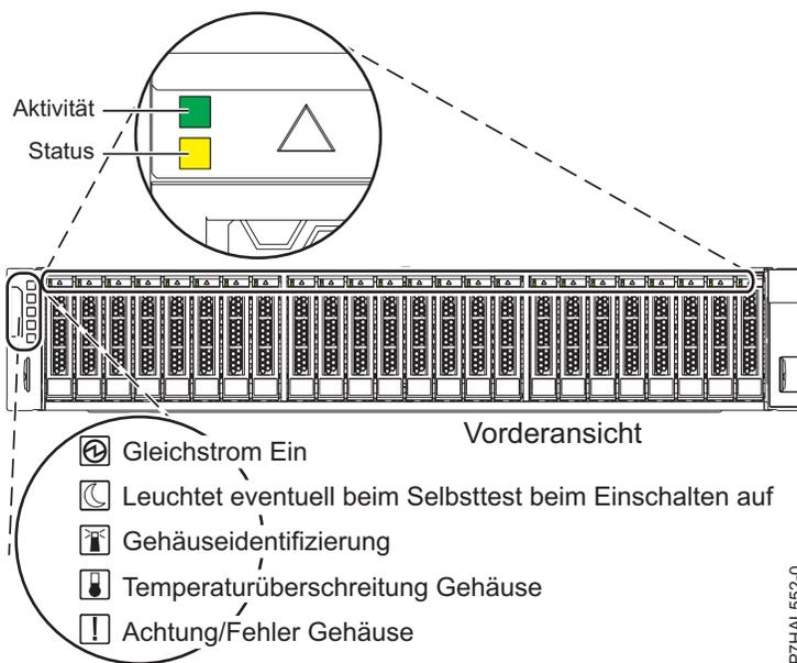
Abbildung 147. Vorderansicht des Plattenlaufwerkgehäuses 5887 mit den Serviceindikatoren
