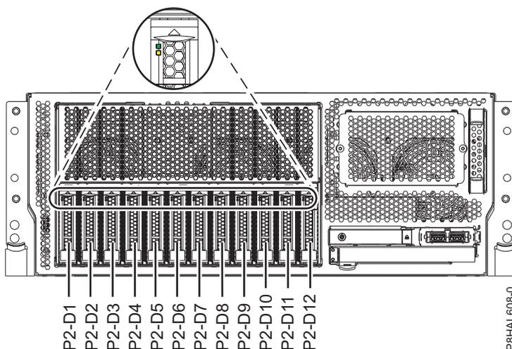
Abbildung 69. Positionen der Plattenlaufwerke oder Solid-State-Laufwerke und Serviceindikatoren in einem Einschubsystem vom Typ 8247-42L, 8286-41A oder 8286-42A mit Basisfunktionen
