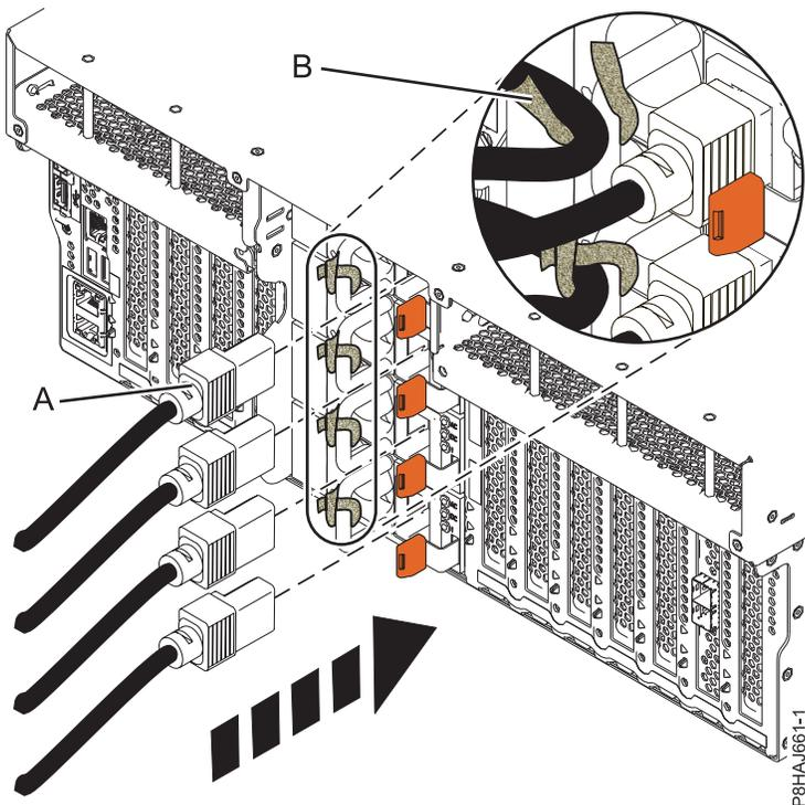
Abbildung 165. Netzkabel an ein System vom Typ 8247-42L, 8286-41A oder 8286-42A anschließen
