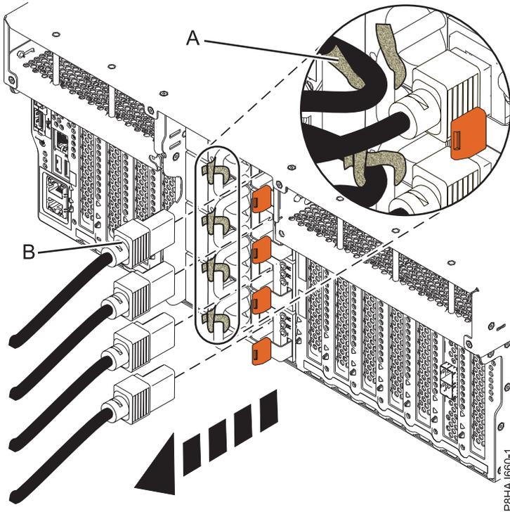
Abbildung 159. Netzkabel bei einem System vom Typ 8247-42L, 8286-41A oder 8286-42A abziehen
