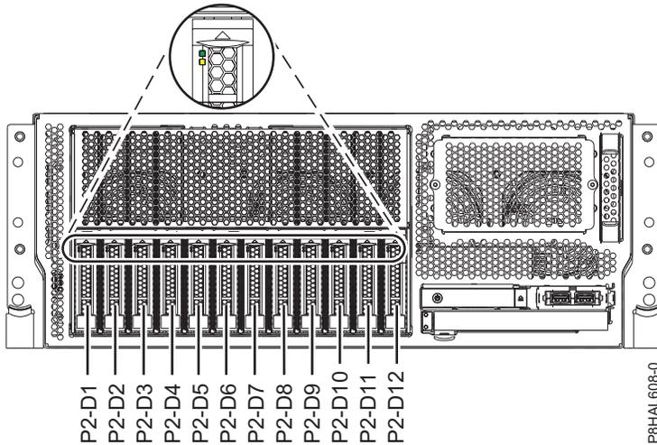
Abbildung 141. Positionen der Plattenlaufwerke oder Solid-State-Laufwerke und Serviceindikatoren in einem Einschubsystem vom Typ 8247-42L, 8286-41A oder 8286-42A mit Basisfunktionen
