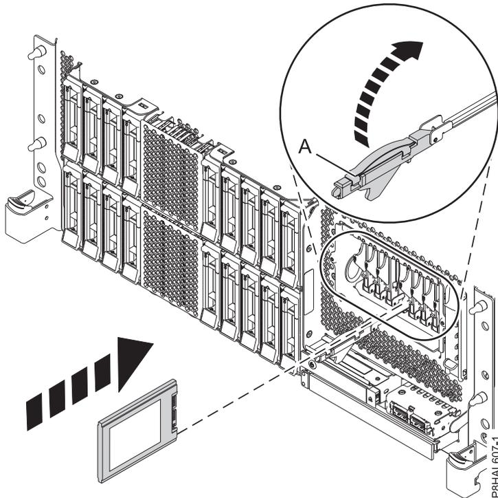
Abbildung 97. Solid-State-Laufwerk in einem Einschubsystem mit erweiterten Funktionen austauschen
