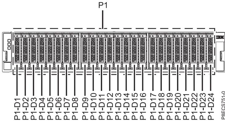
Abbildung 149. Vorderansicht der ESLS-Speichereinheit mit den Positionen der Plattenlaufwerke
