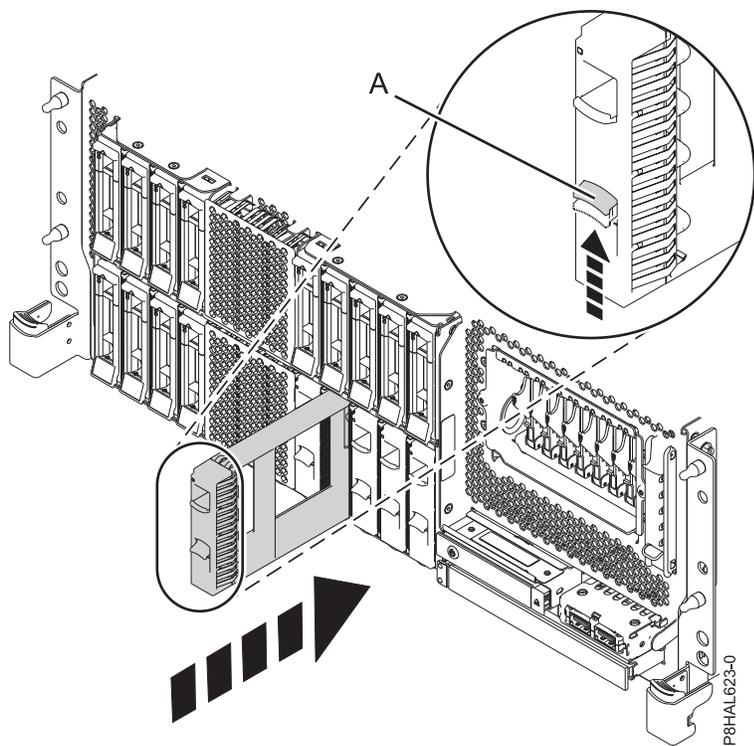
Abbildung 138. Plattenlaufwerk-Platzhalterelement installieren - Einschubsystem mit erweiterten Funktionen
