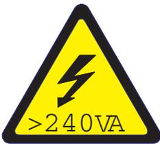
**Vorsicht:** Gefährliche Energie. Spannungen mit gefährlicher Energie können bei einem Kurzschluss mit Metall dieses so erhitzen, dass es schmilzt und/oder spritzt und somit Verbrennungen und/oder einen Brand verursachen könnte. (L005)
