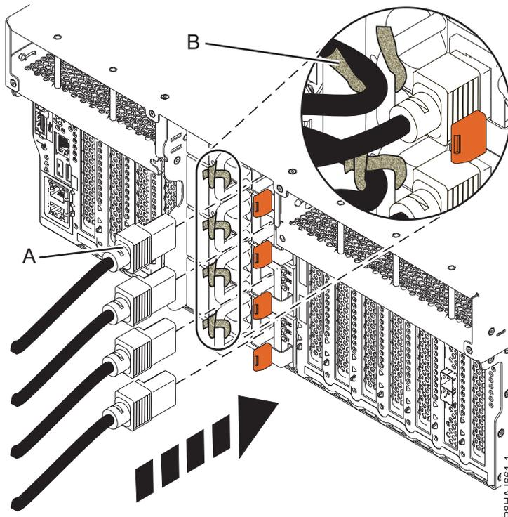
Abbildung 31. Netzkabel an ein System vom Typ 8247-42L, 8286-41A oder 8286-42A anschließen
