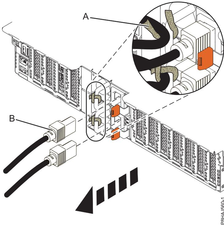
Abbildung 28. Netzkabel bei einem System vom Typ 8247-21L, 8247-22L oder 8284-22A abziehen
