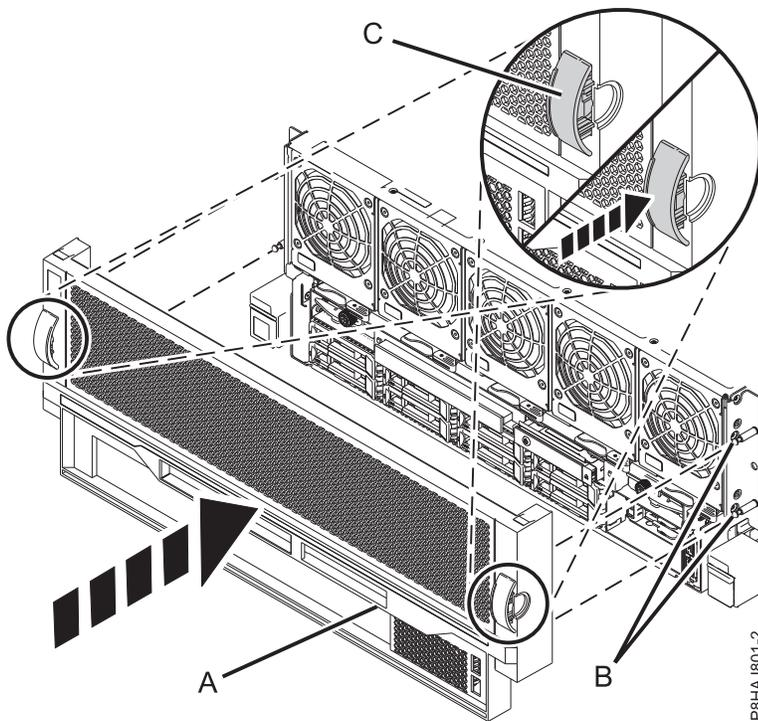
Abbildung 8. Vordere Abdeckung installieren
