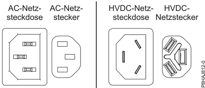
Abbildung 17. AC- und HVDC-Anschlüsse
