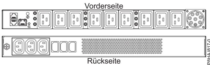
Abbildung 19. PDU beim System vom Typ 8408-44E
