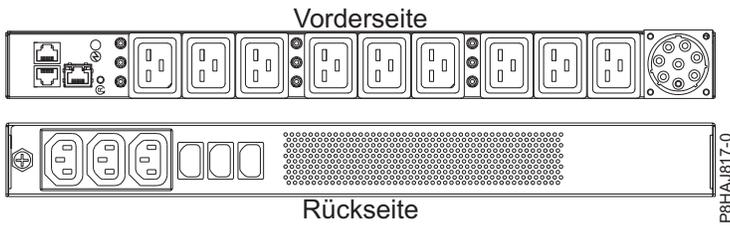
Abbildung 25. PDU beim System vom Typ 8408-44E
