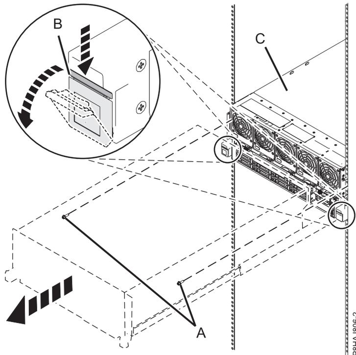
Abbildung 15. System in Serviceposition bringen
