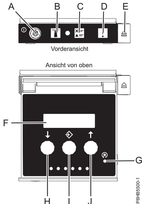
Abbildung 6. Steuerkonsole
