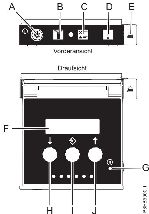
Abbildung 11. Steuerkonsole
