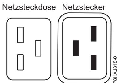
Abbildung 39. Anschlüsse beim System vom Typ 8408-44E
