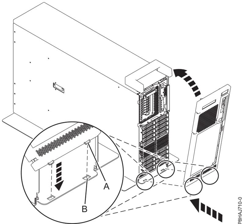
Abbildung 22. Vordere Abdeckung installieren
