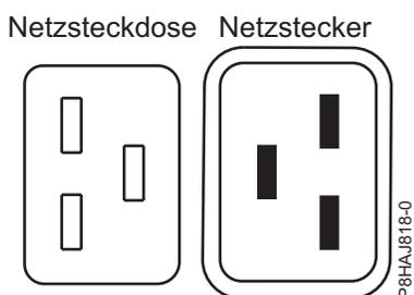
Abbildung 40. Anschlüsse beim System vom Typ 8408-44E
