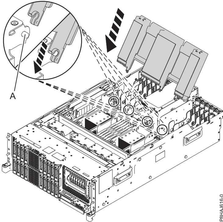
Abbildung 48. Luftführung installieren
