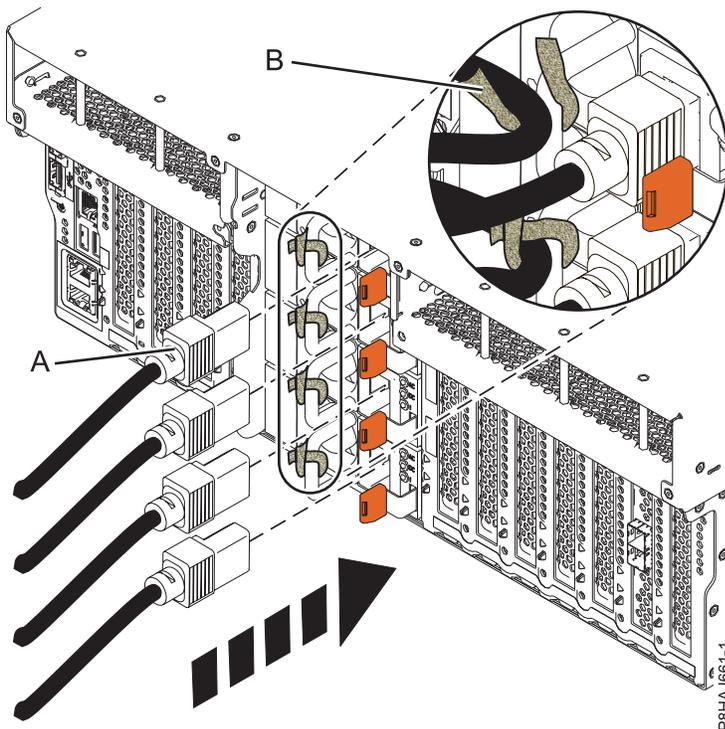
Abbildung 61. Netzkabel an ein System vom Typ 8247-42L, 8286-41A oder 8286-42A anschließen
