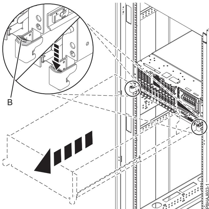
Abbildung 50. Seitliche Verriegelungen entriegeln
