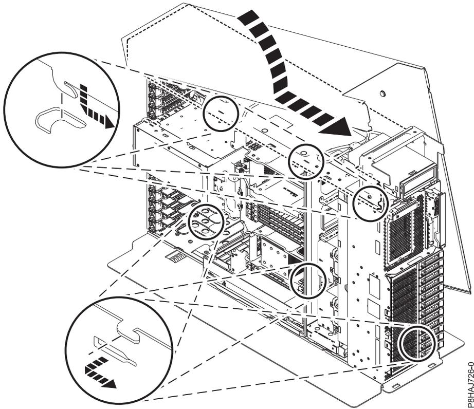
Abbildung 39. Installieren der Seitenabdeckung bei einem Standalone-System vom Typ 8286-41A
