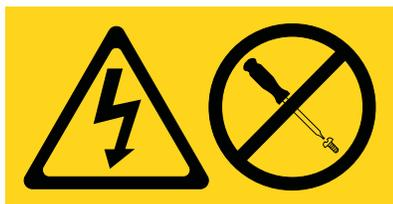
**Gefahr:** In Komponenten, die diesen Aufkleber aufweisen, treten gefährliche Spannungen, Ströme oder Energien auf. Keine Abdeckungen oder Sperren öffnen, die diesen Aufkleber aufweisen. (L001)
