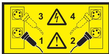
**Gefahr:** Mehrere Netzkabel. Dieses Produkt kann mit mehreren Netzkabeln ausgestattet sein. Alle Netzkabel abziehen, um gefährliche Spannungen zu verhindern.(L003)
