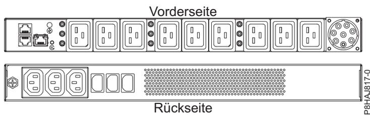
Abbildung 36. PDU beim System vom Typ 8408-44E
