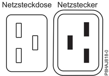
Abbildung 41. Anschlüsse beim System vom Typ 8408-44E
