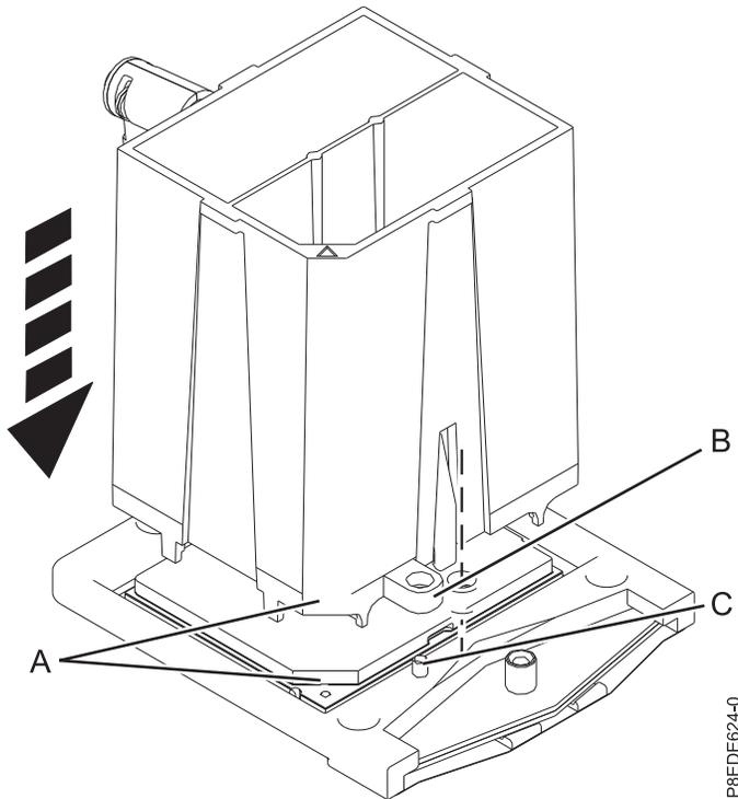
Abbildung 8. Ausbauwerkzeug auf das Systemprozessormodul herabsenken
