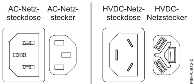
Abbildung 34. AC- und HVDC-Anschlüsse
