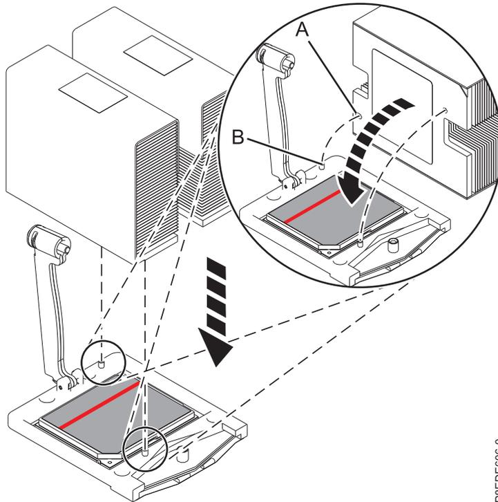
Abbildung 19. Kühlblech installieren
