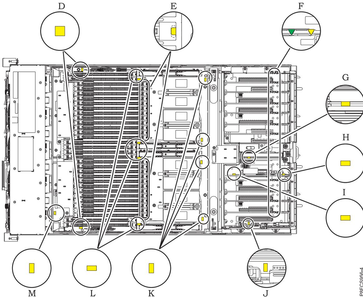
Abbildung 3. Serviceanzeigen-LEDs
