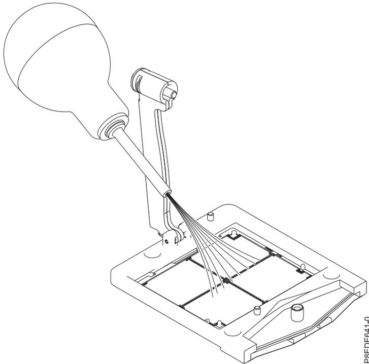
Abbildung 15. Staub und Fremdkörper vom Systemprozessorsocket entfernen
