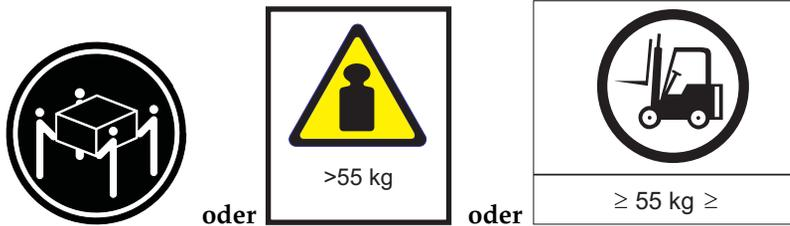
Dieses Teil oder diese Einheit wiegt über 55 kg. Zum Anheben dieses Teils oder dieser Einheit ist ausgebildetes Fachpersonal und/oder eine Hebevorrichtung erforderlich. (C011)
