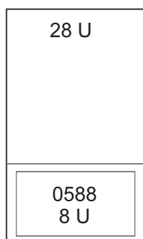
Slika 87. Koda možnosti 0588 - razširitvena enota PCI-X v omari
