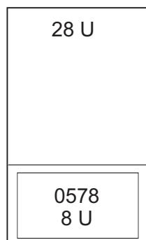
Slika 86. Koda možnosti 0578 - razširitvena enota PCI-X v omari
