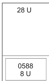
Slika 13. Koda možnosti 0588 - razširitvena enota PCI-X v omari
