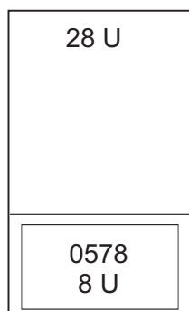
Slika 12. Koda možnosti 0578 - razširitvena enota PCI-X v omari
