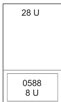
Slika 13. Koda možnosti 0588 - razširitvena enota PCI-X v omari
