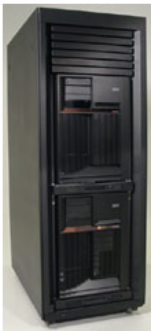
Slika 14. Sistemske enote omare 0551, model 9406-270
