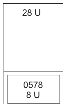
Slika 12. Koda možnosti 0578 - razširitvena enota PCI-X v omari
