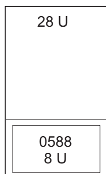
Slika 14. Koda možnosti 0588 - razširitvena enota PCI-X v omari
