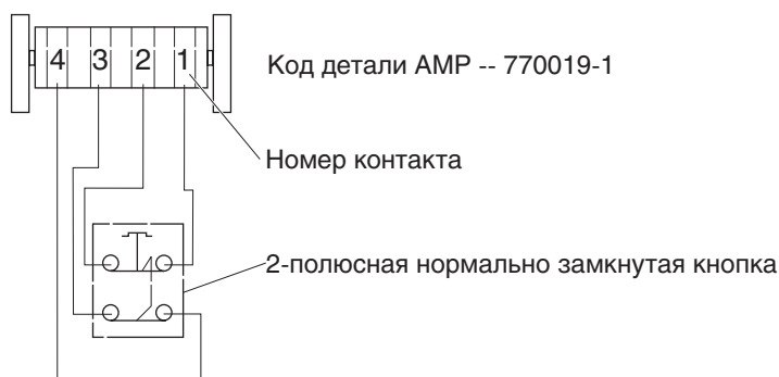
Схема выключателя UEPO
