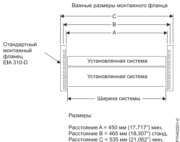
Рисунок 248. Критически важные размеры монтажных фланцев
