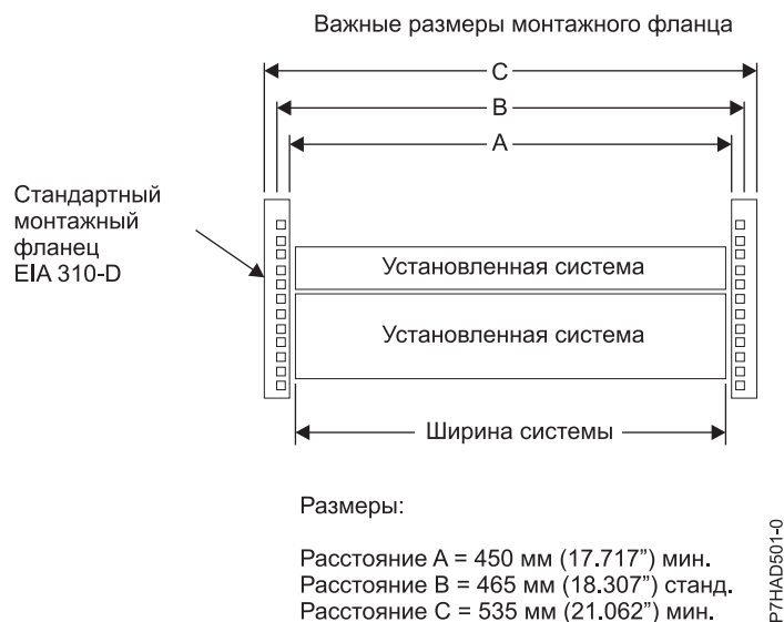
Рисунок 179. Критически важные размеры монтажных фланцев
