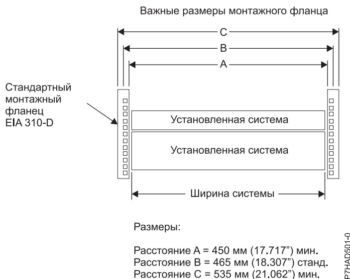
Рисунок 34. Критически важные размеры монтажных фланцев
