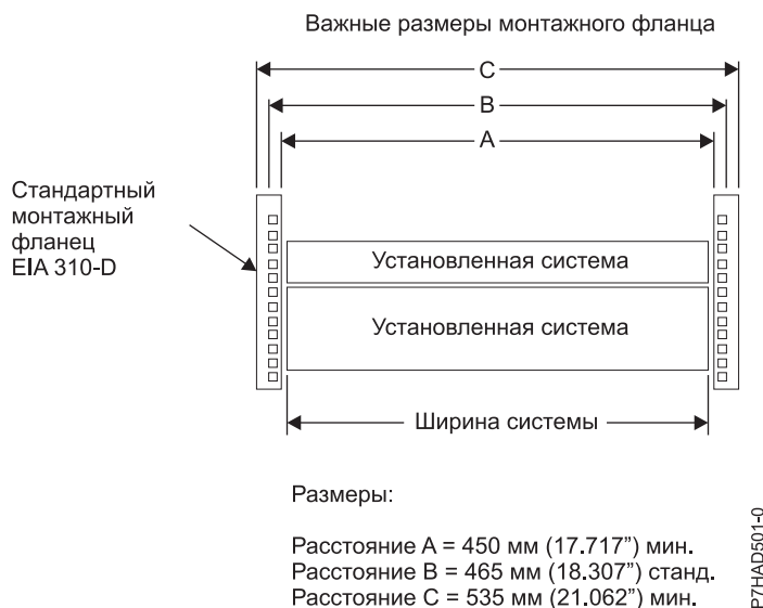
Рисунок 30. Критически важные размеры монтажных фланцев
