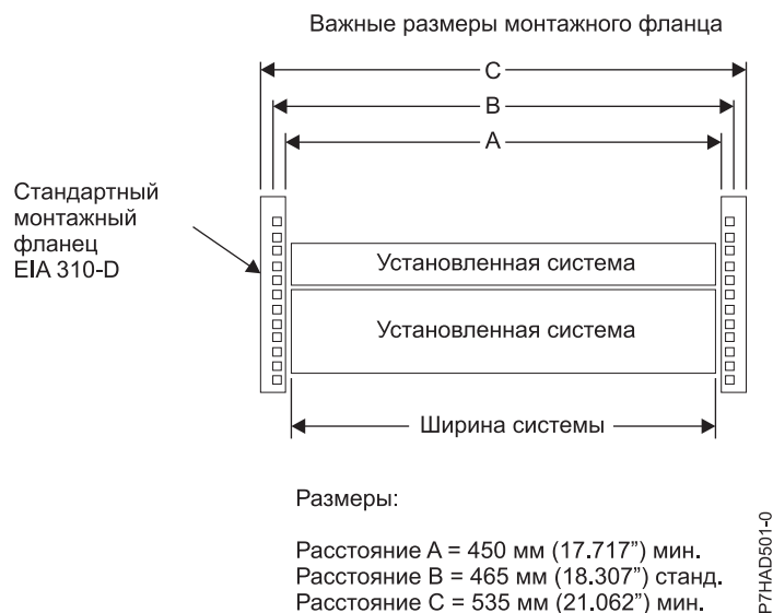
Рисунок 175. Критически важные размеры монтажных фланцев
