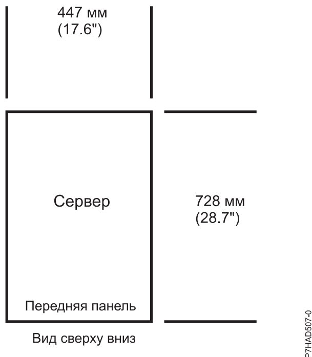
Рисунок 1. Схема расположения модели 8246-L1C, 8246-L1D, 8246-L1S, 8246-L1T, 8246-L2C, 8246-L2D, 8246-L2S и 8246-L2T (сервер, устанавливаемый в стойку)
