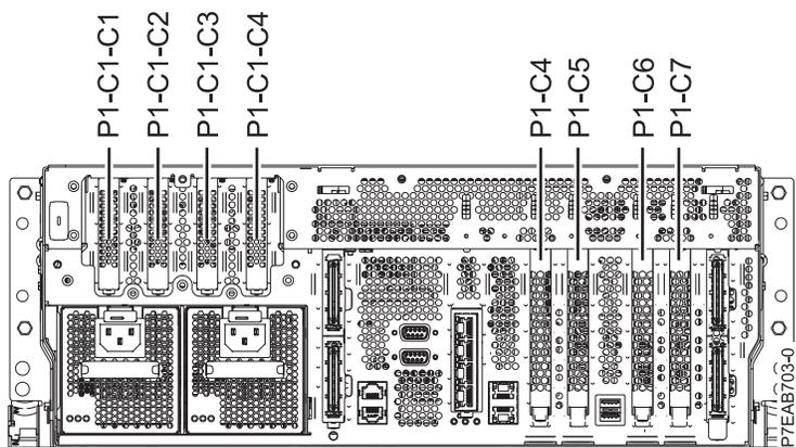
Рисунок 1. 8202-E4B и 8205-E6B - вид сзади с кодами расположений разъемов PCI
