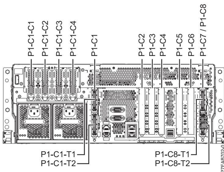
Рисунок 4. Вид системы сзади, показывающий разъемы PCI и их коды расположения
