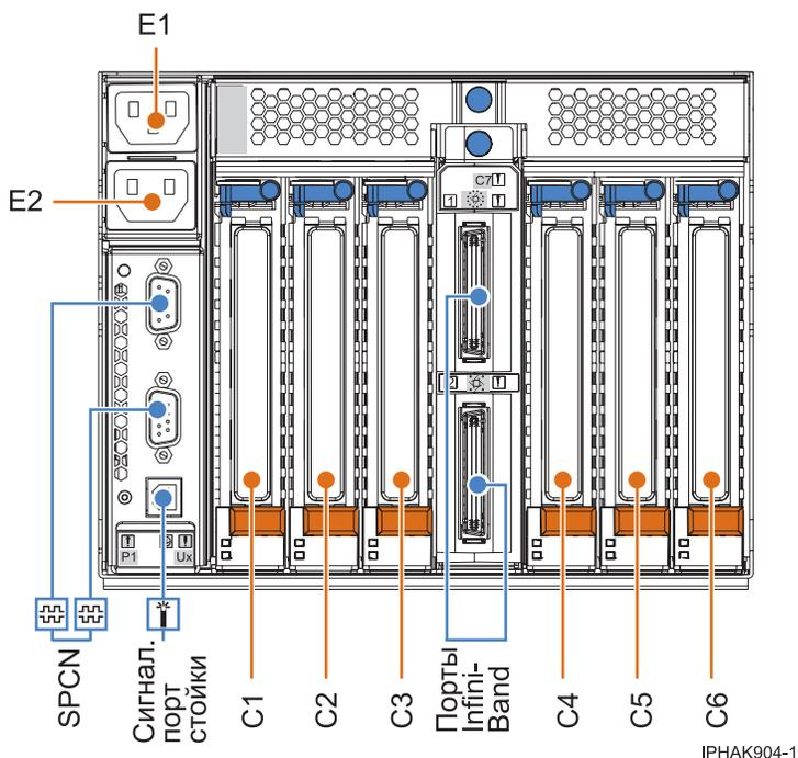
Рисунок 5. Вид сзади
