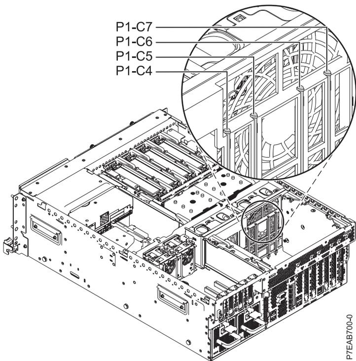
Рисунок 2. Коды расположений разъемов PCI в системах 8202-E4B и 8205-E6B
