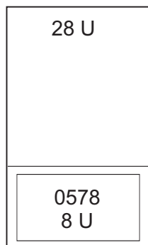
Figura 13. Cod caracteristică 0578 - unitate de expansiune PCI-X în dulap
