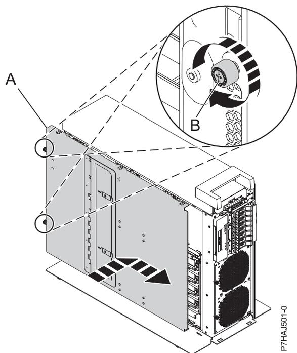
Figura 24. Instalando a Tampa Interna de Acesso de Serviço
