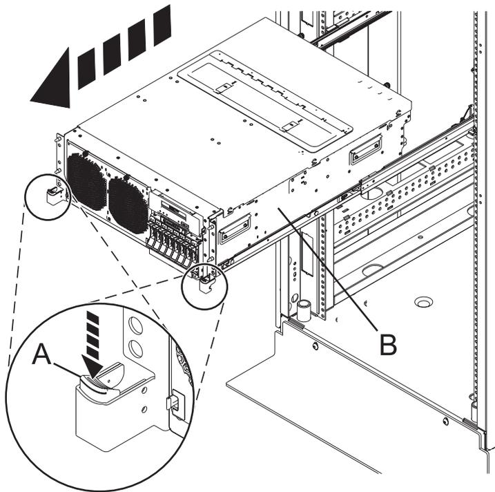
Figura 27. Travando a Unidade de Sistema na Posição de Serviço
