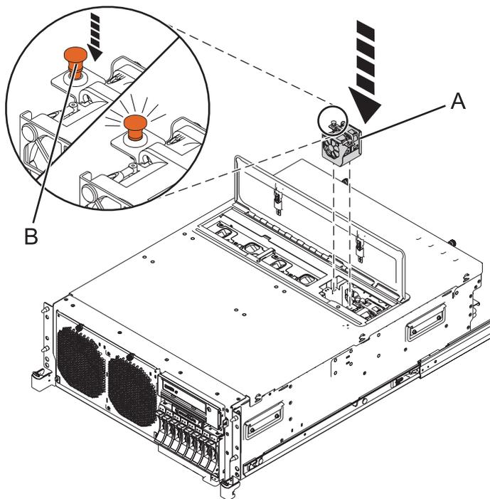
Figura 12. Instalando um Ventilador no 8202-E4B, 8202-E4C, 8202-E4D, 8205-E6B, 8205-E6C ou 8205-E6D
