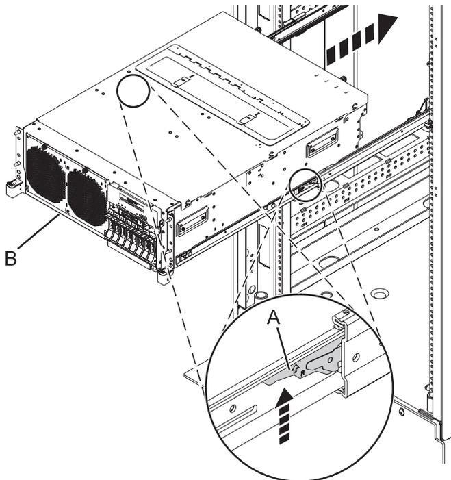
Figura 28. Colocando a Unidade de Sistema na Posição de Operação
