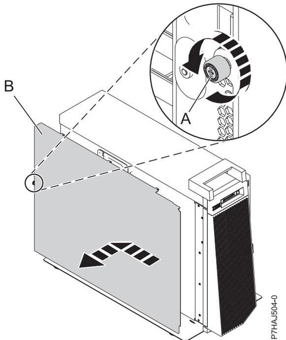
Figura 7. Removendo a Tampa de Acesso de Serviço Externa
