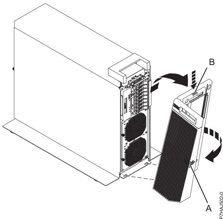
Figura 16. Removendo a Tampa Frontal
