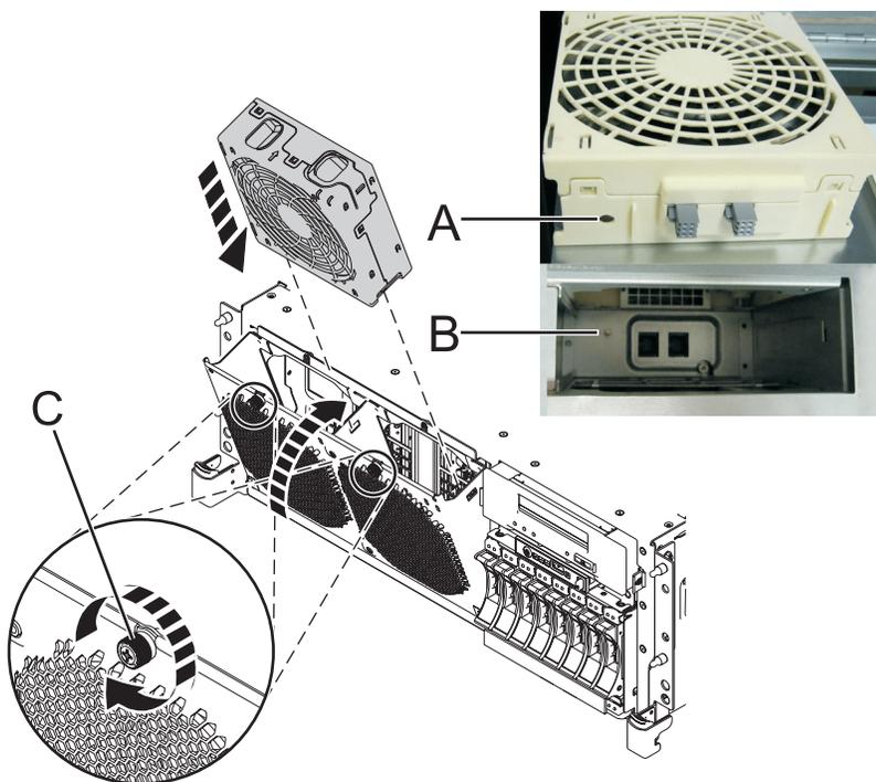
Figura 2. Substituindo o Ventilador em um Modelo Montado em Rack para o 8202-E4B, 8202-E4C, 8202-E4D, 8205-E6B, 8205-E6C ou 8205-E6D
