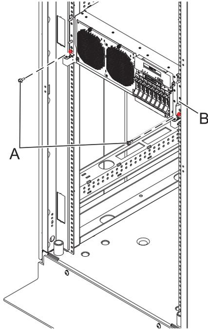
Figura 29. Colocando a Unidade de Sistema na Posição de Operação
