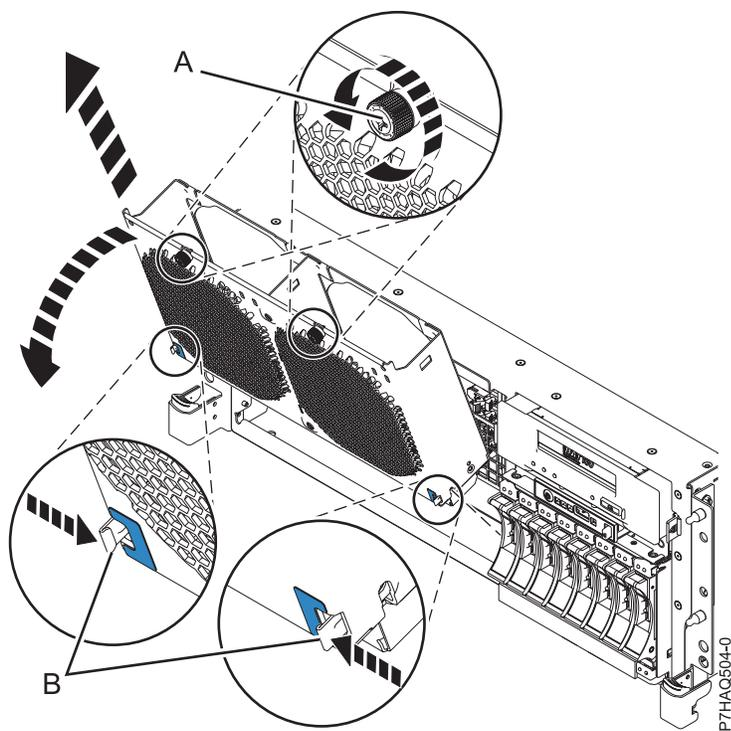
Figura 4. Removendo o Compartimento do Ventilador
