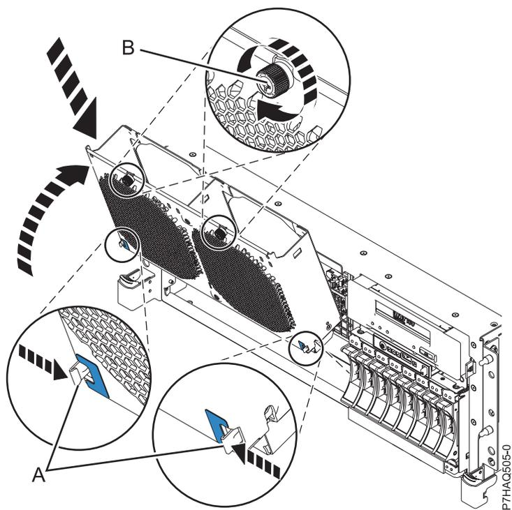
Figura 5. Substituindo o Compartimento do Ventilador do 8202-E4B, 8202-E4C, 8202-E4D, 8205-E6B, 8205-E6C ou 8205-E6D
