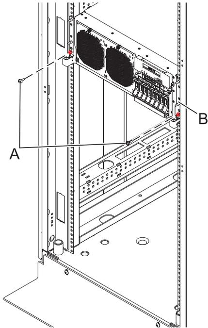
Figura 26. Colocando a Unidade de Sistema na Posição de Serviço
