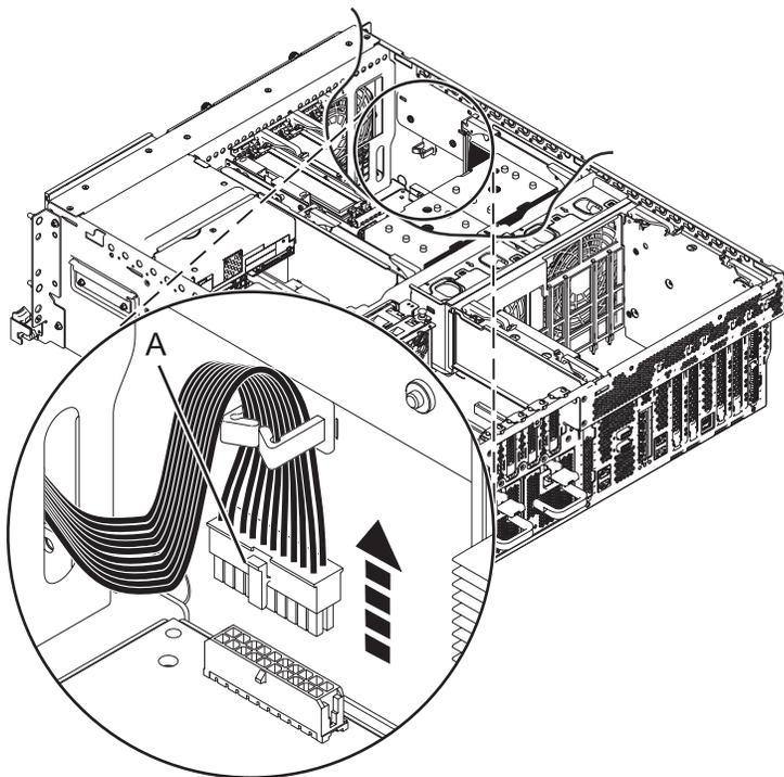
Figura 3. Removendo o Cabo do Ventilador
