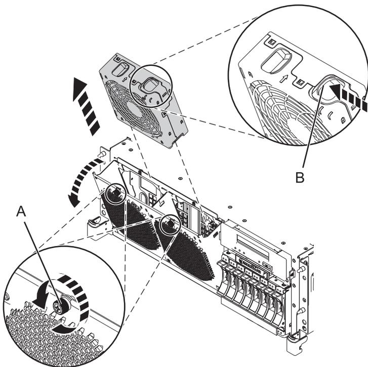
Figura 1. Removendo um Ventilador do 8202-E4B, 8202-E4C, 8202-E4D, 8205-E6B, 8205-E6C ou 8205-E6D
