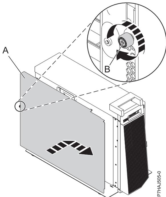
Figura 25. Instalando a Tampa Externa de Acesso de Serviço
