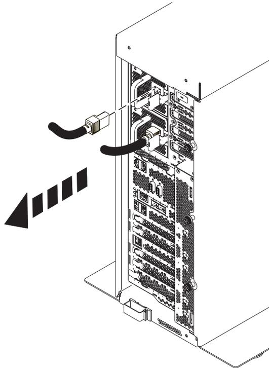
Figura 31. Removendo os Cabos de Energia de um Sistema Independente
