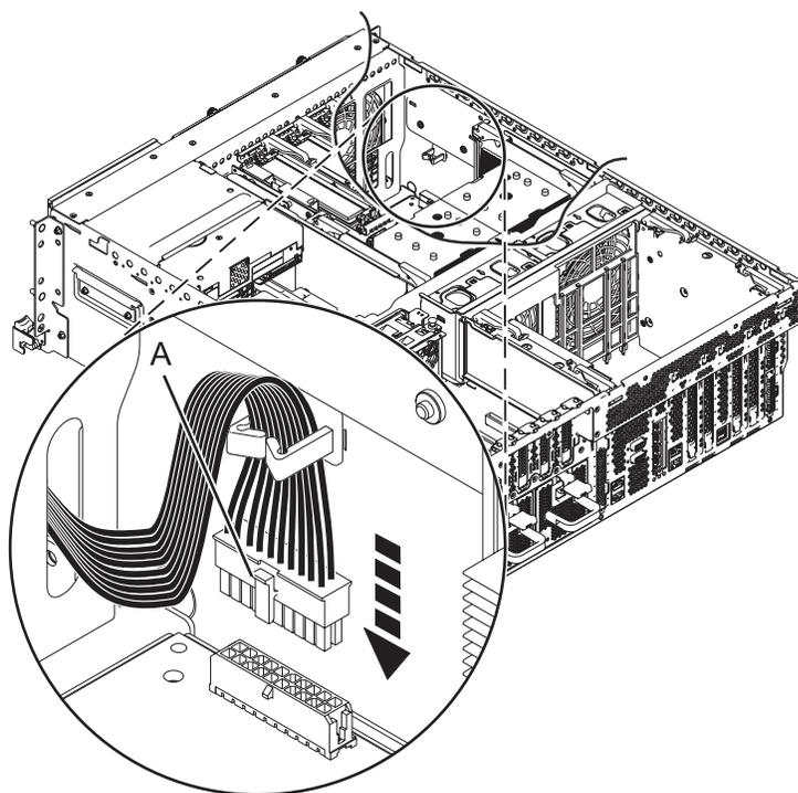
Figura 6. Substituindo o Cabo do Ventilador
