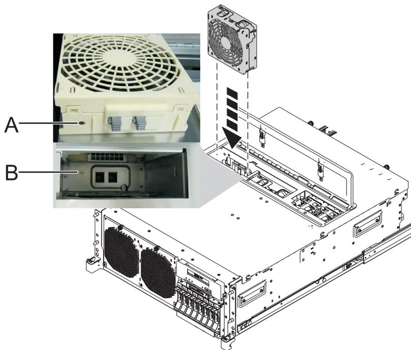
Figura 11. Instalando um Ventilador no 8202-E4B, 8202-E4C, 8202-E4D, 8205-E6B, 8205-E6C ou 8205-E6D
