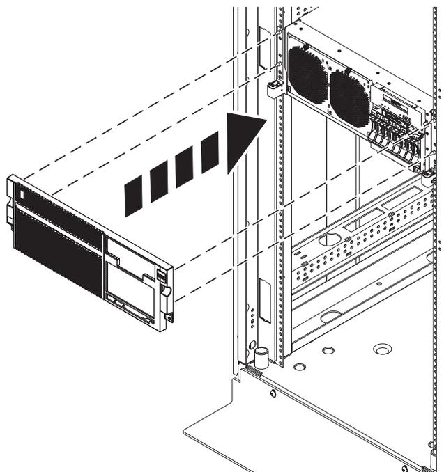
Figura 17. Removendo a Tampa Frontal
