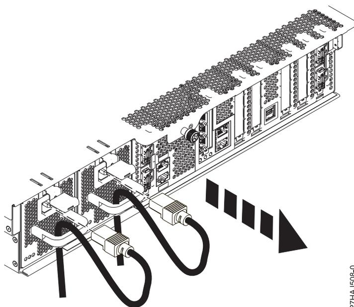
Figura 20. Removendo os Cabos de Energia
