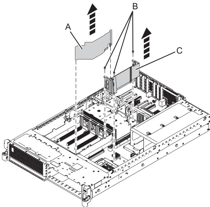
Figura 8. Removendo o Guia do Regulador de Voltagem e a Divisória de Ar (8231-E1C, 8231-E1D, 8231-E2C, 8231-E2D ou 8268-E1D)
