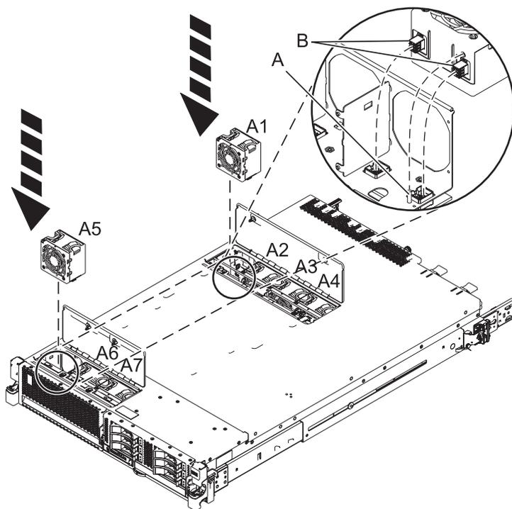
Figura 2. Substituindo o Ventilador em um Modelo Montado em Rack para o 8231-E2B, 8231-E1C, 8231-E1D, 8231-E2C, 8231-E2D ou 8268-E1D
