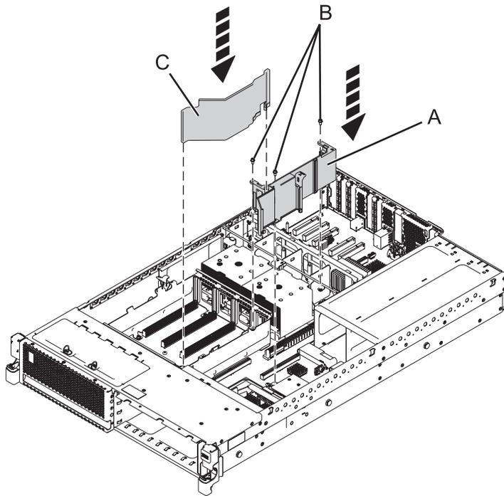
Figura 11. Substituindo o Divisor de Ar da Guia do Regulador de Voltagem (8231-E2B)
