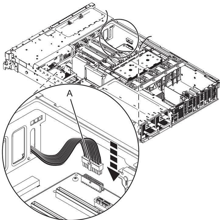
Figura 6. Conectando o cabo do ventilador
