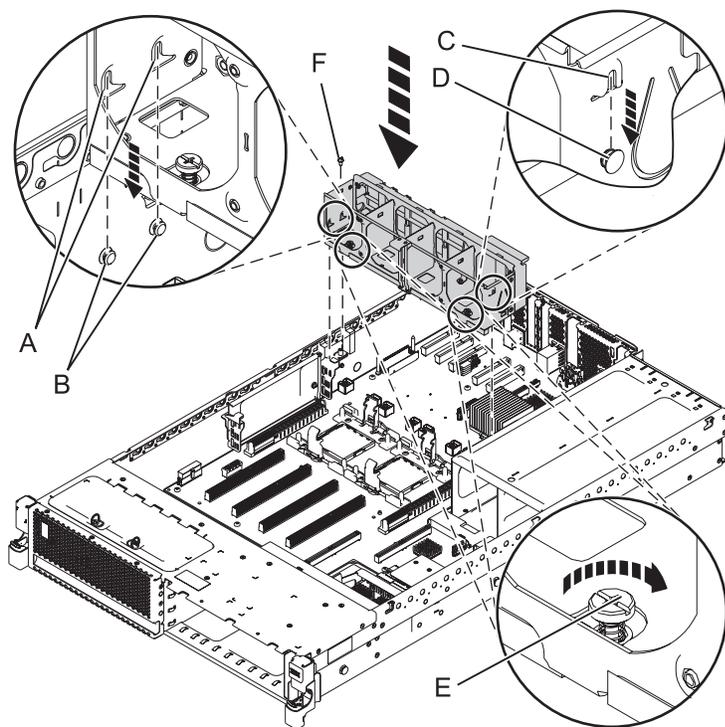
Figura 10. Substituindo o Compartimento do Ventilador Intermediário para o Sistema 8231-E2B, 8231-E1C, 8231-E1D, 8231-E2C, 8231-E2D ou 8268-E1D
