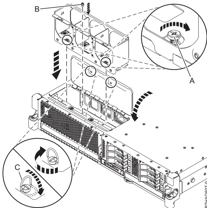
Figura 5. Substituindo o Compartimento do Ventilador Frontal para o Sistema 8231-E2B, 8231-E1C, 8231-E1D, 8231-E2C, 8231-E2D ou 8268-E1D
