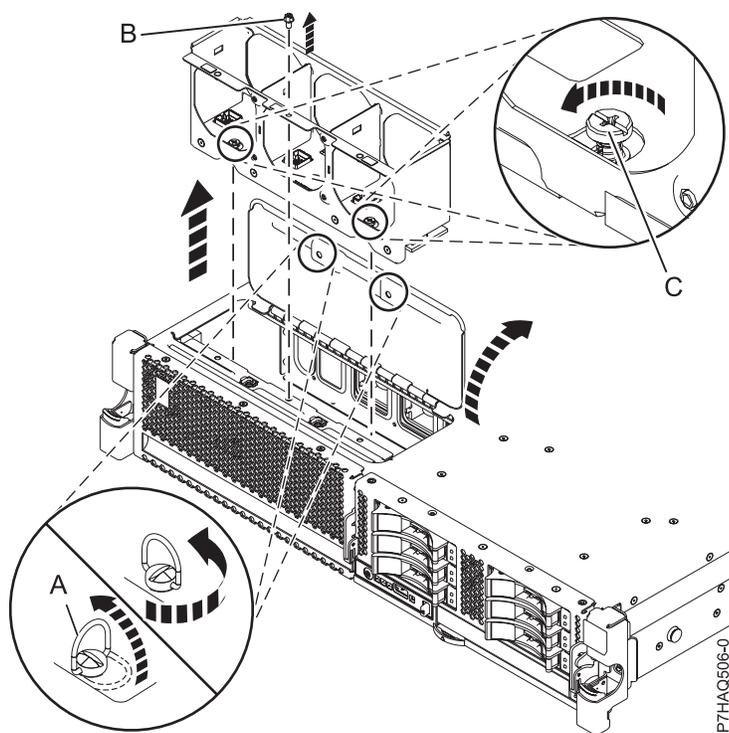
Figura 4. Removendo o Compartimento do Ventilador
