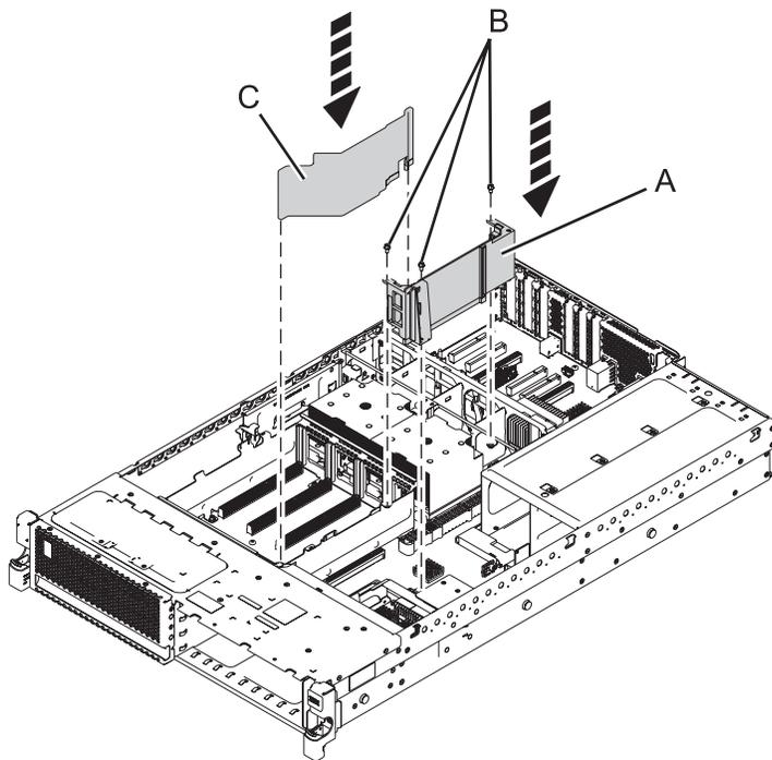
Figura 12. Substituindo a Divisória de Ar do Guia do Regulador de Voltagem (8231-E1C, 8231-E1D, 8231-E2C, 8231-E2D ou 8268-E1D)
