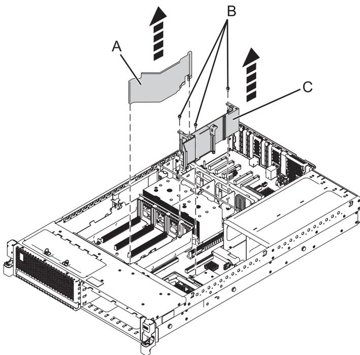
Figura 7. Removendo a Guia do Regulador de Voltagem e a Divisória de Ar (8231-E2B)
