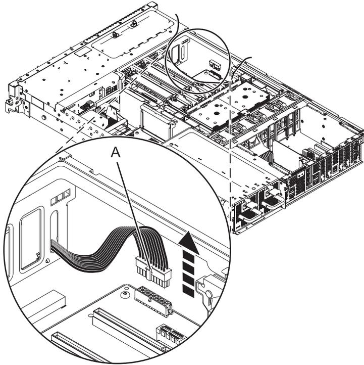
Figura 3. Removendo o Cabo do Ventilador
