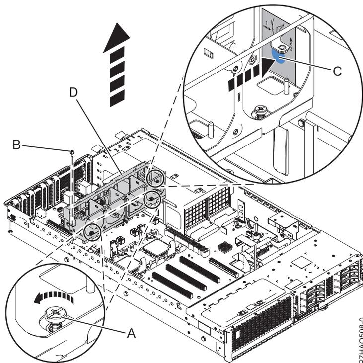
Figura 9. Remoção do compartimento do ventilador
