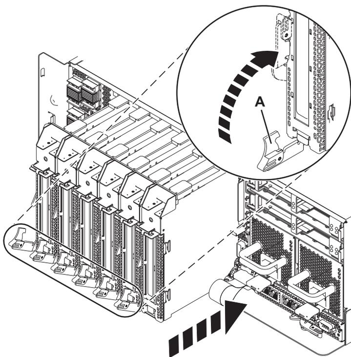
Figura 14. Cassete do adaptador PCI removido da unidade de sistema
