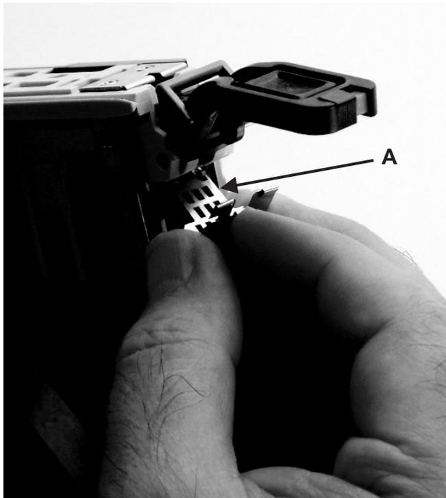
Instale a blindagem EMC metálica (A) na parte superior do suporte sobre trilhos.
