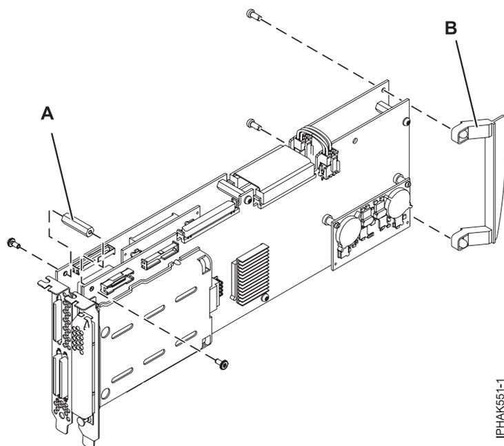
Figura 52. Removendo a alça do adaptador e o espaçador
