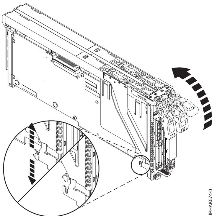
Figura 70. Desconectando o painel frontal
