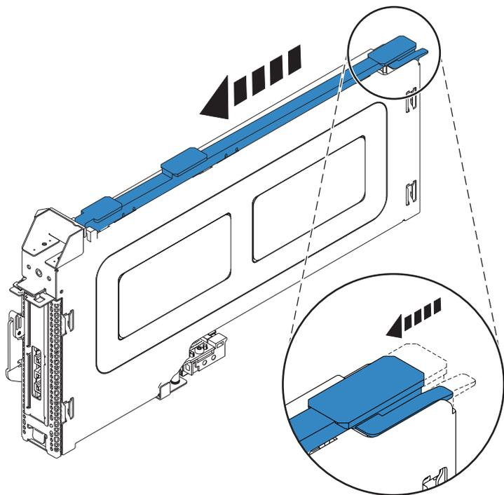
Figura 22. Trilho da guia do cassete do adaptador PCI travado
