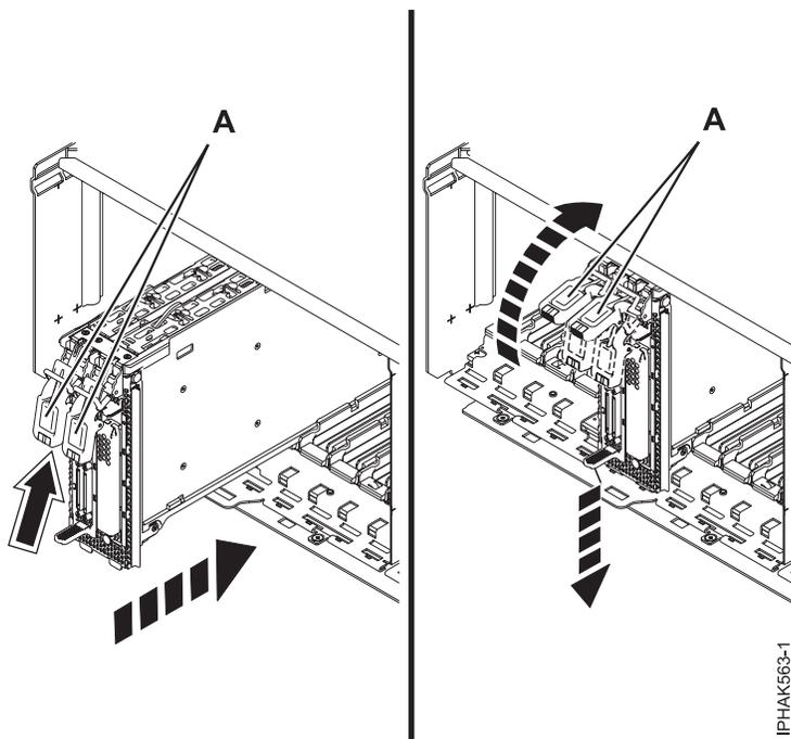
Figura 64. Instalando o conjunto do cassete na unidade de expansão de E/S
