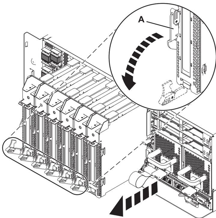
Figura 11. Cassete do adaptador PCI removido da unidade de sistema
