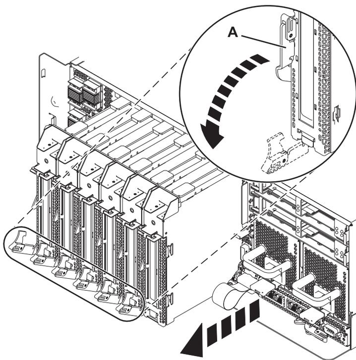
Figura 9. Cassete do adaptador PCI removido da unidade de sistema
