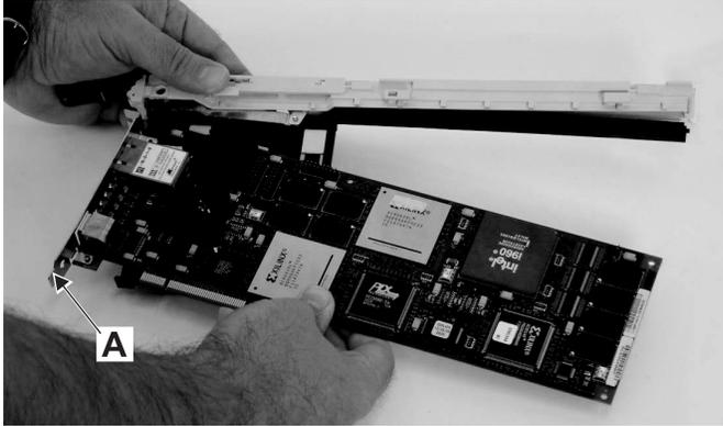
Remova o adaptador do conjunto de ligação do cassete, girando a parte inferior do suporte sobre trilhos A para fora, conforme mostrado na ilustração. Guarde o adaptador em local seguro.
