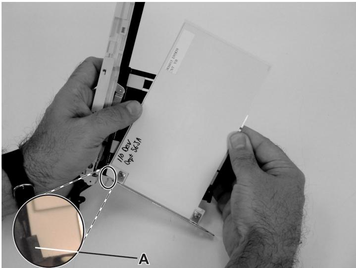
Remova o adaptador ou o preenchimento em branco do conjunto de ligação do cassete, girando a parte inferior do suporte sobre trilhos **A** para fora, conforme mostrado na ilustração. Guarde o adaptador ou o preenchimento em branco em um local seguro.
