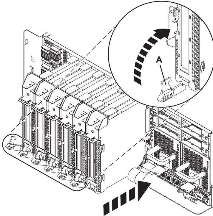
Figura 3. Cassete do adaptador PCI instalado na unidade de sistema
