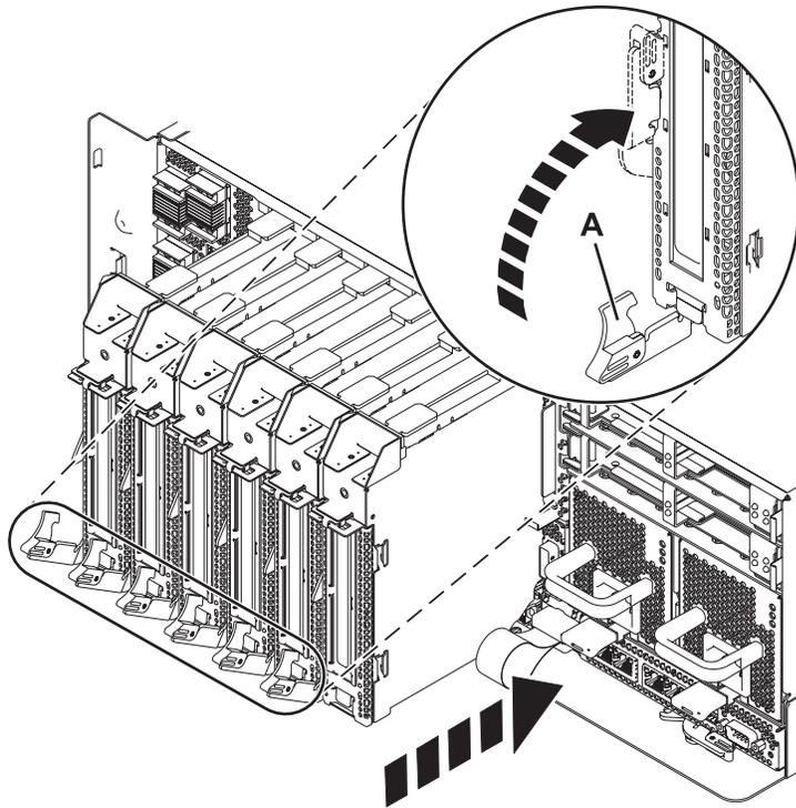
Figura 16. Cassete do adaptador PCI instalado na unidade de sistema
