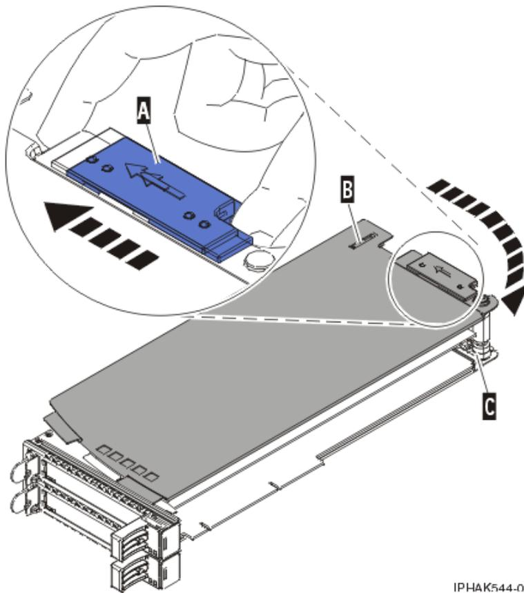
Figura 153. Tampa do cassete do adaptador PCI removida
