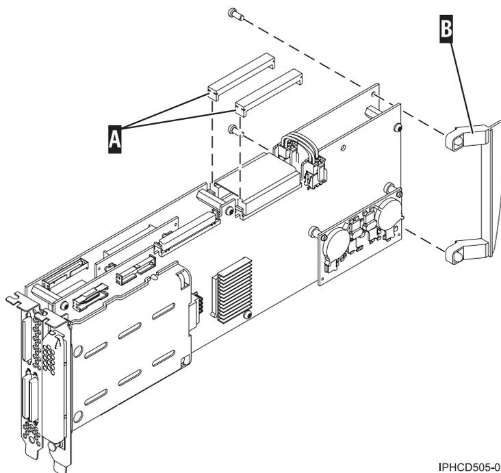
Figura 160. Preparando o adaptador para colocação em um cassete
