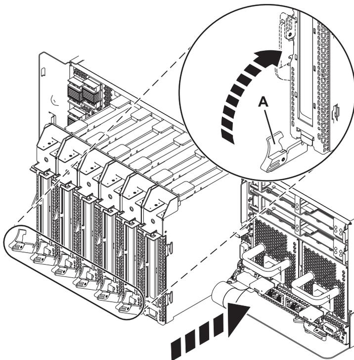
Figura 17. Cassete do adaptador PCI instalado na unidade de sistema
