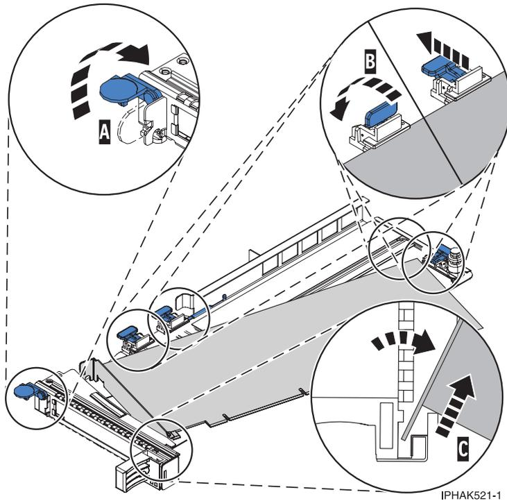
Figura 125. Adaptador removido do cassete do adaptador PCI
