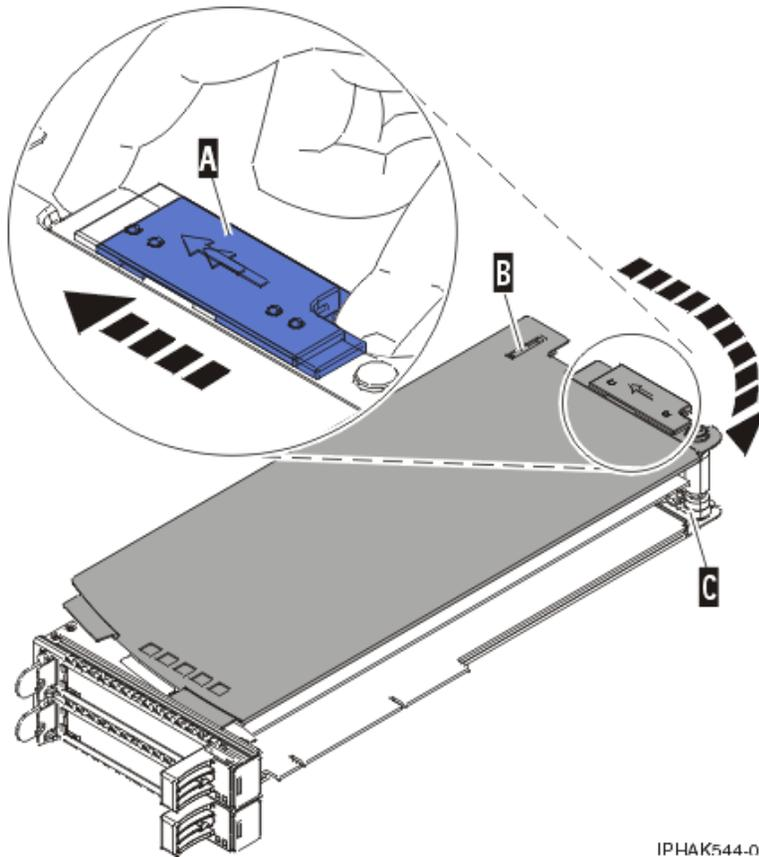
Figura 44. Tampa do cassete do adaptador PCI removida
