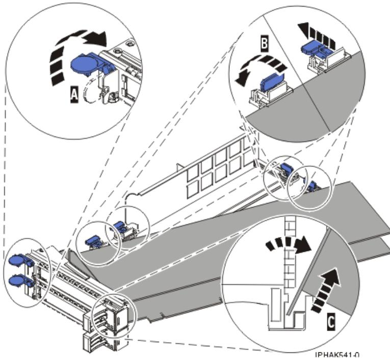
Figura 128. Adaptador removido do cassete do adaptador PCI
