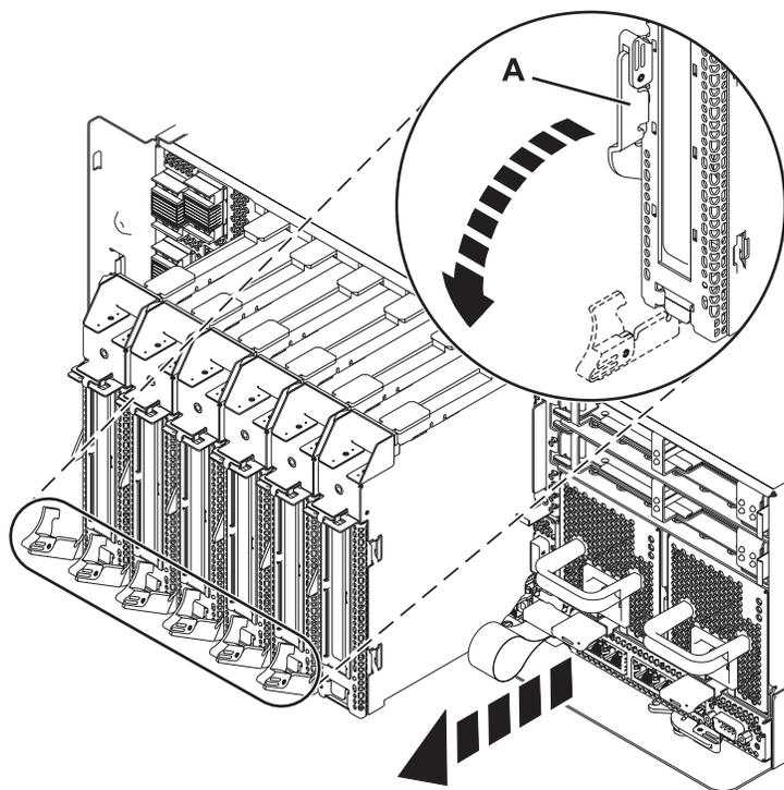
Figura 8. Cassete do adaptador PCI removido da unidade de sistema
