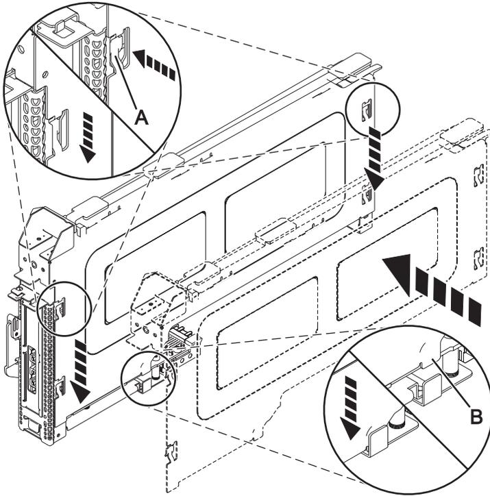
Figura 21. Tapa do cassete do adaptador PCI substituída
