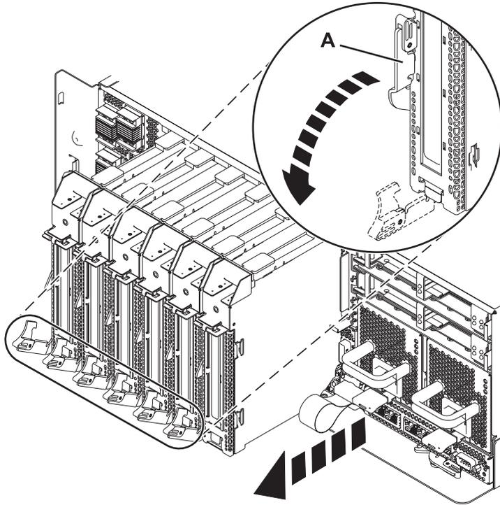
Figura 6. Cassete do adaptador PCI removido da unidade de sistema
