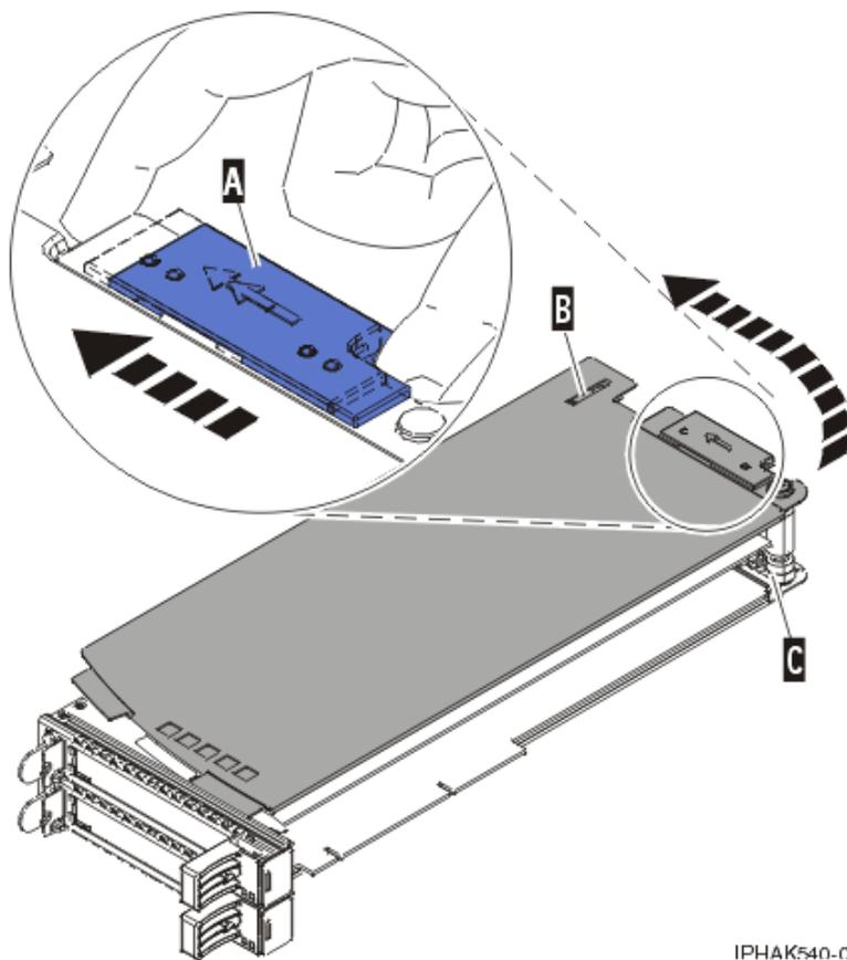
Figura 50. Tampa do cassete do adaptador PCI substituída
