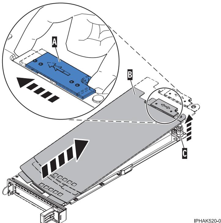
Figura 124. Tampa do cassete do adaptador PCI removida
