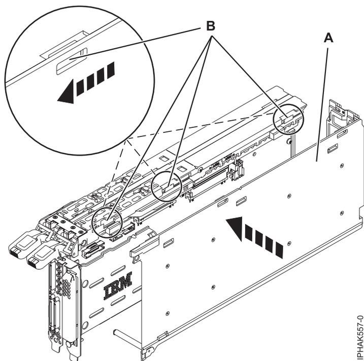
Figura 58. Instalando a tampa
