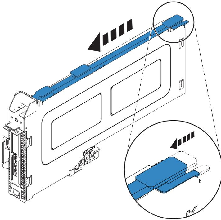
Figura 27. Trilho da guia do cassete do adaptador PCI travado
