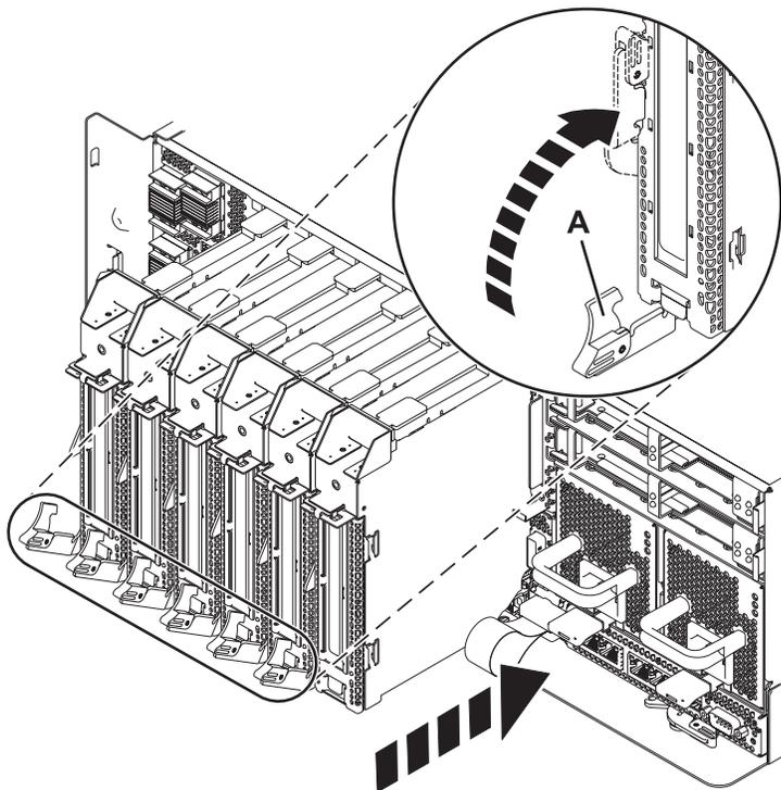
Figura 1. Cassete do adaptador PCI instalado na unidade de sistema
