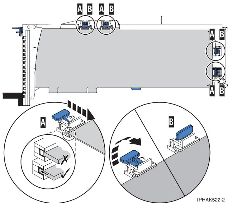
Figura 115. Adaptador grande no cassete do adaptador PCI com os suportes e o estabilizador no local
