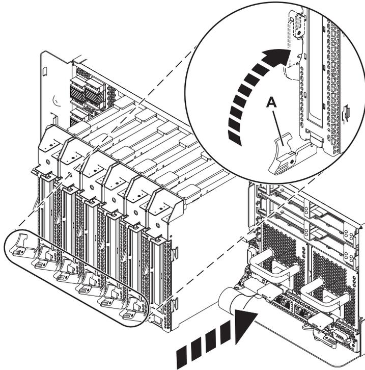
Figura 7. Cassete do adaptador PCI instalado na unidade de sistema
