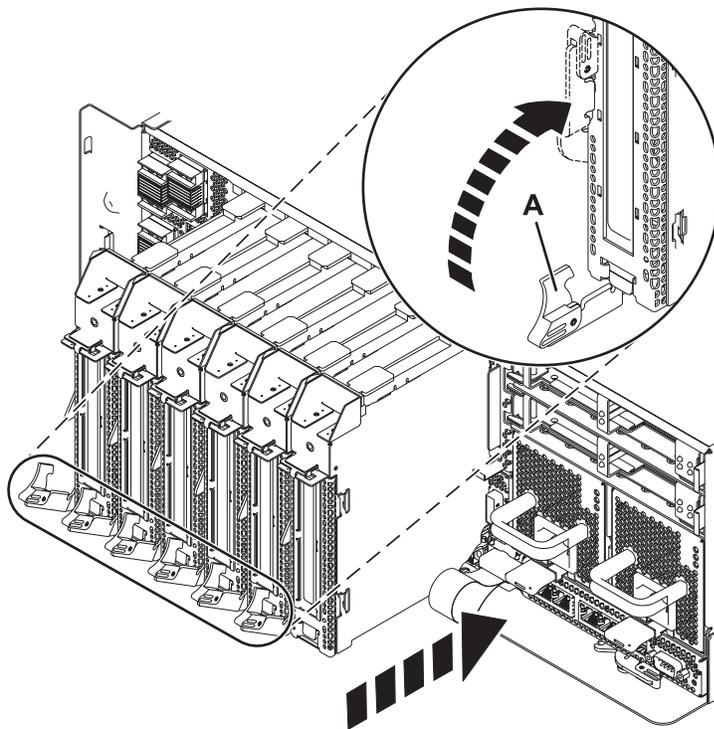
Figura 12. Cassete do adaptador PCI instalado na unidade de sistema
