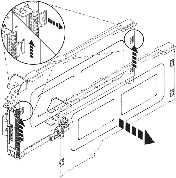
Figura 24. Tampa do cassete do adaptador PCI removida
