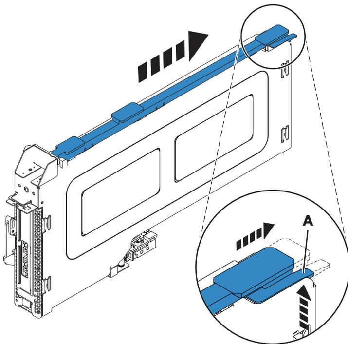
Figura 18. Trilho da guia do cassete do adaptador PCI removido
