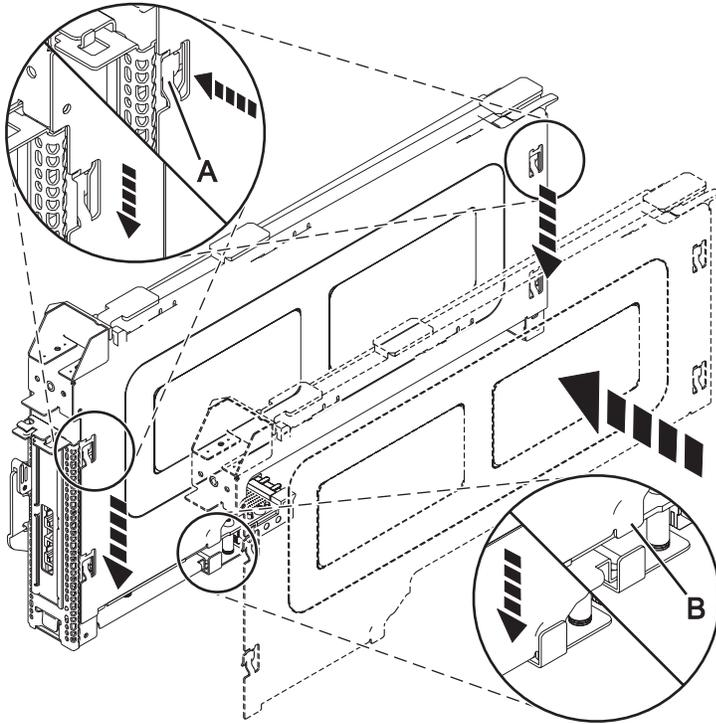
Figura 26. Tapa do cassete do adaptador PCI substituída
