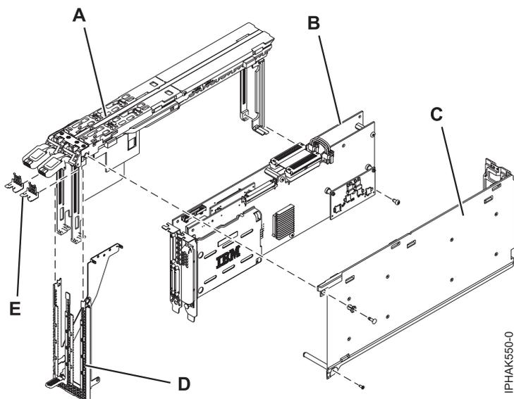
Figura 65. Controlador PCI-X, Ultra320 SCSI RAID, duplicado, de canal quádruplo e as peças principais que formam o conjunto do cassete.
