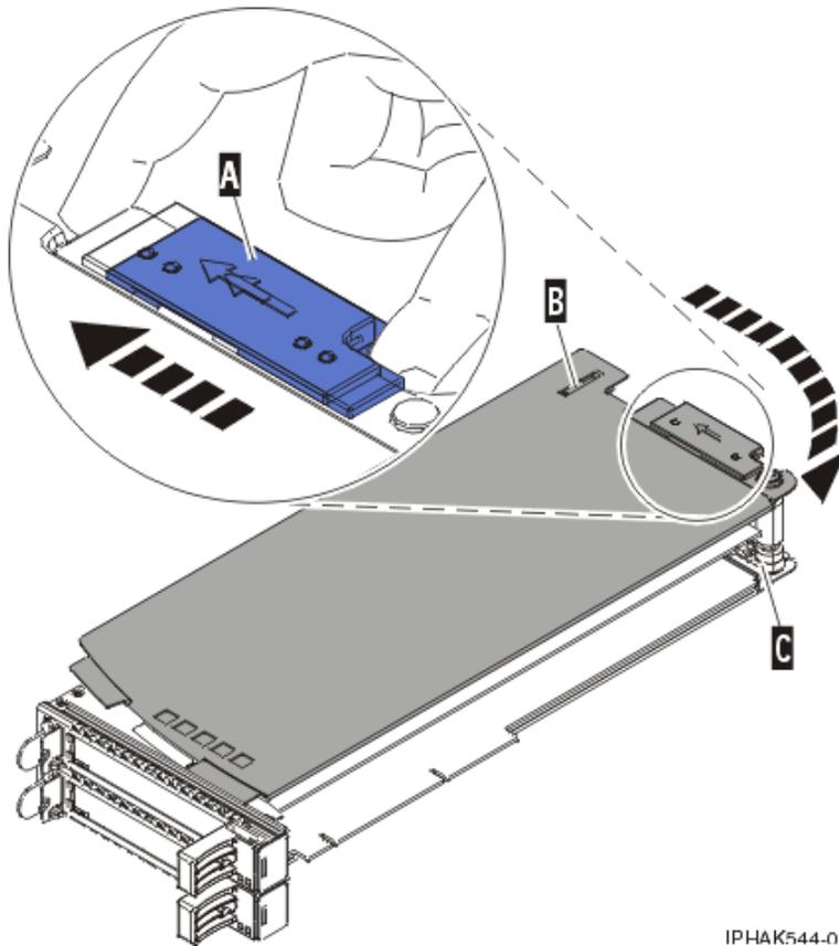
Figura 127. Tampa do cassete do adaptador PCI removida
