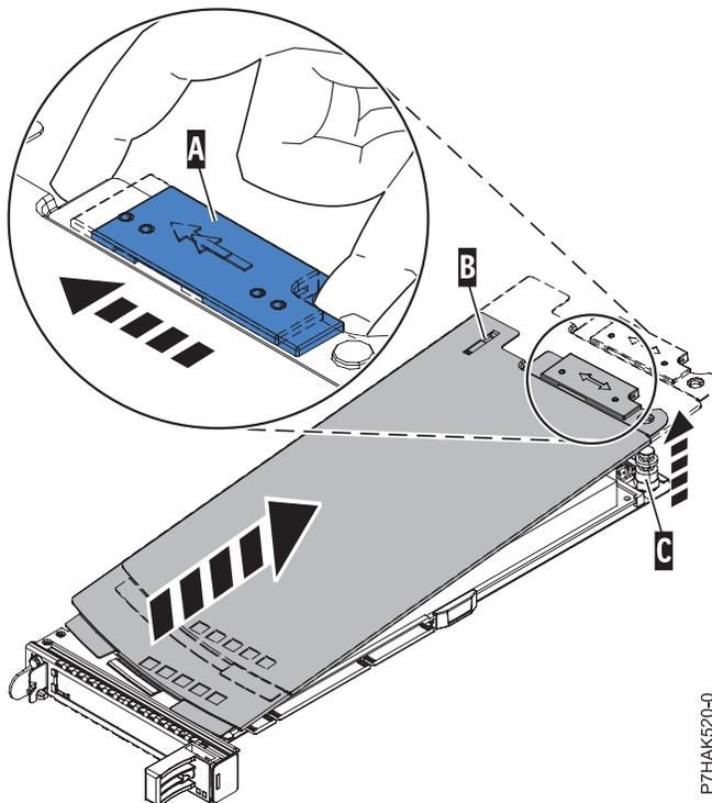
Figura 138. Tampa do cassete do adaptador PCI removida
