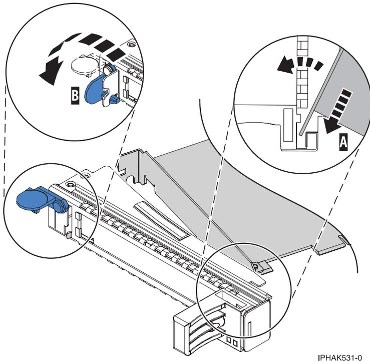
Figura 120. Colocando o cassete de largura única do adaptador PCI
