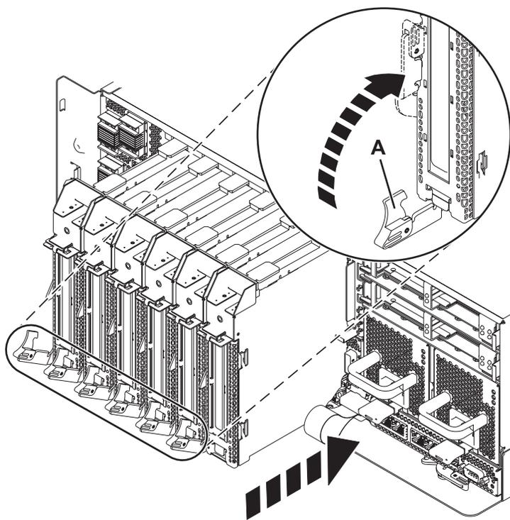
Figura 13. Cassete do adaptador PCI instalado na unidade de sistema
