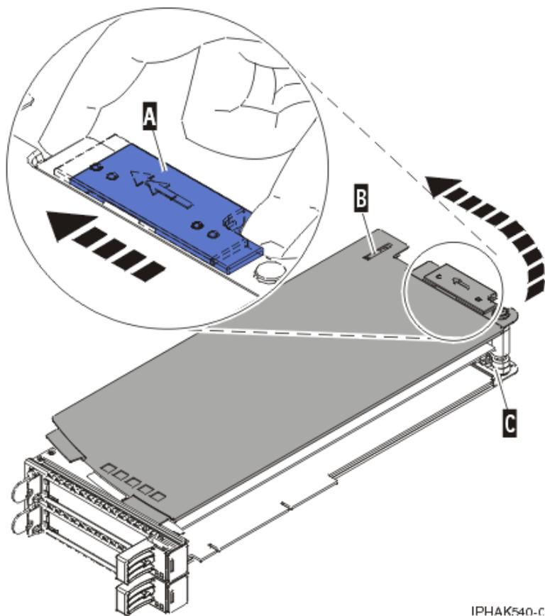
Figura 158. Tapa do cassete do adaptador PCI substituída
