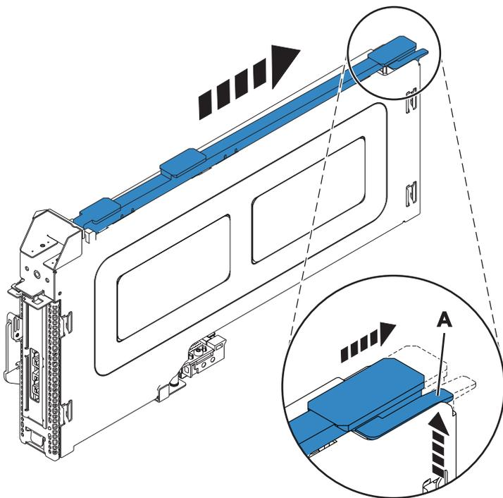
Figura 23. Trilho da guia do cassete do adaptador PCI removido
