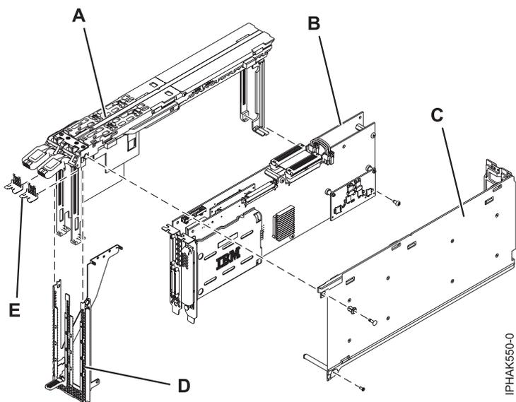
Figura 51. Controlador PCI-X, Ultra320 SCSI RAID, duplicado, de canal quádruplo e as partes principais que formam o conjunto do cassete
