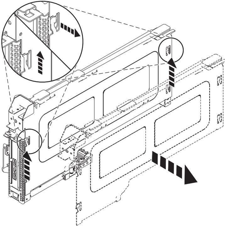
Figura 19. Tampa do cassete do adaptador PCI removida
