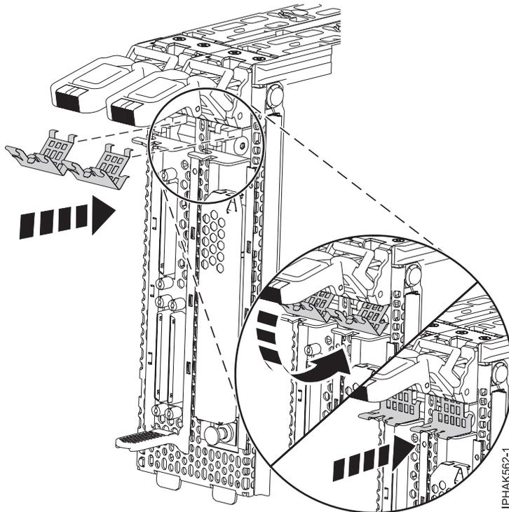
Figura 63. Inserindo dos dois cliques metálicos na parte frontal do conjunto
