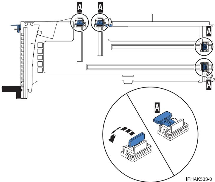
Figura 112. Retentores do adaptador
