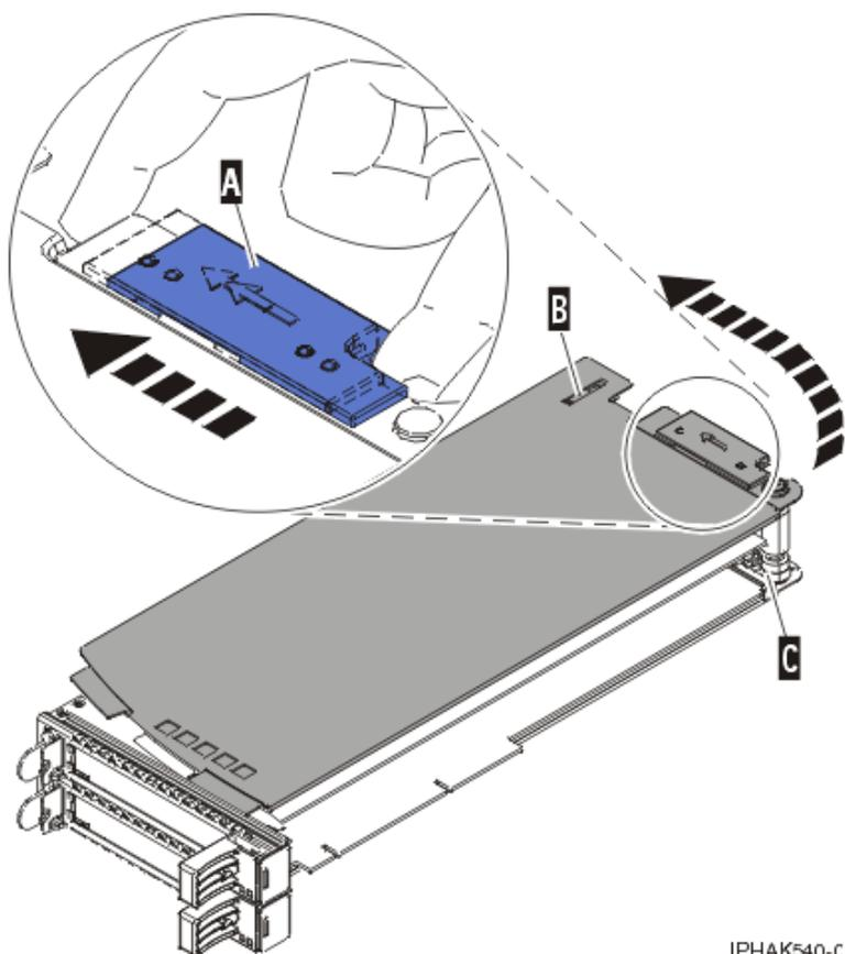
Figura 152. Tampa do cassete do adaptador PCI substituída
