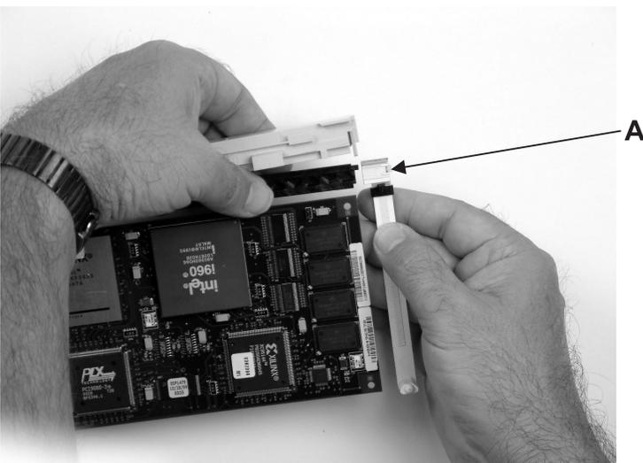
Cada braço adaptador tem uma guia de liberação A que permite que o braço seja movido para fora do adaptador no conjunto do cassete. Use sua unha para erguer a guia, que permite que o braço seja movido para fora do adaptador. Levante a guia de liberação no braço adaptador grande, e deslize-a para fora do conjunto de ligação do cassete.
