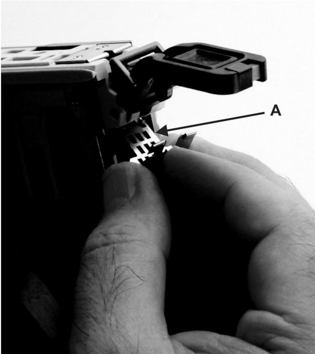
Remova a blindagem EMC metálica A da parte superior do suporte sobre trilhos.
