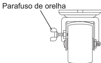
Figura 47. Parafuso do suporte inclinado
