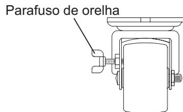
Figura 17. Parafuso do suporte inclinado
