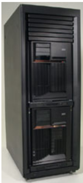
Figura 14. Unidades de sistema de rack 9406-270 de modelo 0551
