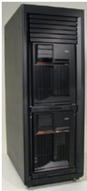
Figura 19. Unidades de sistema de rack 9406-270 de modelo 0551
