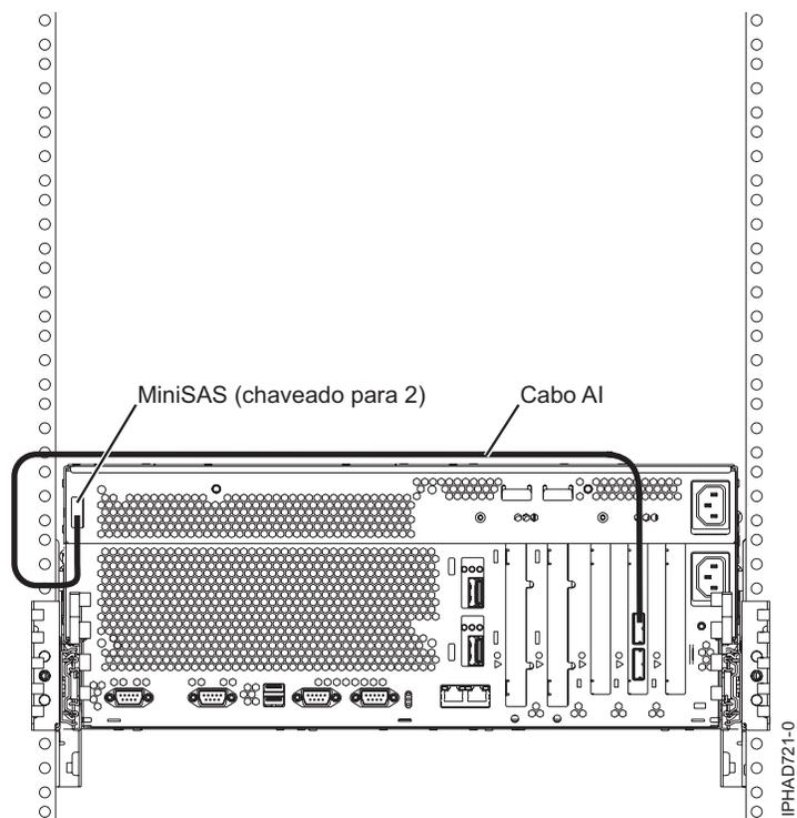
Figura 147. Adaptador SAS em slots de disco SAS interno através da porta SAS externa do sistema
