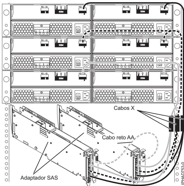
Ao conectar apenas as unidades de disco rígido, também será possível colocar em cascata uma segunda gaveta de expansão de disco para fora de duas das três gavetas para um máximo de cinco gavetas de expansão de disco por adaptador. Consulte Figura 142 na página 135.
