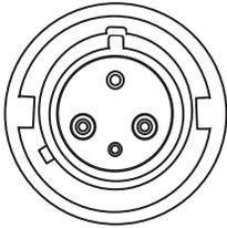
Figura 35. Tipo de receptáculo IEC 60309 3P+N+E
