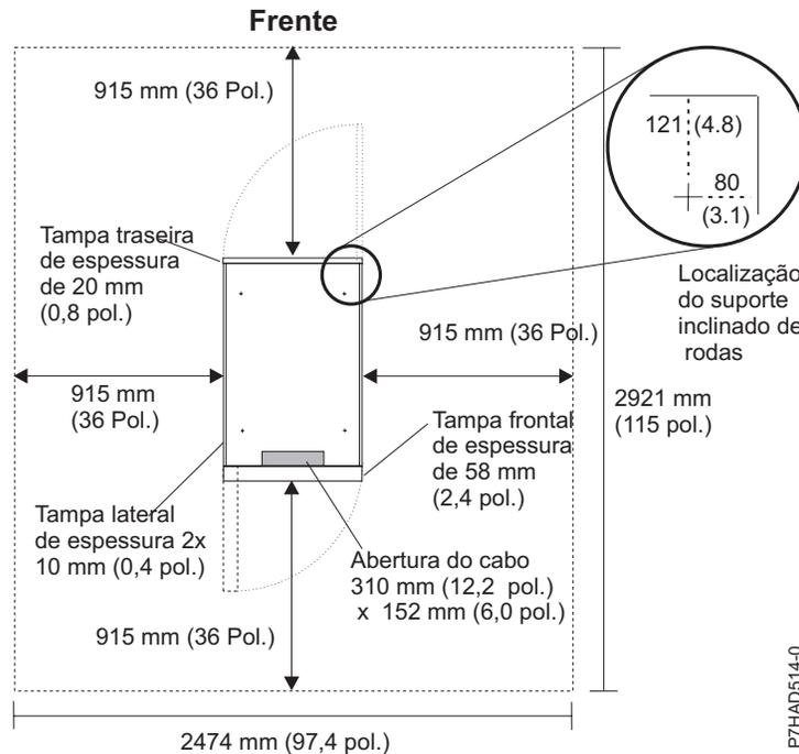
Figura 22. Liberações de serviço e locais do suporte inclinado para 7014-T00, 7014-T42, e racks 0553
