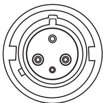
Figura 33. Tipo de receptáculo IEC 60309 P+N+E
