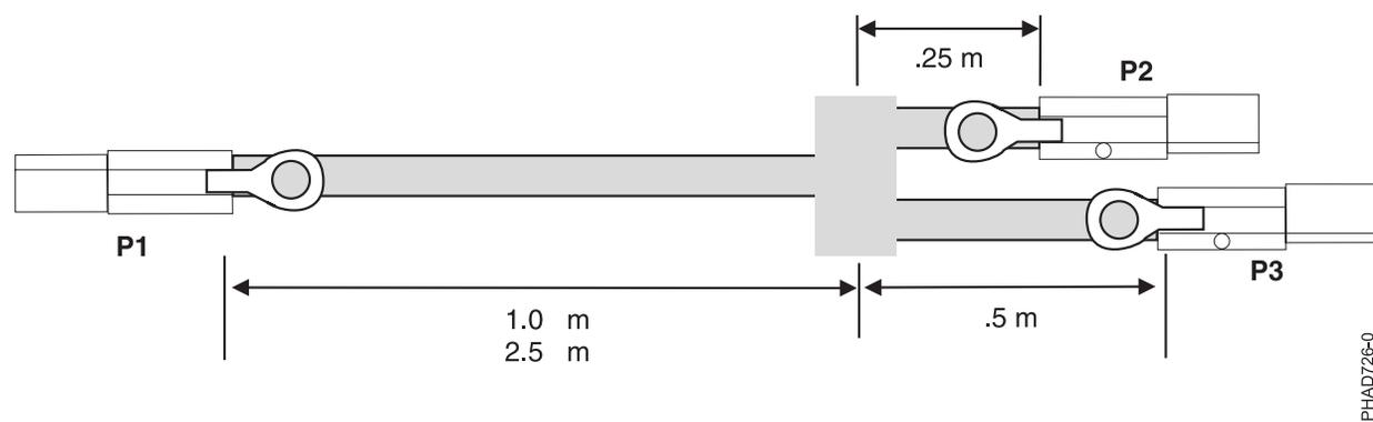
Figura 139. Comprimentos de cabo do conjunto de cabos externos SAS YI
