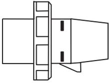
Figura 34. Tipo de plugue IEC 60309 3 P+N+E
