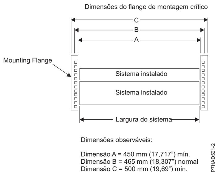
Figura 174. Dimensões do flange de montagem crítica
