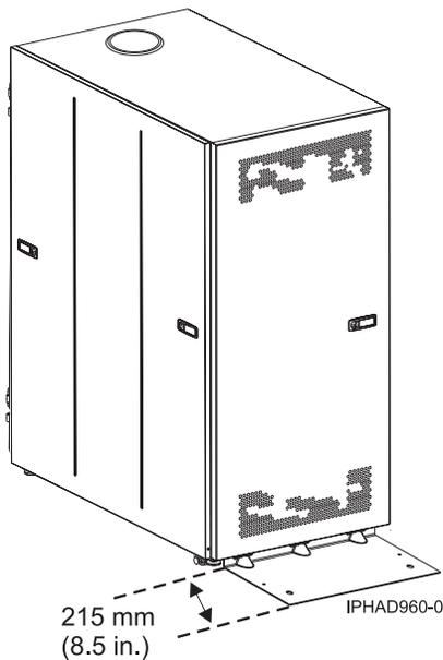
Figura 18. Modelo 0555 e 7014-S25 com pé estabilizador
