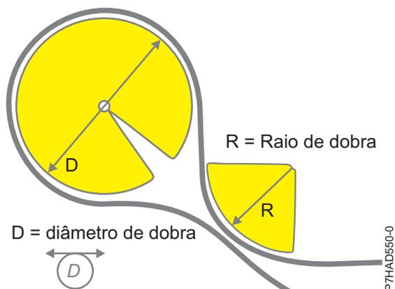
Figura 135. Raio de inclinação do cabo
