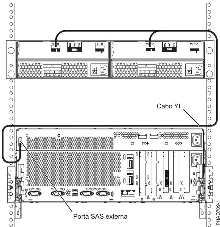
Figura 146. Porta do adaptador SAS do sistema externo em uma gaveta de expansão de disco
