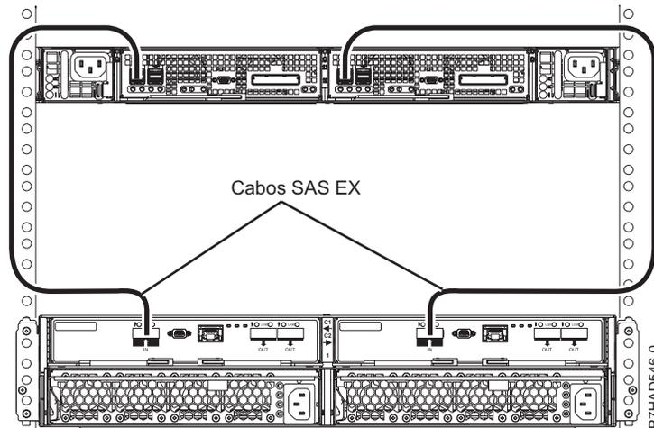
Figura 172. Conexão de uma gaveta do 5887 usando cabos HD EX para um EDR1
