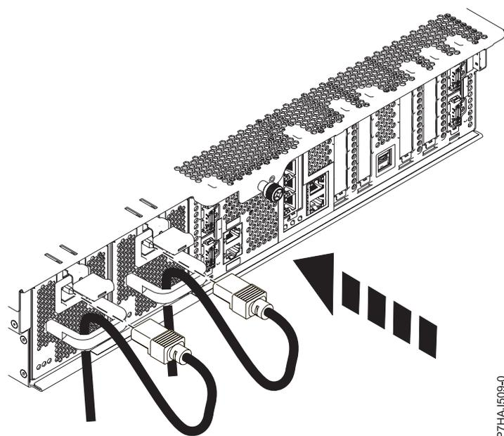
図 19. 電源コードの接続
