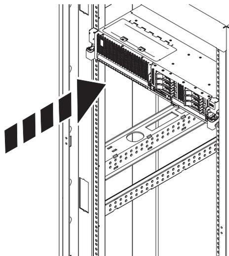
図 17. システムの操作位置への設置
