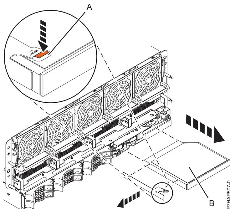
図7. スリムライン・メディア装置の取り外し
