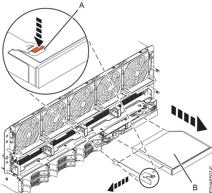
図1. スリムライン・メディア装置の取り外し
