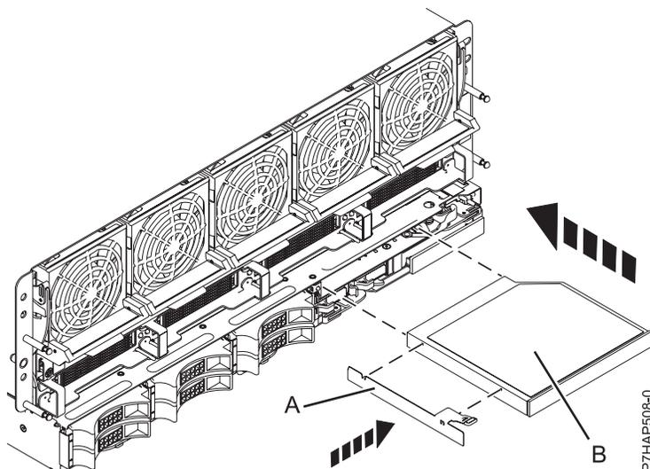
図 8. スリムライン・メディア装置の取り付け
