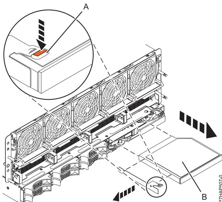
図 11. スリムライン・メディア装置の取り外し
