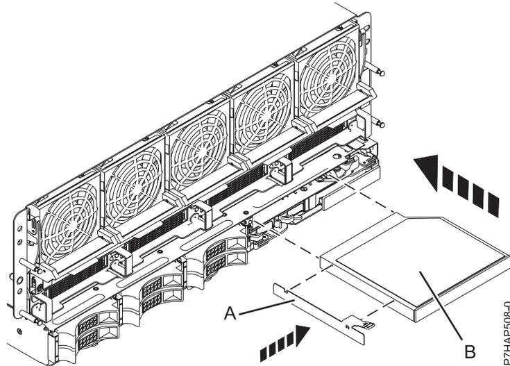
図 13. スリムライン・メディア装置の取り付け
