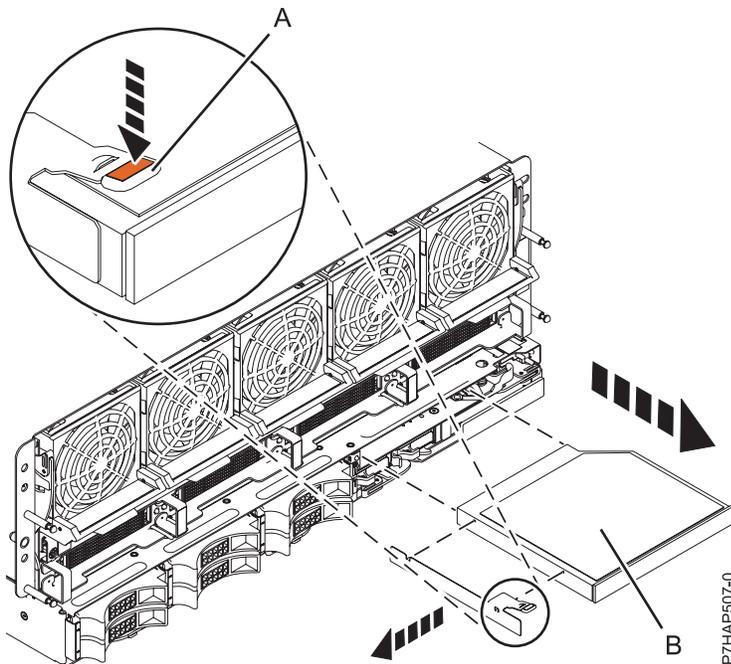
図3. スリムライン・メディア装置の取り外し
