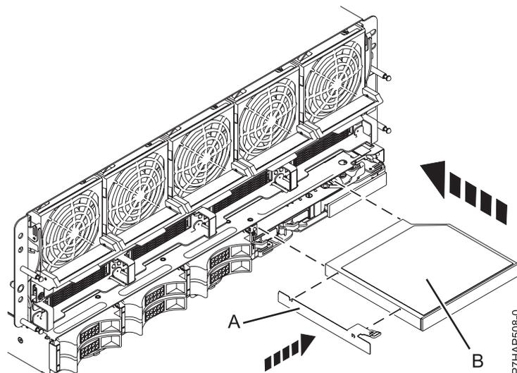
図2. スリムライン・メディア装置の取り付け
