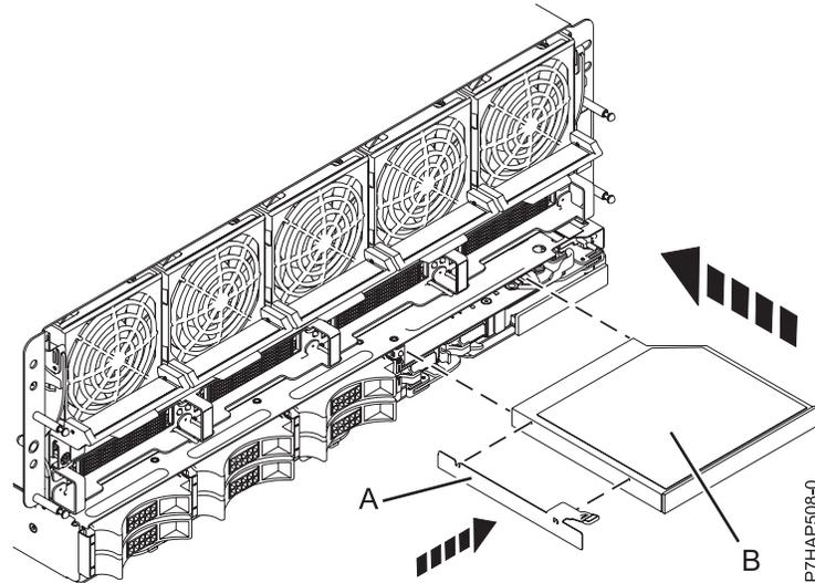
図 10. スリムライン・メディア装置の取り付け
