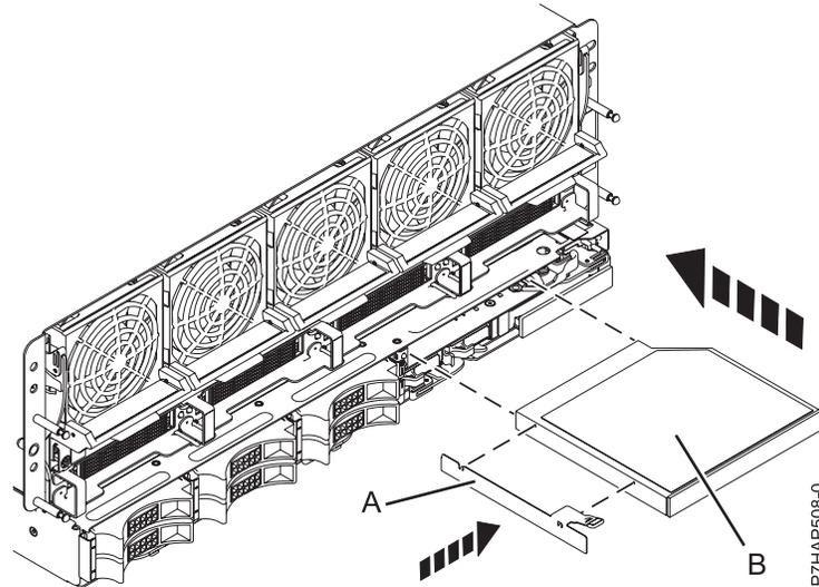
図4. スリムライン・メディア装置の取り付け
