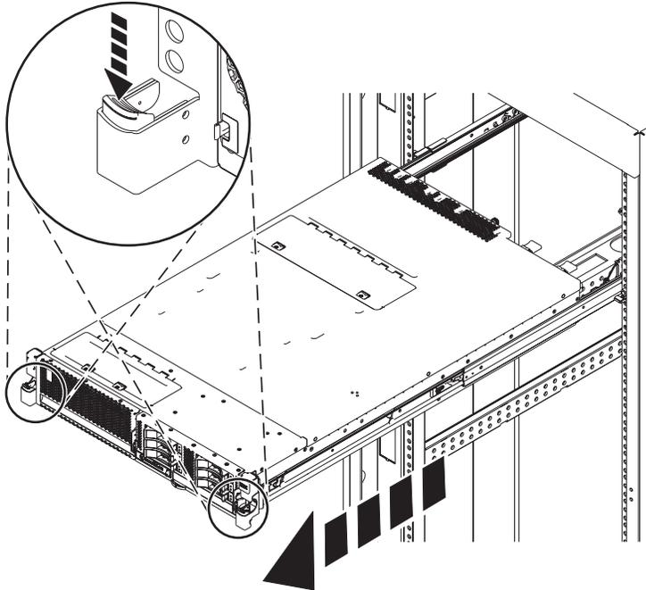
Figure 13. Placement du système en position de maintenance
