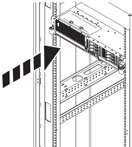
Figure 15. Mise en position de fonctionnement du système
