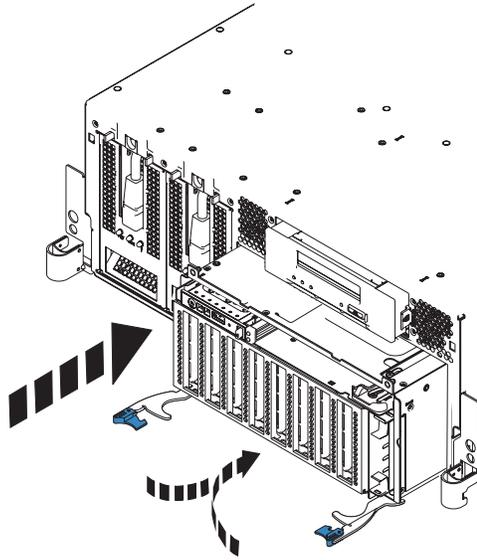
Figure 11. Installation du fond de panier d'unité de disque vide dans un modèle monté en armoire
