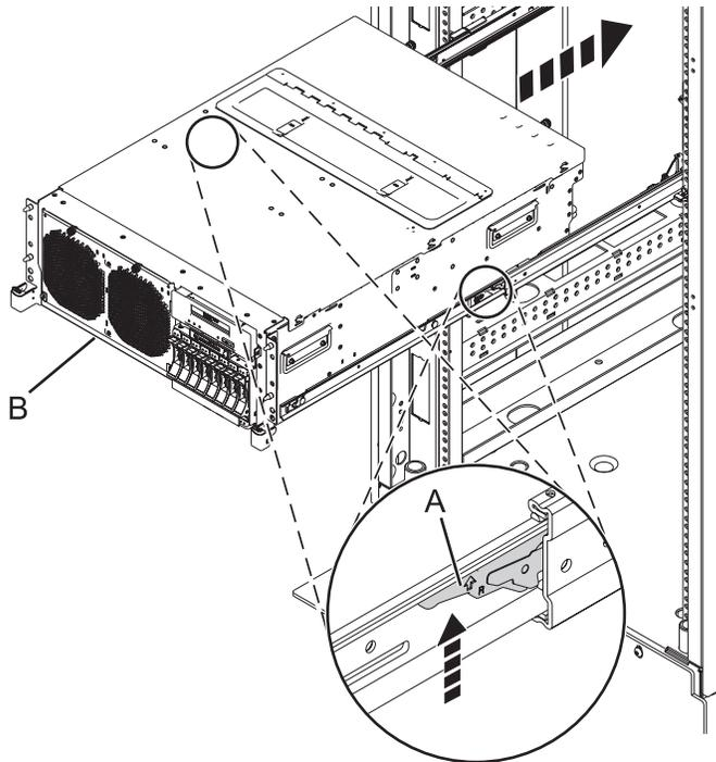
Figure 26. Mise en position de l'unité centrale
