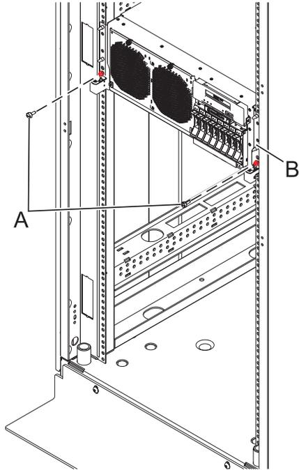
Figure 27. Mise en position de l'unité centrale
