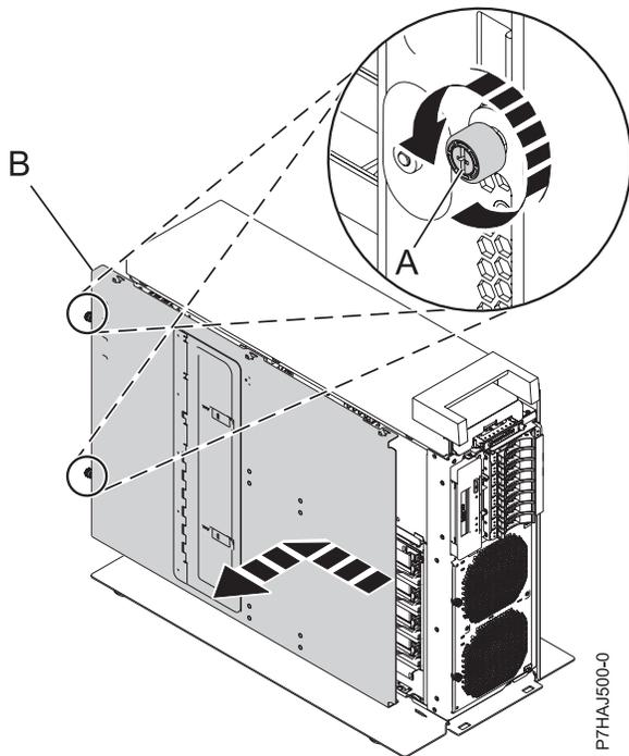
Figure 20. Retrait du capot d'accès intérieur
