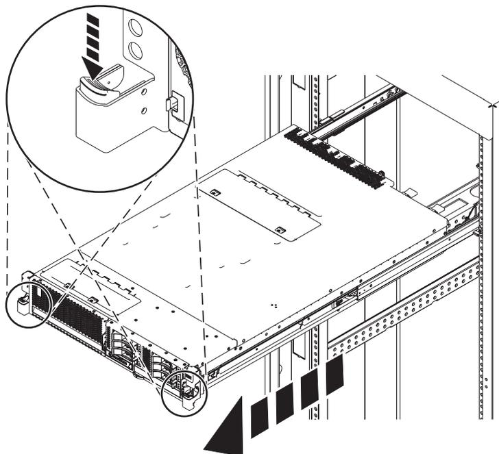
Figure 12. Placement du système en position de maintenance
