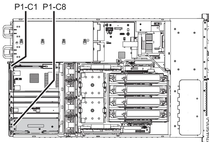
Figure 4. Emplacements de l'adaptateur GX
