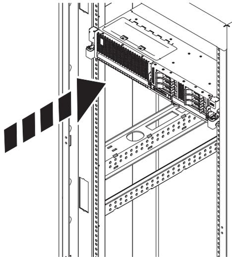
Figure 18. Mise en position de fonctionnement du système
