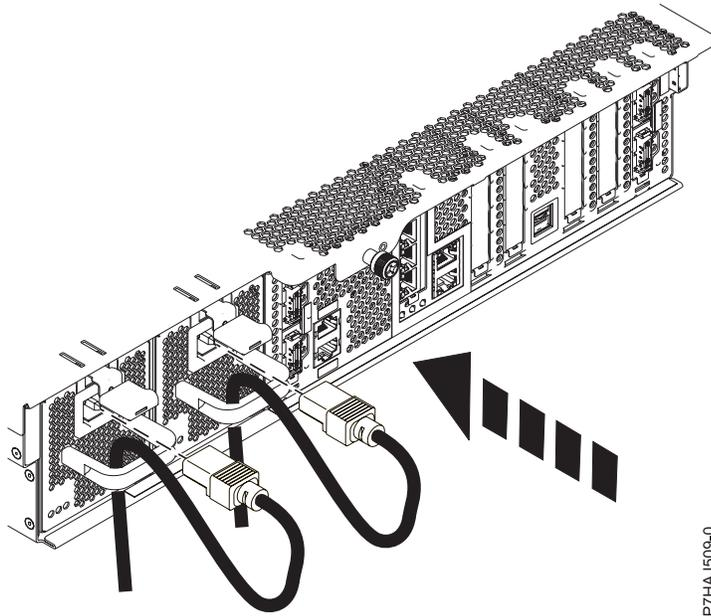
Figure 20. Connexion des cordons d'alimentation
