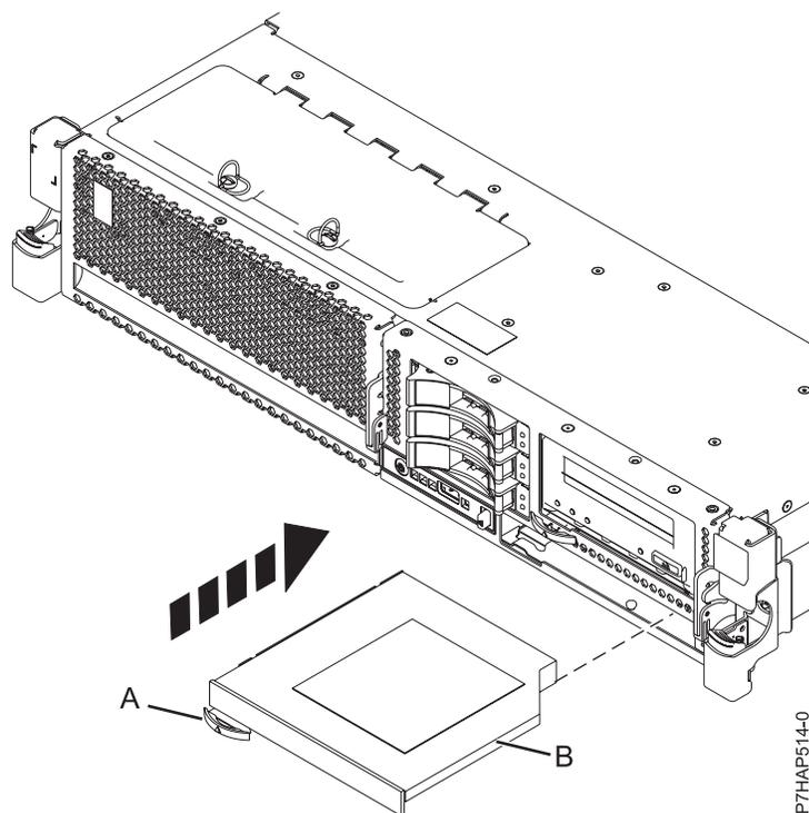
Figure 5. Installation d'une unité de stockage (média) extra-plate
