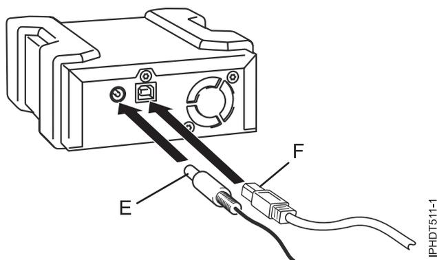
Figure 13. Connexion des câbles USB et d'alimentation
