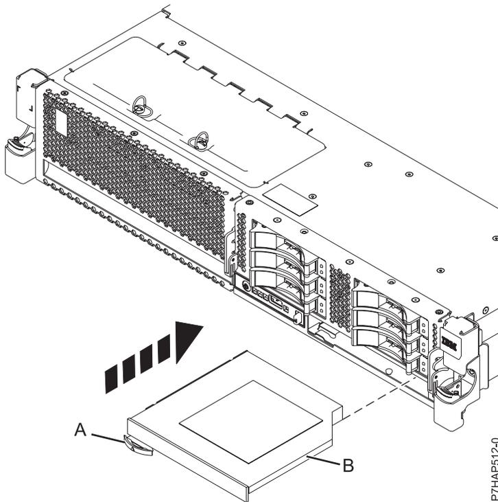
Figure 8. Installation d'une unité de stockage (média) extra-plate
