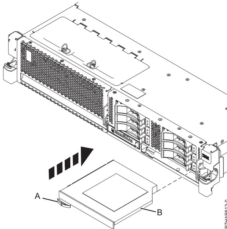
Figure 7. Installation d'une unité de stockage (média) extra-plate
