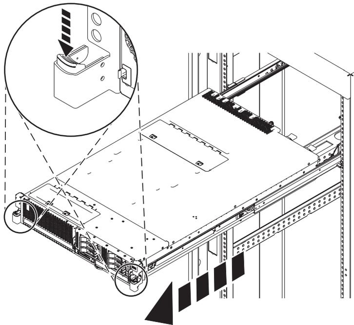
Figure 16. Placement du système en position de maintenance
