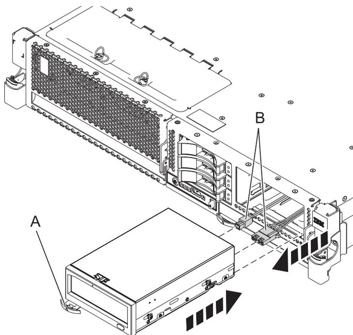
Figure 11. Installation d'une unité de disque USB
